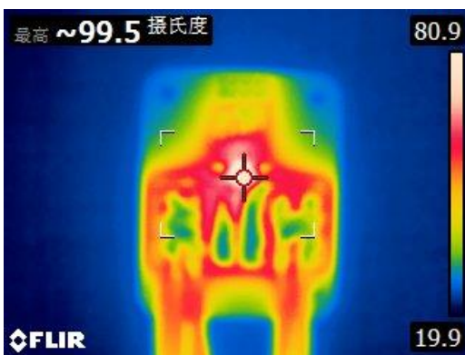
封装体热成像图 (输入电流 40A)
