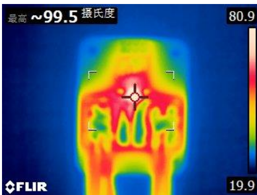
封装体热成像图 (输入电流 40A)
