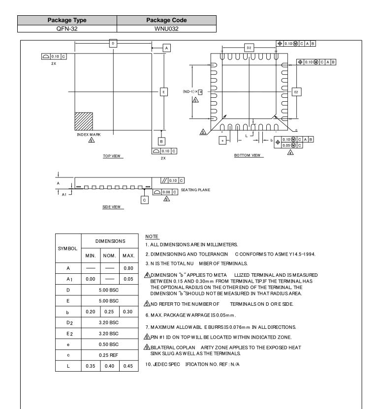
PACKAGE OUTLINE, 32 LEAD QFN 5.00X5.00X0.80 M M WNU032 3.20X8.20 M M EPAD (SAW N) REV\*
