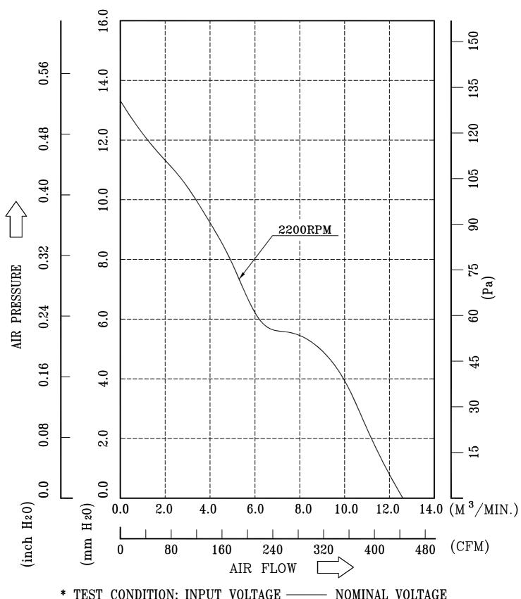
\* TEST CONDITION: INPUT VOLTAGE — NOMINAL VOLTAGE TEMPERATURE — ROOM TEMPERATURE HUMIDITY — 65%RH
