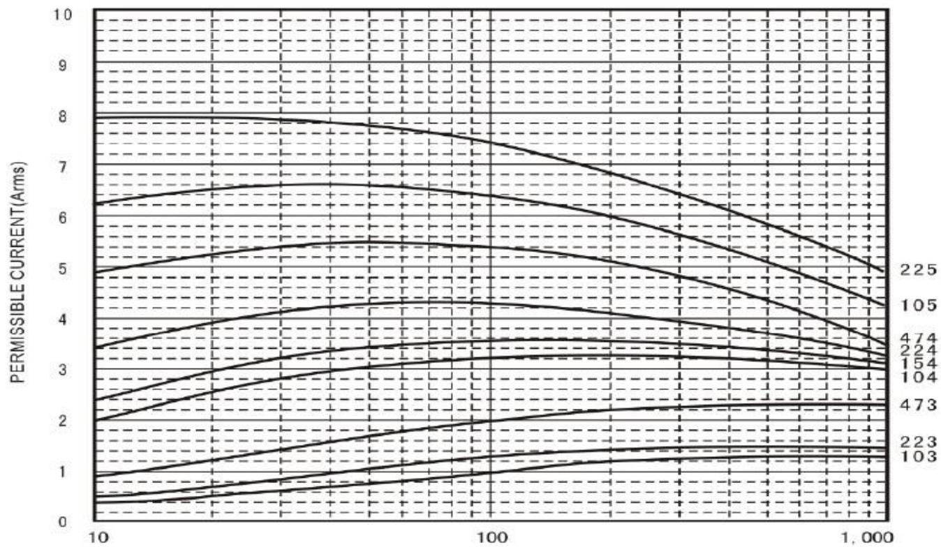
允许电流 ( Arms ) 对频率特性曲线图 ( 正弦波,  $\Delta T \leq 12^\circ C$ )
