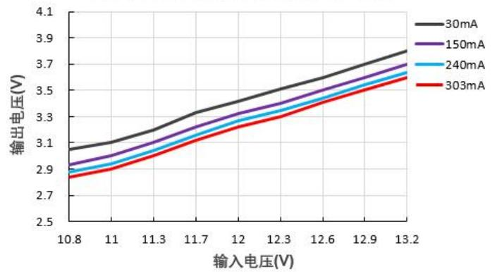
输出电压Vs输入电压@B1205LS-1WR2
