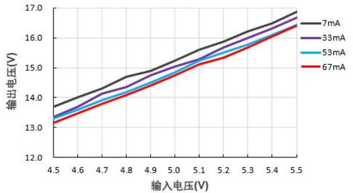
输出电压Vs输入电压@B0524LS-1WR2
