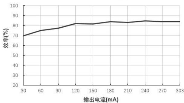
效率Vs输出电流(Vin=24V)@B2405LS-1WR2
