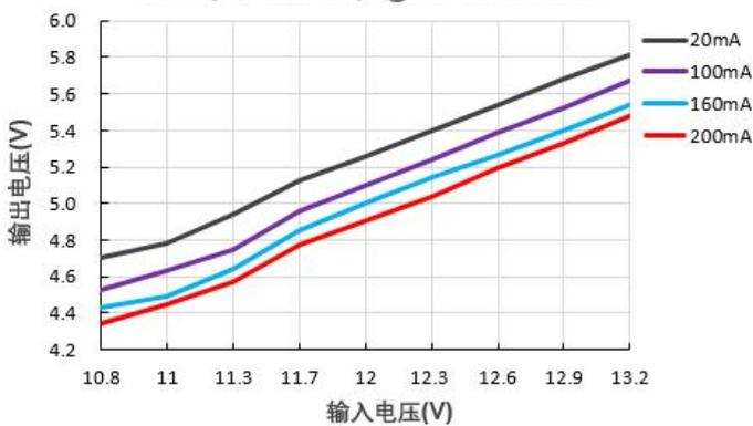
输出电压Vs输入电压@B1212LS-1WR2
