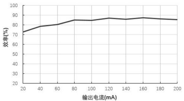
效率Vs输出电流(Vin=24V)@B2412LS-1WR2
