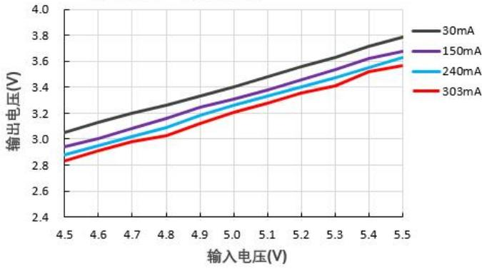
输出电压Vs输入电压@B0505LS-1WR2
