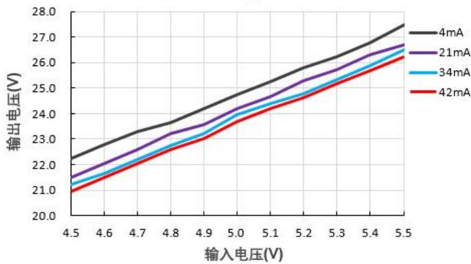
输出电压Vs输入电压@B1203LS-1WR2
