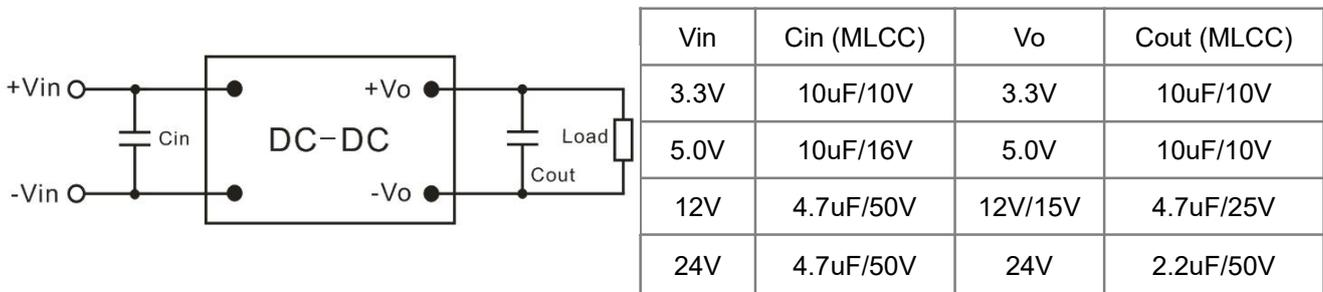
注：在应用电路中，输入、输出的滤波电容尽可能靠近产品引脚处；可在输入端增加使用 33uF/35V 高频低阻的电解电容吸收来自供电端的浪涌电压尖峰。
