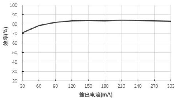
效率Vs输出电流(Vin=5V)@B0505LS-1WR2
