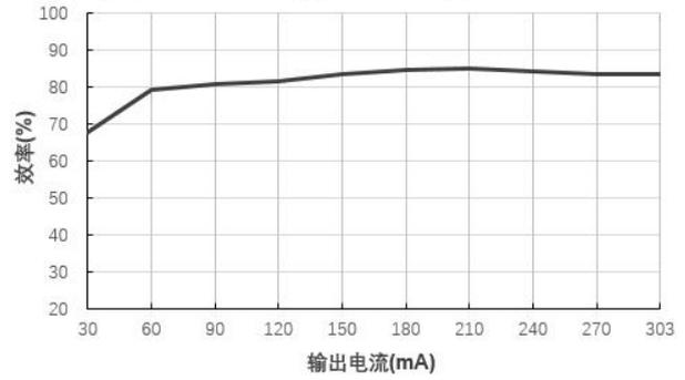
效率Vs输出电流(Vin=12V)@B1205LS-1WR2
