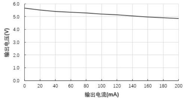
输出电压Vs输出电流(Vin=5V)@B0503LS-1WR2
