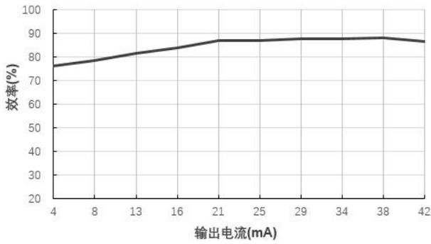
效率Vs输出电流(Vin=12V)@B1203LS-1WR2
