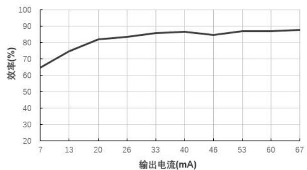
效率Vs输出电流(Vin=5V)@B0524LS-1WR2
