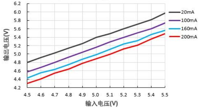
输出电压Vs输入电压@B0512LS-1WR2
