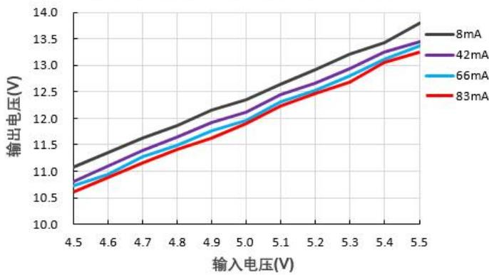
输出电压Vs输入电压@B0515LS-1WR2
