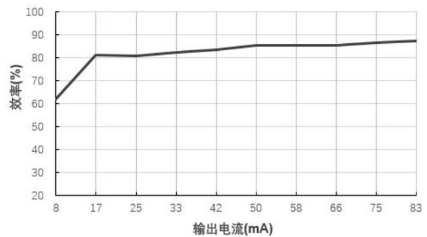
效率Vs输出电流(Vin=12V)@B1215LS-1WR2
