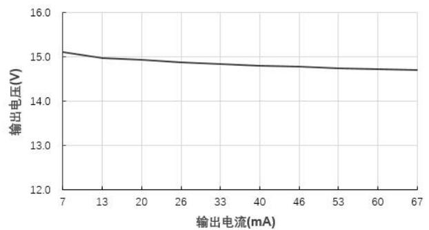
输出电压Vs输出电流(Vin=24V)@B2424LS-1WR2
