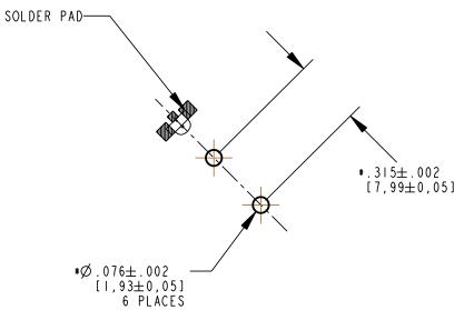
RECOMMENDED HOLE PATTERN LAYOUT FOR I POSITION STRAIGHT LIGHTPIPE 515-1154F
