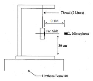
0.1 METER FROM MICROPHONE TO FAN INTAKE
