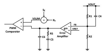
Figure 27. Type II Compensator
