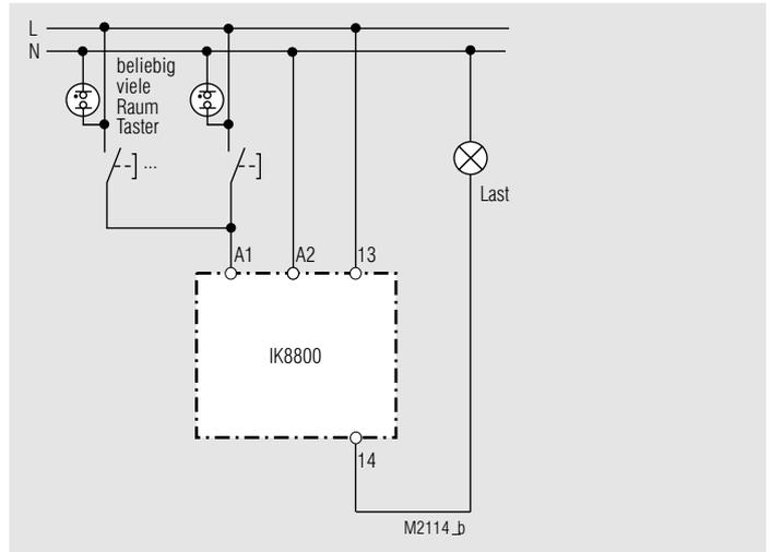
Diese Schaltung erlaubt den Anschluß beliebig vieler beleuchteter Tasten an einem Fernschalter.
