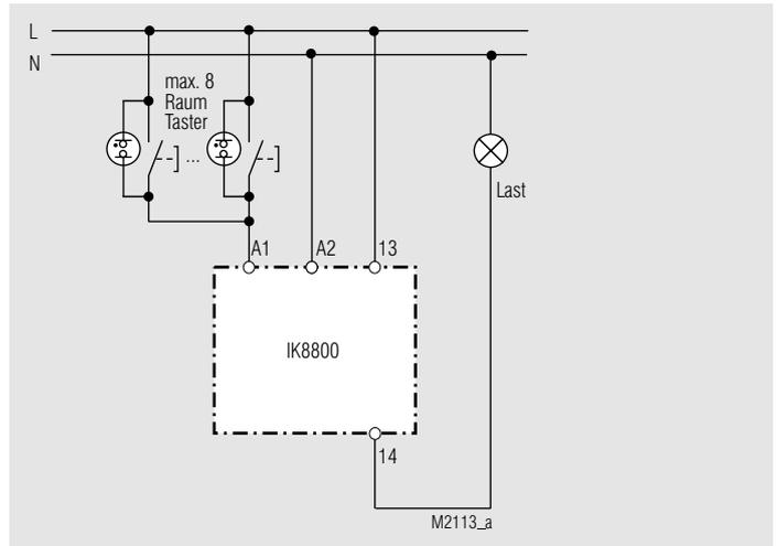
Diese Schaltung kann bei bis zu 8 beleuchteten Tastern angewandt werden.
