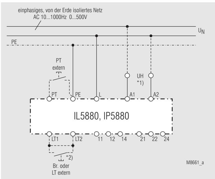
Überwachung eines einphasigen ungeerdeten Netzes.
