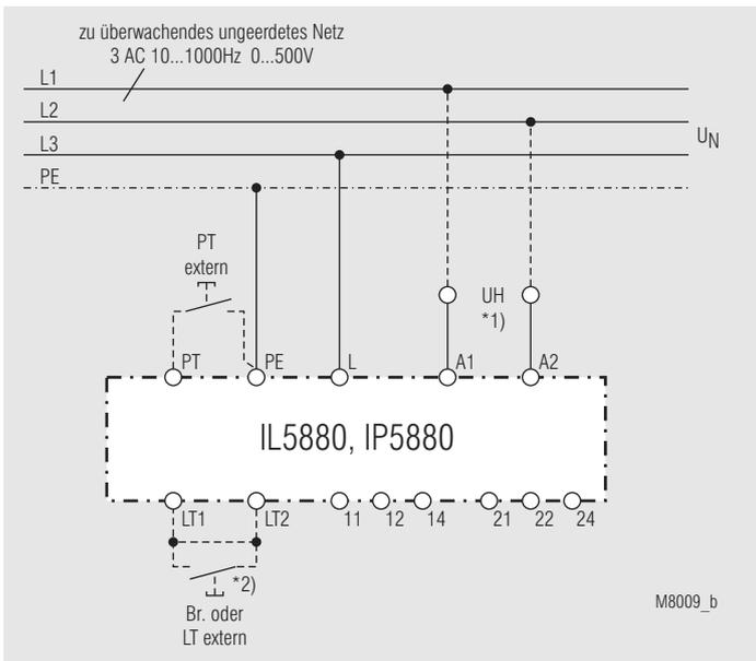
Überwachung eines ungeerdeten Netzes.
