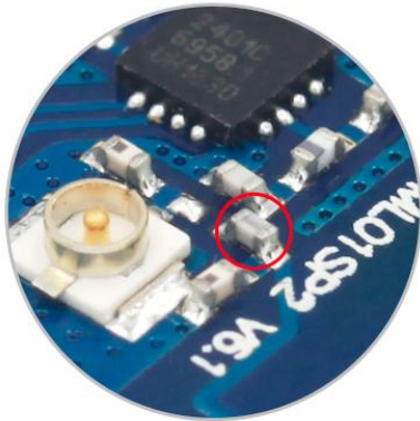
模块默认使用PCB板载天线， 如图所示：贴片电容焊到靠丝印附近处。
