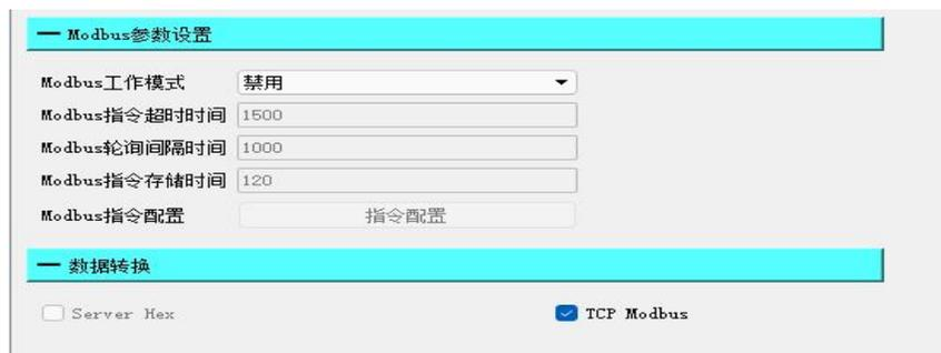
**Modbus 工作模式** 分别可以设置 简单协议转化/多主机/存储型/配置型/主动上传型 五种类型 默认为禁用，即为不开启 modbus 功能区，将选项改为任意一种类型，即为开启，注意：开启后，modbus 网关将工作在链路一上，只支持 TCP 形式交互，并且会主动关闭其他三路链路，请不要使用其他三条链路。下面简单介绍一下几种网关模式：
