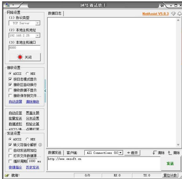
4、模块连接到 TCP Server：AT+CIPSTART=192.168.2.25,8080，返回：+CIPSTART:1 OK。
