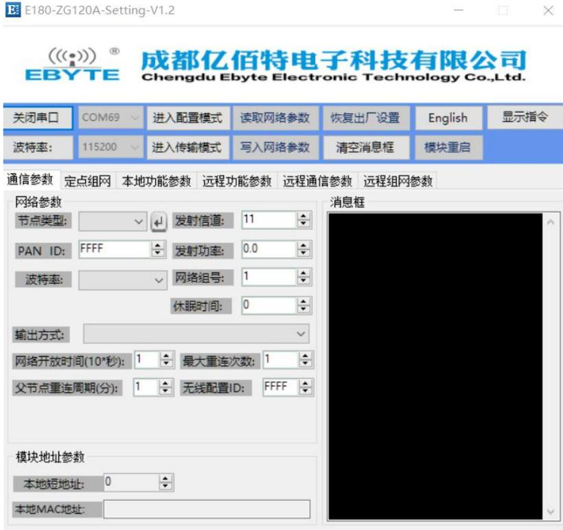
(2) 串口打开后，首先点击“进入配置模式”，消息框提示“进入配置状态成功，读取参数成功”，主要的网络参数包括，节点类型默认为终端，信道默认 11，PAN ID 默认随机，发射功率等级默认为 0(7dbm)。
