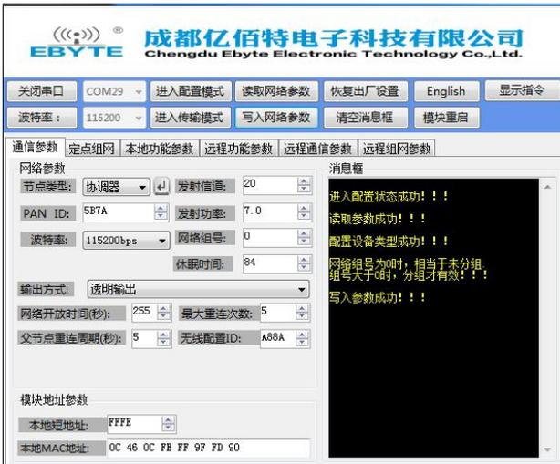
(5) 修改了节点类型，模块需要重启后才能生效，点击“模块重启”，此时消息框提示“模块重启成功”
