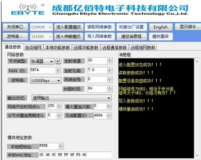
(6) 模块重启后默认进入了传输模式，此时需要再次点击“进入配置模式”，消息框提示“进入配置状态成功，读取参数成功”，可以看出现在读出来的参数是之前修改后的参数，说明网络参数修改成功。
