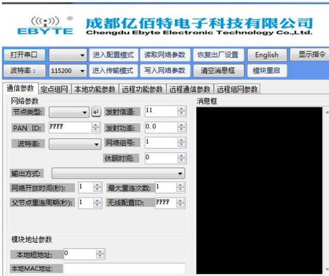
(2) 串口打开后，首先点击“进入配置模式”，消息框提示“进入配置状态成功，读取参数成功”，主要的网络参数包括，节点类型默认为终端，信道默认 11，PAN ID 默认随机，发射功率默认为 10（最大可配置为 20）。
