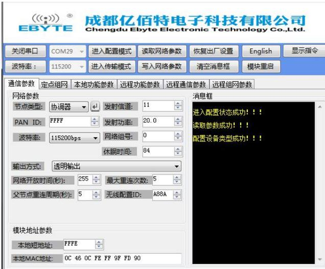
(4) 节点类型写入成功后，修改部分网络参数建立需要的 ZigBee 网络（也可以不用修改参数采用默认值），此处修改一下信道、网络 PANID 和发射功率，参数修改后一定要点击“写入网络参数”，此时消息框会提示“写入参数成功”
