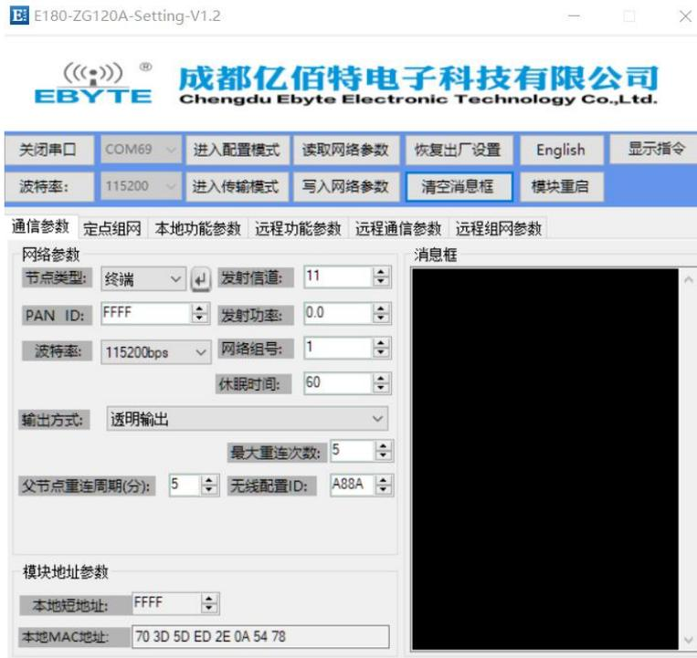
(3) 修改节点类型为休眠终端，点击回车按键，消息框提示“配置设备类型成功”，修改网络参数，其 PAN ID 和发射信道参数必须和待加入的网络一样，点击“写入网络参数”，消息框提示“写入参数成功”
