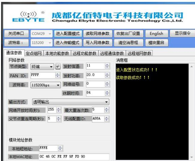
(3) 修改节点类型为协调器，并点击旁边的回车按键，同时消息框提示“配置设备类型成功”。一般的 ZigBee3.0 网络是由协调器节点建立的，所以建立网络前需把出厂默认的终端节点类型更改为协调器。
