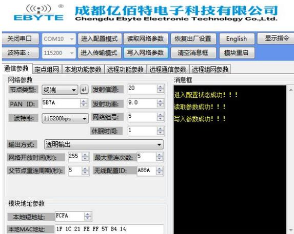
(2) 比如协调器为发送端，点击“进入配置模式”，进入定点组网，选择组播方式，消息框提示“组播模式下，网络中相同组号节点都将受到组播数据”，修改目标组号为“5”，再写入参数，消息框提示“写入参数成功”
