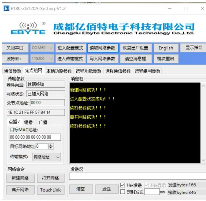
同理，终端节点也按照上述方法加入特定的 ZigBee 网络，若节点类型不变需要加入到另一个 ZigBee 网络时，节点类型配置旁边回车按钮 也需要点击，修改网络参数后写入参数，最后重启加入到新的 ZigBee 网络。
