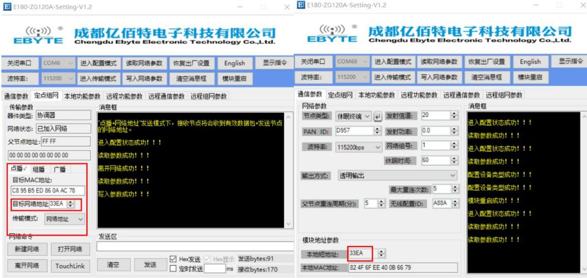
(2) 节点间的目标地址配置好后，点击“进入传输模式”，消息框提示“进入传输模式成功”，在通信之前确认模块是否处于传输模式下，只有在传输模式下才能通信。在发送区输入需要发送的数据，点击发送，终端节点消息框中可以看到接收到的数据
