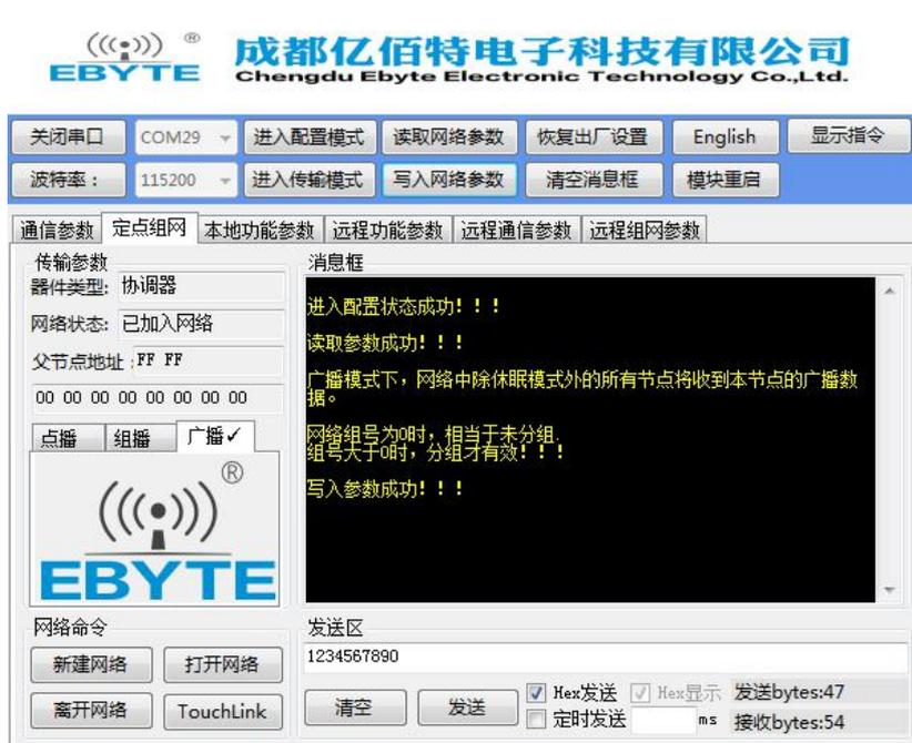
(2) 进入传输模式，消息框提示“进入传输模式成功”，然后进行广播数据通信，此时网络中所有节点将会接收到数据，也包括发送节点。
