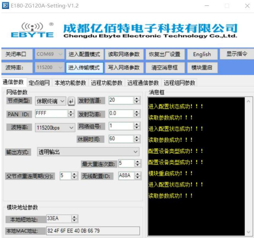
(4) 点击“模块重启”，消息框提示“模块重启成功”，点击“进入配置模式”，消息框提示“进入配置状态成功，读取参数成功”，确认读取的 PAN ID 和发射信道参数是否是之前修改的值（建立网络协调器的 PAN ID）。
