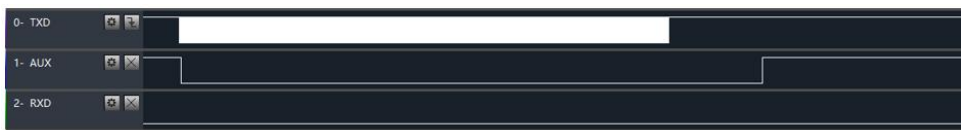
MCU 接收到串口数据到 MCU 启动射频发送时，AUX 时序图
