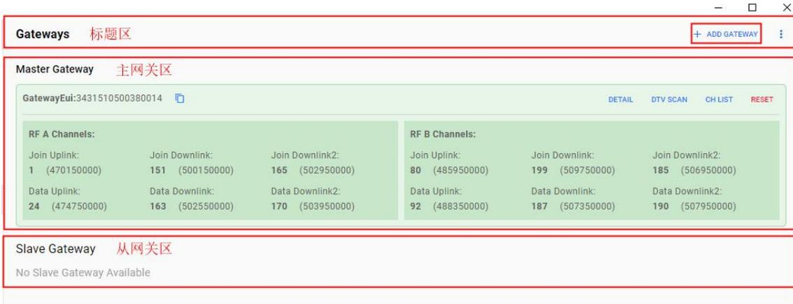
①标题区：标题区主要提供添加从网关、设置轮询心跳值、网关列表刷新、网关导入与导出等功能。
