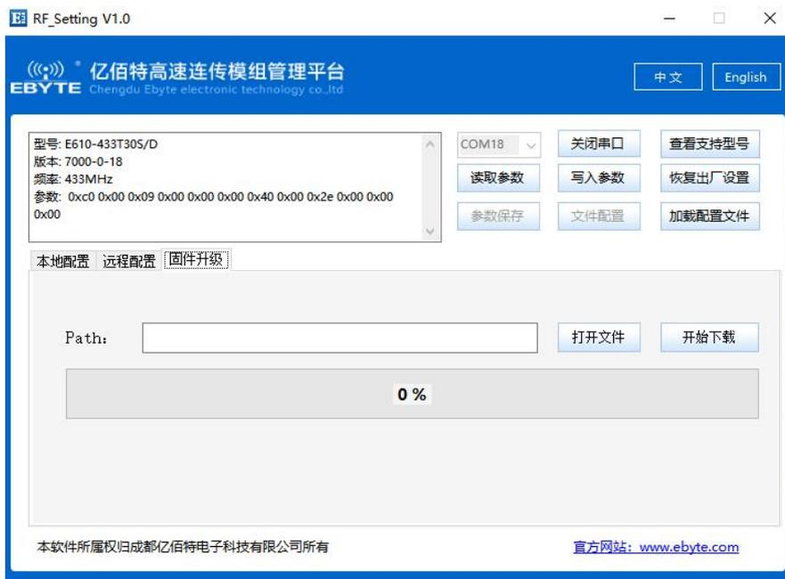
升级方式二：模组先掉电，短接模组 AUX 引脚与 GND 引脚再上电(至少维持短接 1 秒后再松开)，模组会自动进入升级模式，然后使用配置工具下载固件即可。
