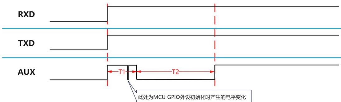
模块上电初始化时，AUX 引脚时序图
