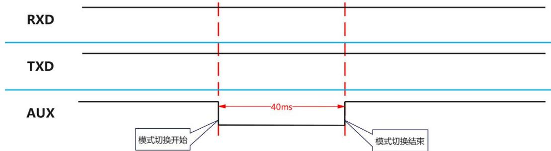
模块切换模式时，AUX 引脚时序图
