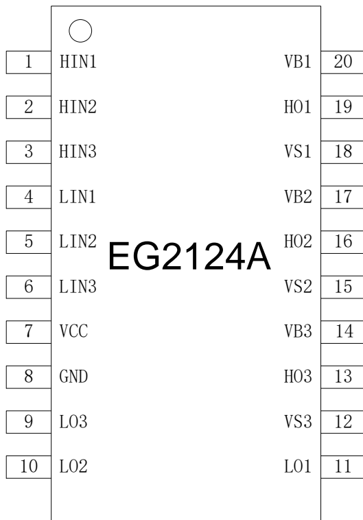
图 4-1. EG2124A 管脚定义
