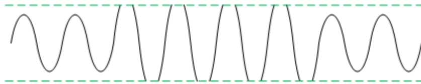
图 5-2. NCN_OFF 模式下的音频输出信号
