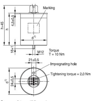
Creepage distance 12.7 mm min. Clearance 9.6 mm min.
