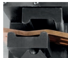
Odsadzanie SH 406PLC.
