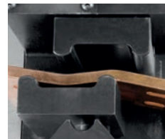
Odsadzanie SH 406PLC.
