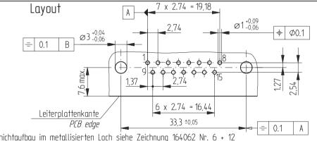
Schichtaufbau im metallisierten Loch siehe Zeichnung 164062 Nr. 6 + 12 Metal plating of plated-through hole see drawing 164062 No. 6 + 12
