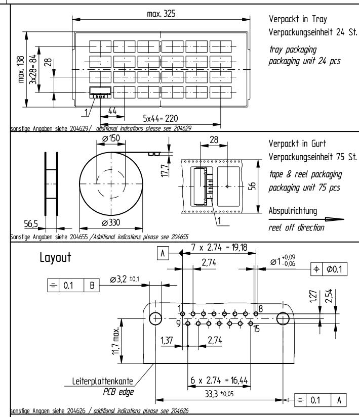
Fehlende Masse und Angaben siehe DIN 41652 / Missing information and dimensions according to DIN 41652
