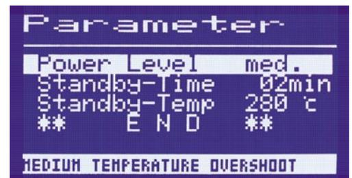
Die *i*-CON ermöglicht sichere Kontrolle, wenn empfindliche Bauteile ein striktes Unterbinden des Temperaturüberschwingens an der Lötspitze erfordern.
