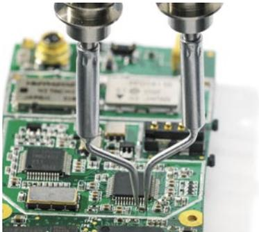
Spezielle Chip Tool-Spitzen zum 0201 Rework.
