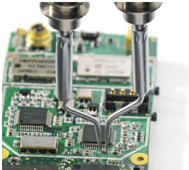
Spezielle Chip Tool-Spitzen zum 0201 Rework.
