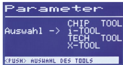
Die Station erkennt die angeschlossenen Werkzeuge automatisch und lädt das jeweilige vordefinierte Programm.
