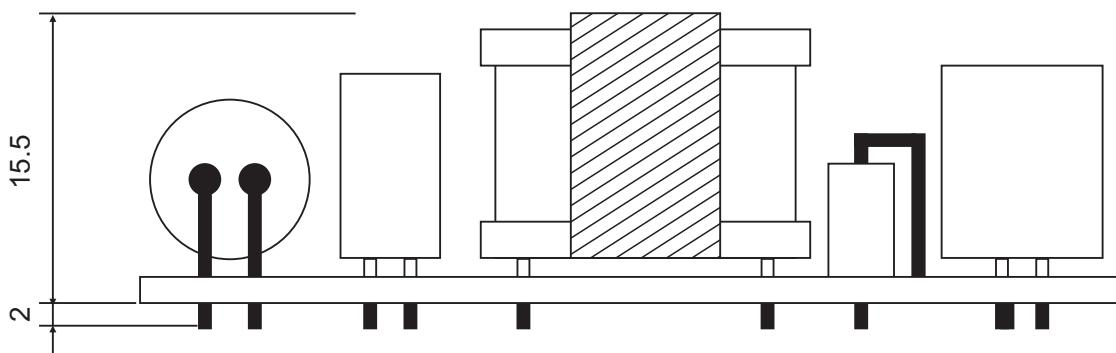
注:此图为PCB导出尺寸,误差为( $\pm 1$ mm)详细尺寸请根据实物为准
