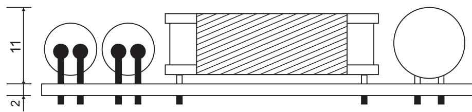
注: 此图为PCB导出尺寸, 误差为(±1mm)详细尺寸请根据实物为准
