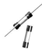
Aufbau: Glasrohr, mit Löschmittel Kontaktkappen: Messing, vernickelt Lötbarkeit: gemäß EN 60068-2-20 Verpackungsmöglichkeiten: 100 St. = 10 x 10er Faltschachteln 1000 St. = Industrieverpackung (lose geschüttet in Faltkarton) Als Baugruppe mit 2 Aufsteckkappen in beliebiger Form und Länge, fertig montiert
