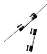
Aufbau: Keramikrohr, mit Löschmittel Kontaktkappen: Messing, vernickelt Lötbarkeit: gemäß EN 60068-2-20 Verpackungsmöglichkeiten: 100 St. = 10 x 10er Faltschachteln 1000 St. = Industrieverpackung (lose geschüttet in Faltkarton) Als Baugruppe mit 2 Aufsteckkappen in beliebiger Form und Länge, fertig montiert Construction:
