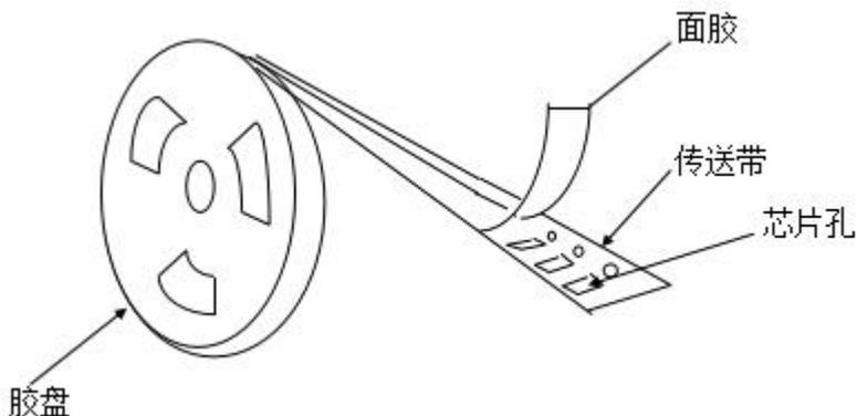
※ 塑胶带尺寸结构(适合‘AM05~AM20’型产品)
