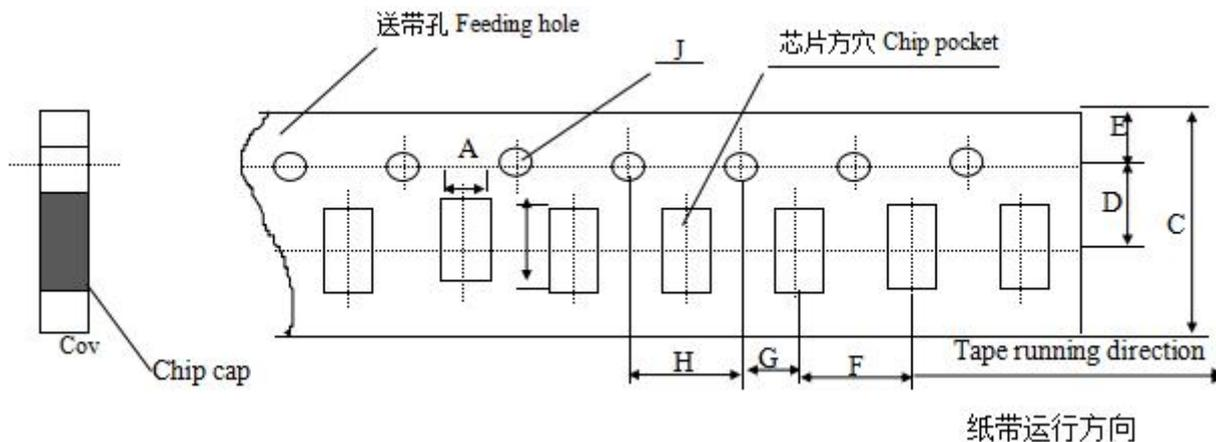
※ 适合 ‘AM03, AM05, AM06’ 常规尺寸产品的纸带尺寸
