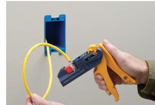
3. Legen Sie den Steckverbinder mit der Vorderseite zuerst und den IDC-Klemmen in Richtung der Klingen in den JackRapid ein.
