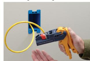
6. Die Adern werden aufgelegt, abgeschnitten und sicher kontaktiert.
