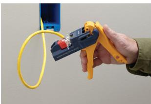
4. Achten Sie darauf, dass der Steckverbinder fest in die Halterung eingelegt ist, und dass die IDC-Klemmen in Richtung der Klingen zeigen.
