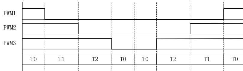
图 14-8 七段式 SVPWM 输出电平
