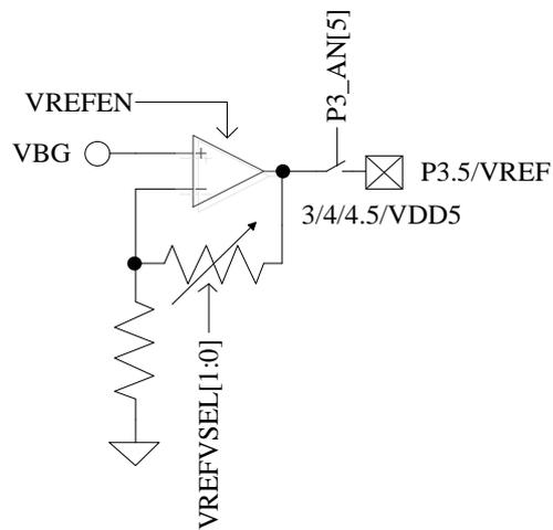
图 27-1 VREF 模块的端口输入输出情况
