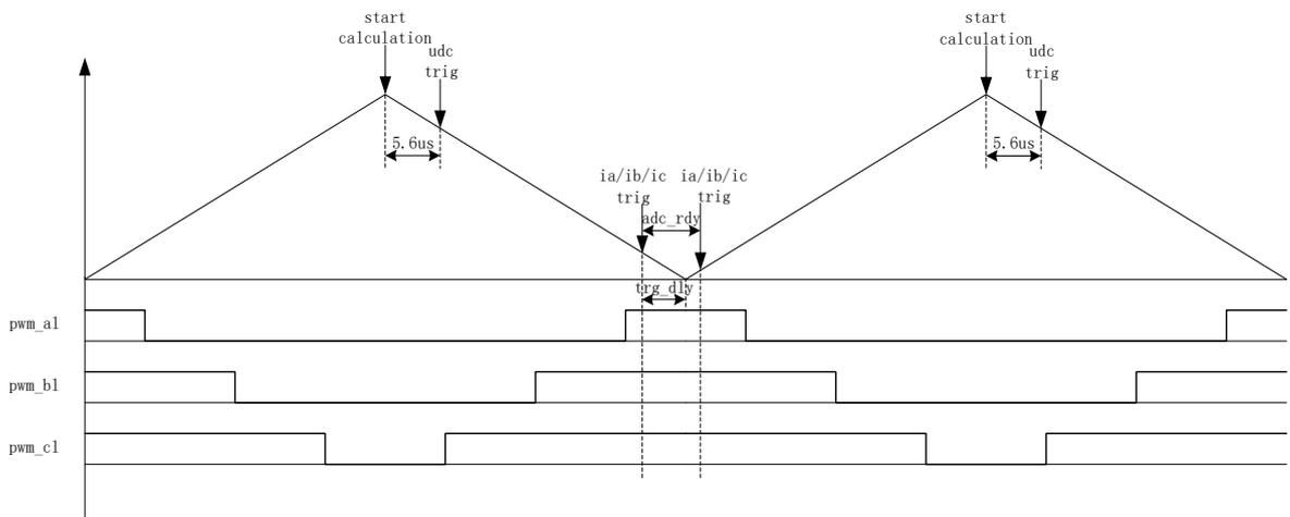
图 14-10 双三电阻电流顺序采样模式
