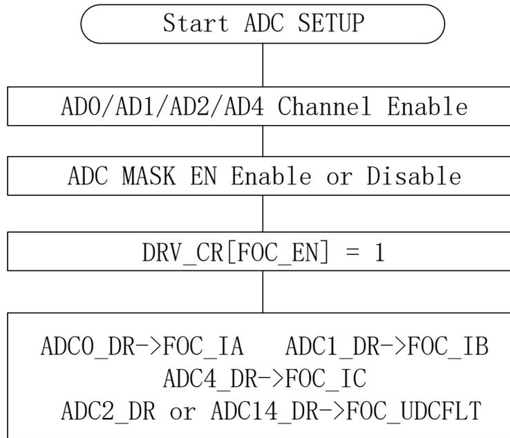
图 24-4 ADC 硬件触发采样流程
