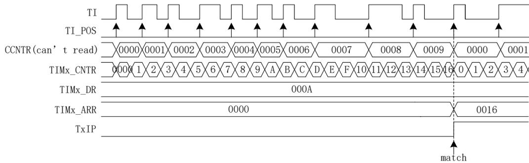
图 17-8 输入 counter 模式时序图
