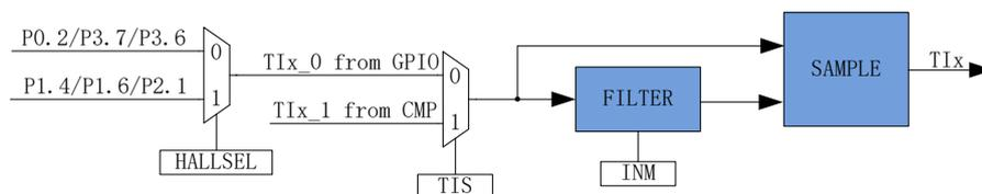
图 16-5 输入信号滤波和采样原理图
