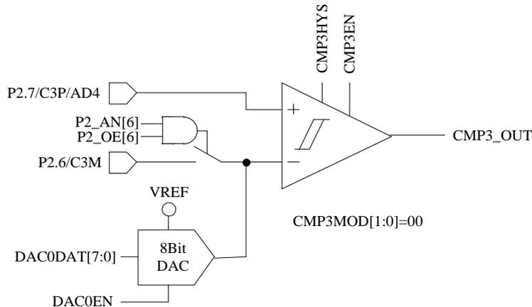
图 30-2 CMP3MOD[1:0]=00B，选择单比较器输入模式
