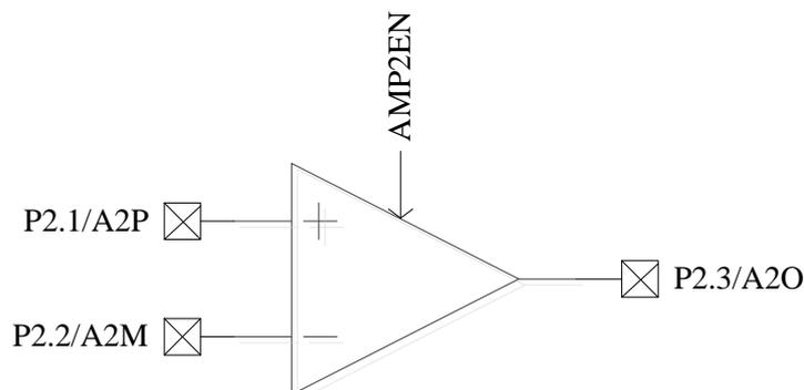
图 29-5 AMP2 输入输出相关 pad 的情况
