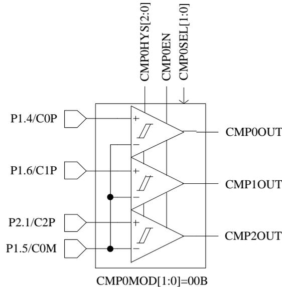
图 30-8 CMP0MOD[1:0]=00B, 选择无内置电阻 3 比较器模式, 用于片外虚拟中心点电阻情况下的电机 BEMF 检测
