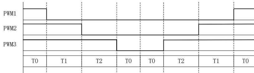
图 14-8 七段式 SVPWM 输出电平
