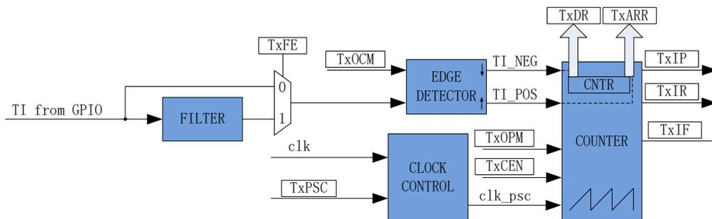
图 18-5 输入 timer 模式原理框图
