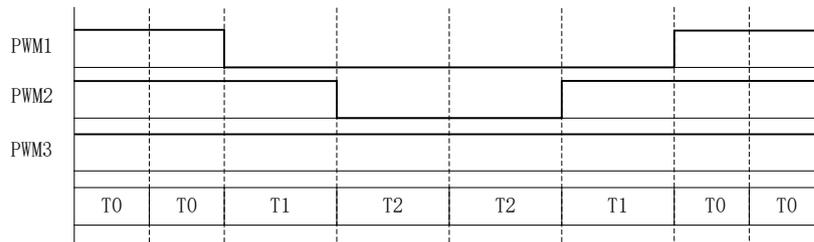
图 14-9 五段式 SVPWM 输出电平
