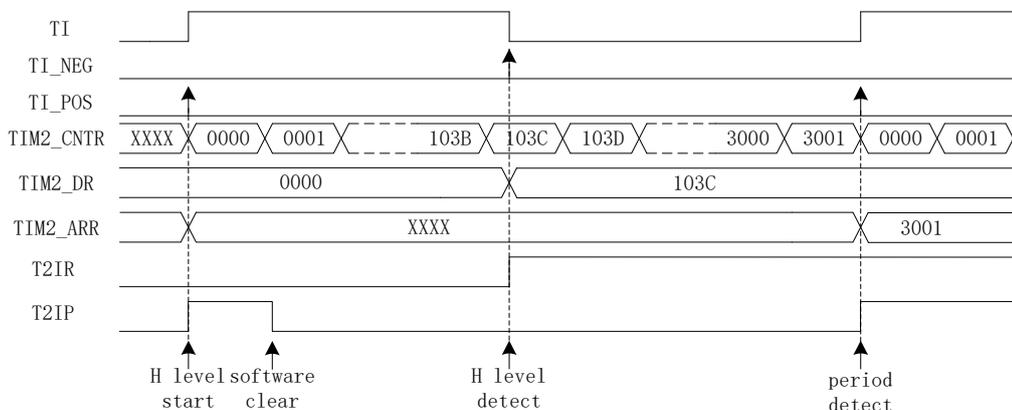
图 17-6 输入 timer 模式 (T2CES=0) 时序图
