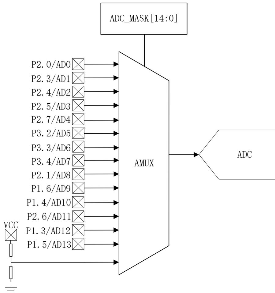
图 24-1 ADC 多路复用器框图
