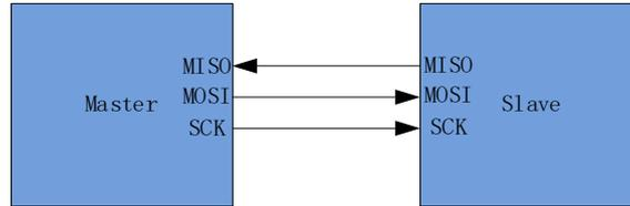
图 9-1 3 线单主方式和 3 线单从方式连接图
