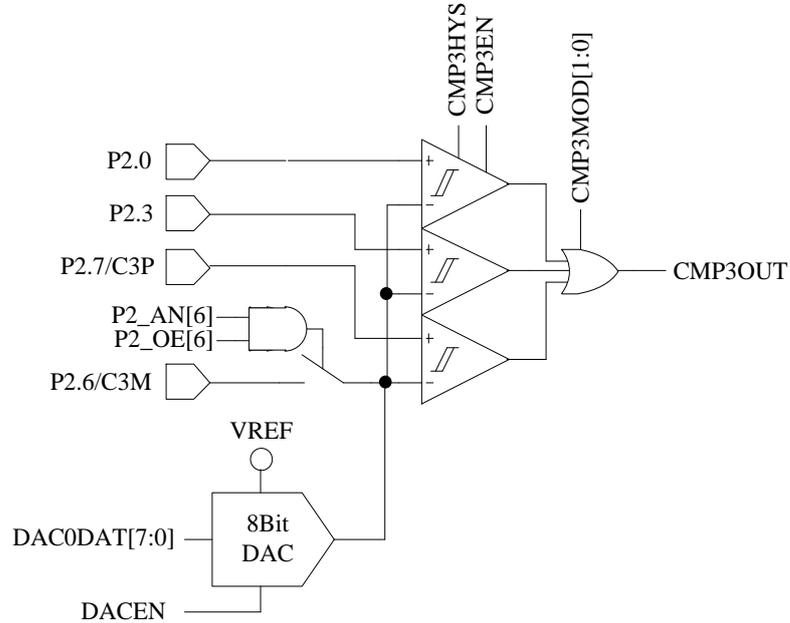
图 30-1 比较器 CMP3 的输入输出相关信号
