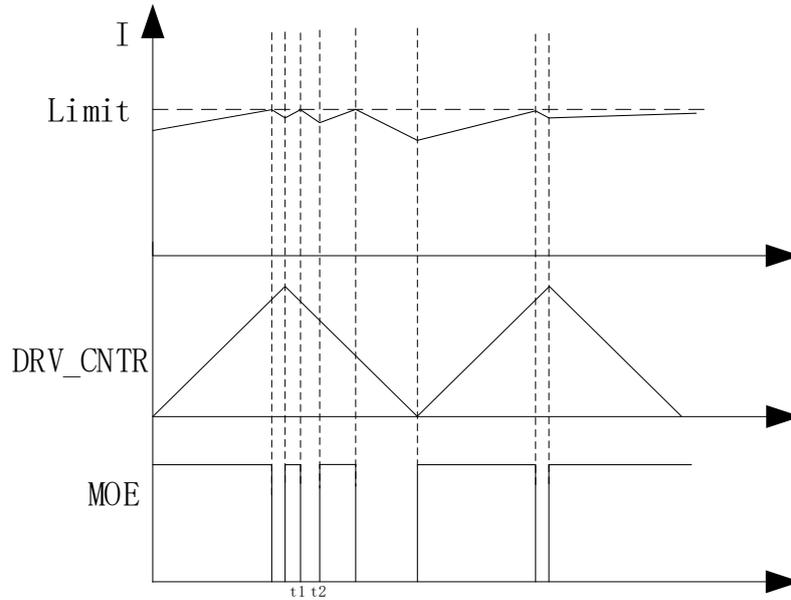
图 30-6 MOEMD=11 模式的逐波限流 ( $t_2-t_1=5\mu s$ )
