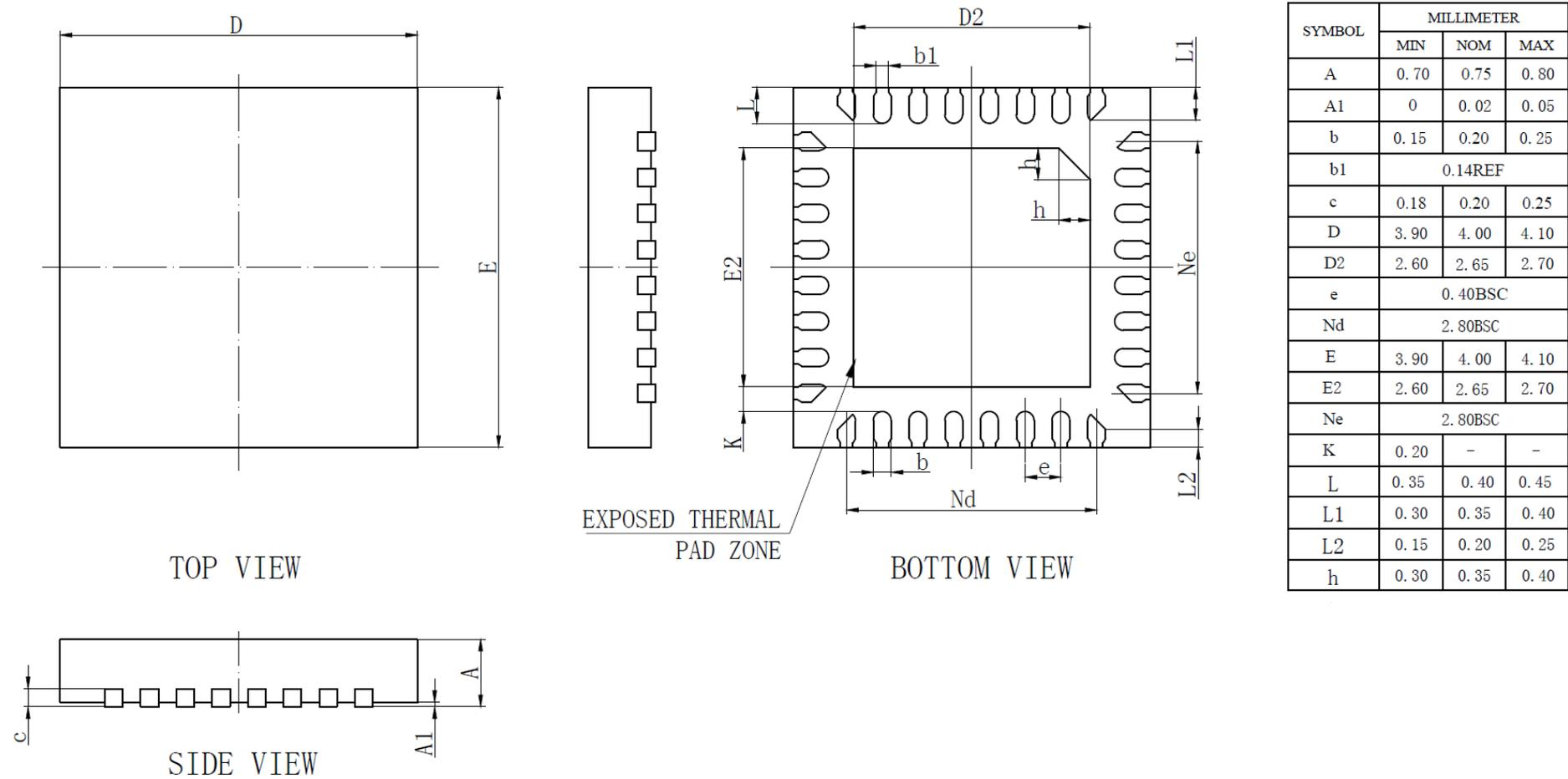
图 3-2 QFN32\_4X4 封装尺寸图
