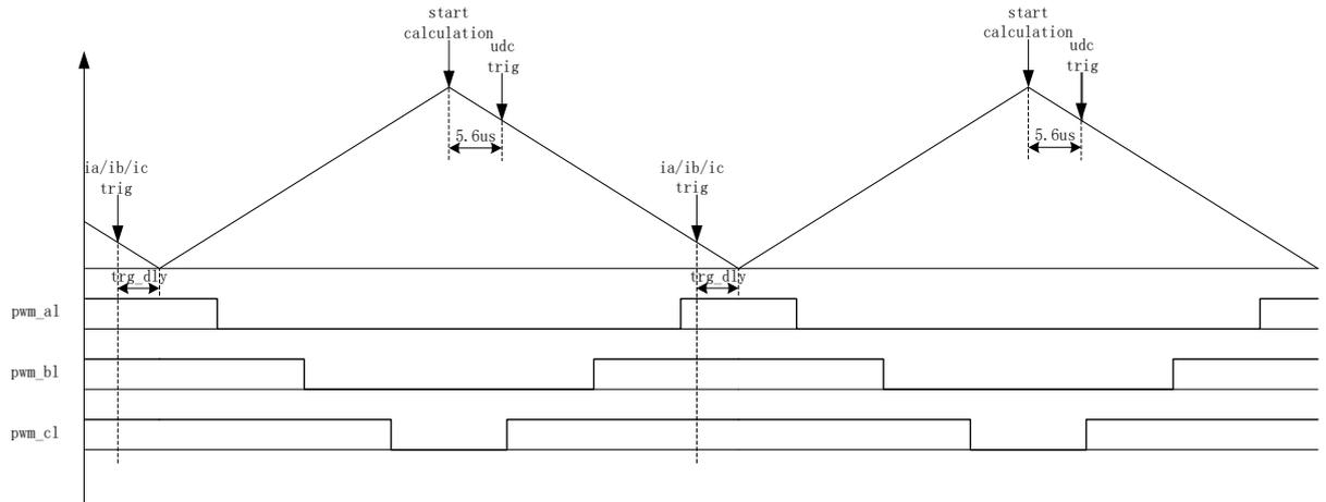
图 14-11 双三电阻电流交替采样模式
