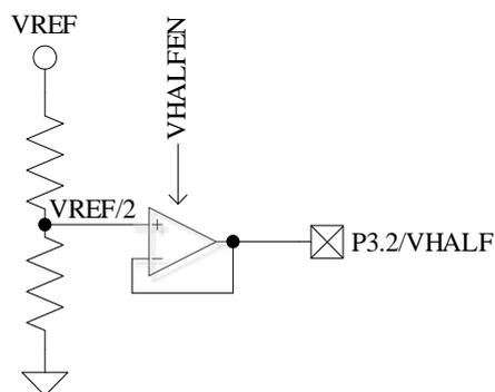
图 28-1 VHALF 模块的端口输入输出情况
