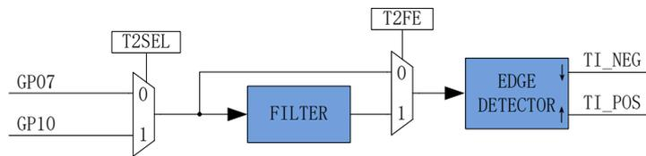
图 17-3 输入信号滤波和边沿检测框图
