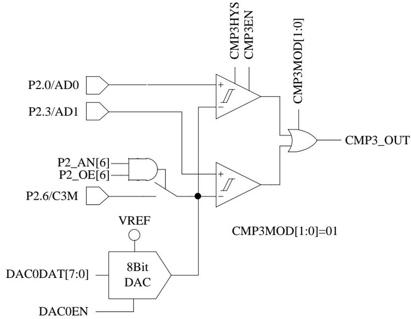
图 30-3 CMP3MOD[1:0]=01B, 选择双比较器输入模式
