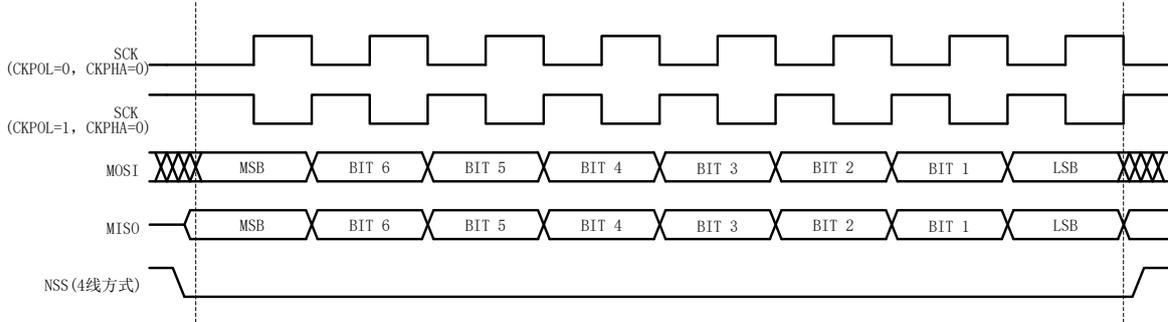
图 9-5 从方式数据/时钟时序图(CPHA=0)
