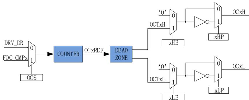
图 20-2 输出控制模块前级框图
