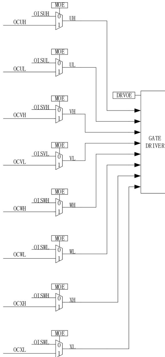
图 20-8 输出控制模块后级框图
