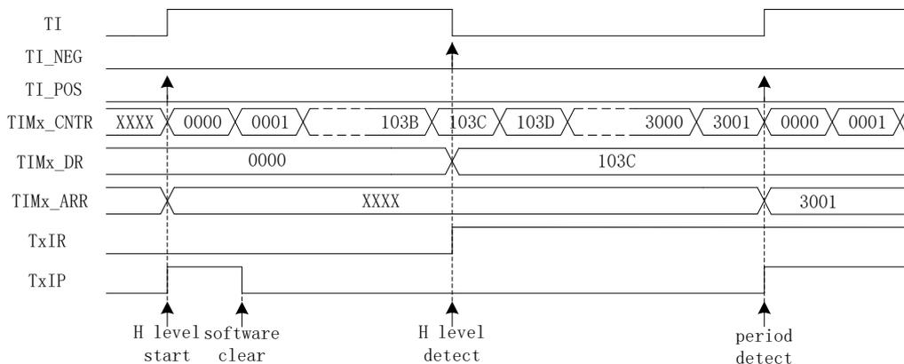
图 18-6 输入 timer 模式(TxOCM=0)时序图
