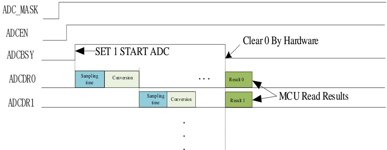
图 24-3 所示，启动 ADC 操作
