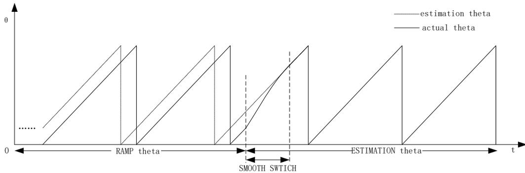
图 14-14 角度平滑切换曲线
