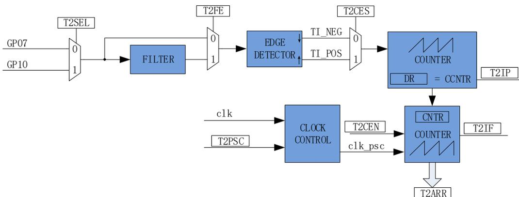
图 17-7 输入 counter 模式原理框图
