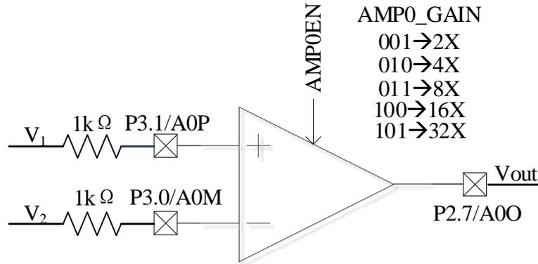
图 29-3 AMP0 工作在 PGA 差分输入模式
