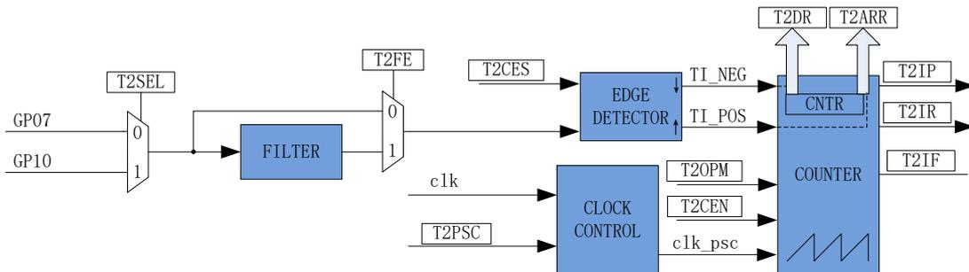
图 17-5 输入 timer 模式原理框图
