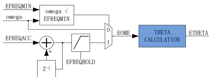
图 14-13 估算器强制角度原理框图
