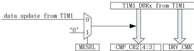
图 20-5 TIM1 自动控制 DRV\_CMCR 和 CMP\_CR2[4:3]
