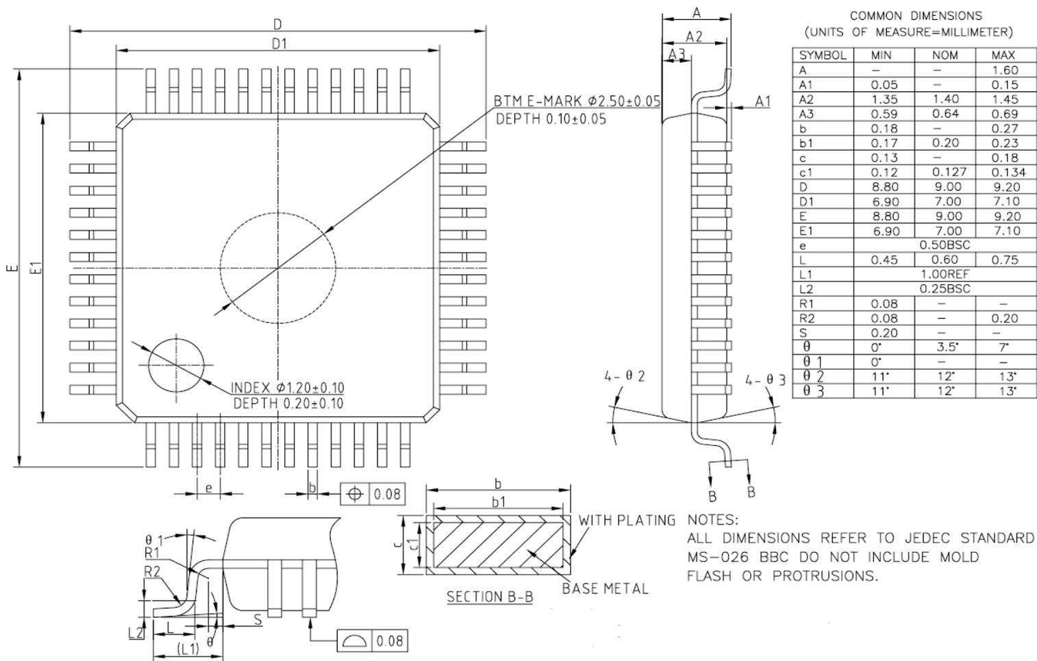
图 3-1 LQFP48\_7X7 封装尺寸图
