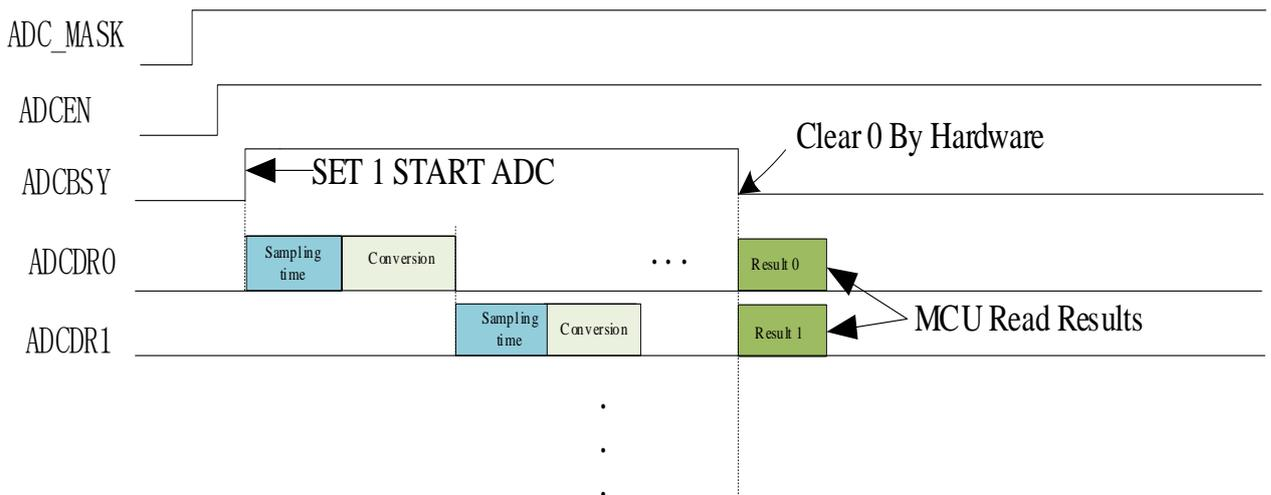
图 24-3 ADC 顺序扫描采样时序图
