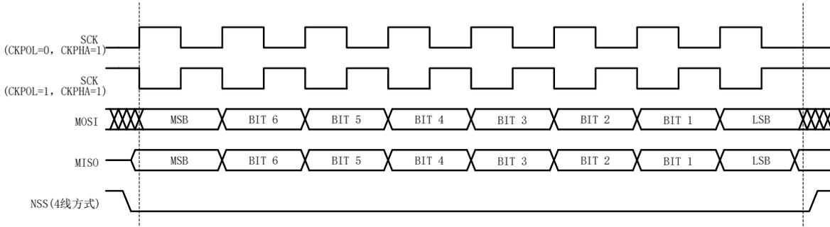
图 9-6 从方式数据/时钟时序图(CPHA=1)
