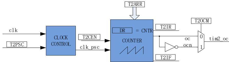
图 17-1 输出模式原理框图
