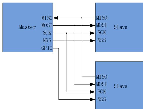
图 9-3 4 线单主方式和 4 线从方式连接图
