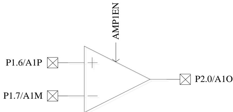
图 29-4 AMP1 输入输出相关 pad 的情况
