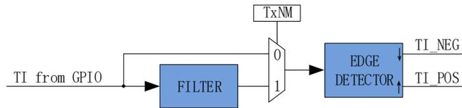
图 18-3 输入信号滤波和边沿检测框图
