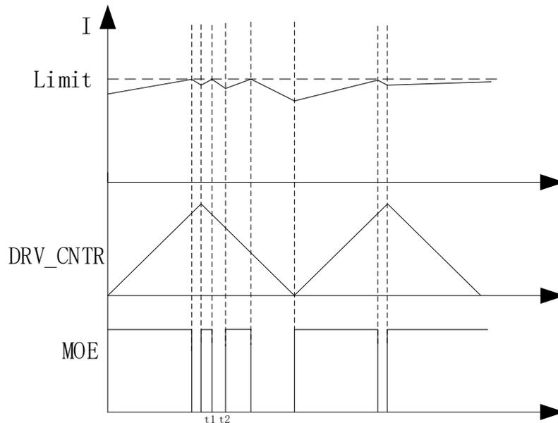
图 30-5 MOEMD=10 模式的逐波限流 ( $t_2-t_1=10\mu s$ )
