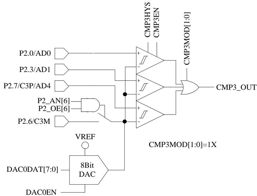
图 30-4 CMP3MOD[1:0]=1XB, 选择三比较器输入模式
