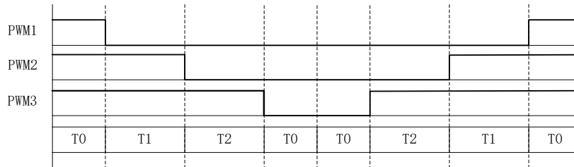
图 14-8 七段式 SVPWM 输出电平
