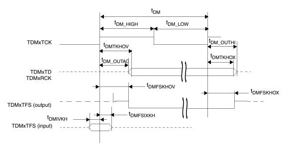
Figure 21. TDM Transmit Signals
