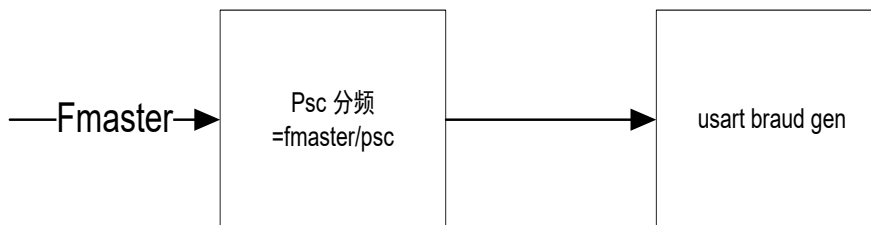
图 18-6 红外低功耗模式原理框图
