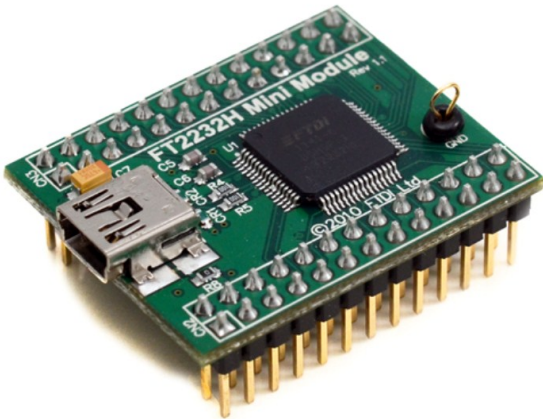
Figure 1.1 - FT2232H Mini Module
