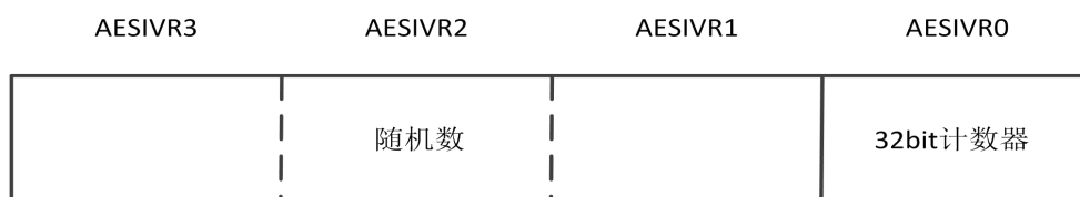
图 9-8 32 位计数器和随机数的存储方式
