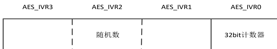
图 9-8 32 位计数器和随机数的存储方式
