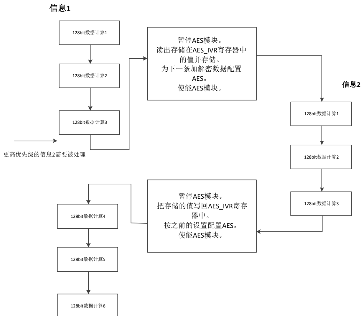
图 9-5 暂停模式流程
