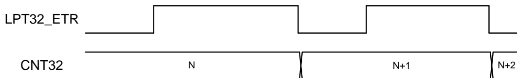
图 29-3 外部 ETR 脉冲异步计数
