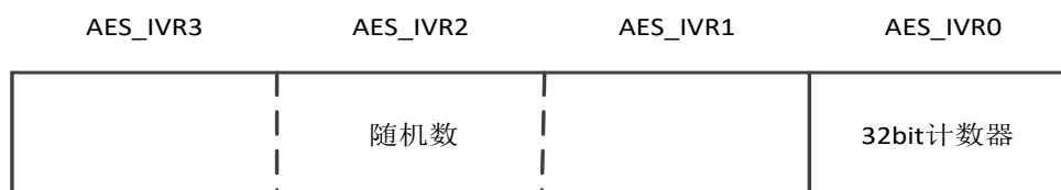
图 14-8 32 位计数器和随机数的存储方式
