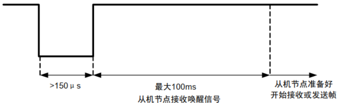
图 21-15LIN 总线唤醒信号
