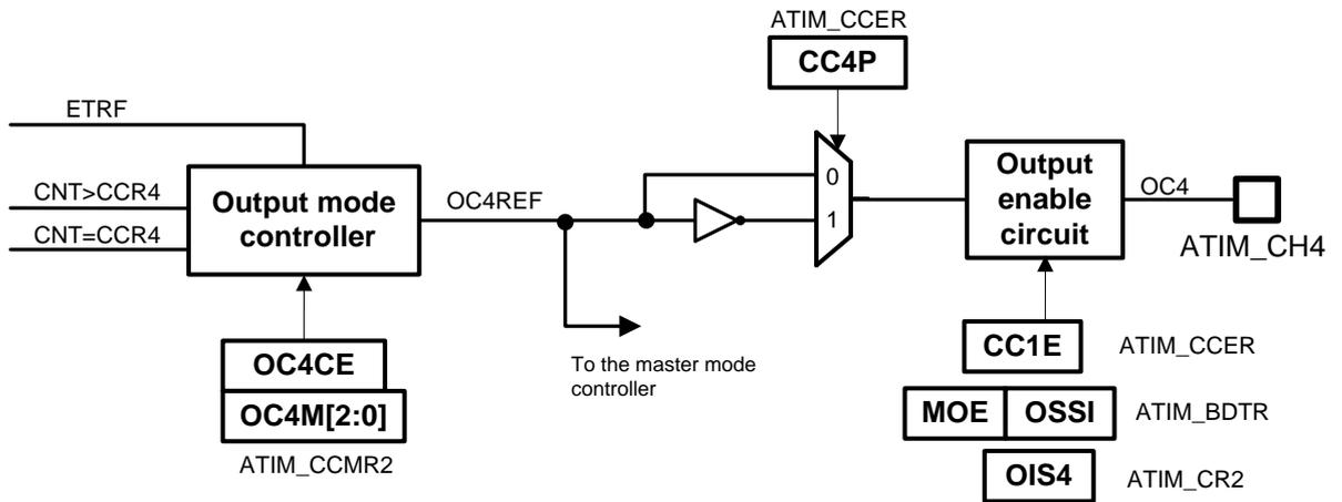
图29-27捕获/比较通道的输出部分(通道4)
