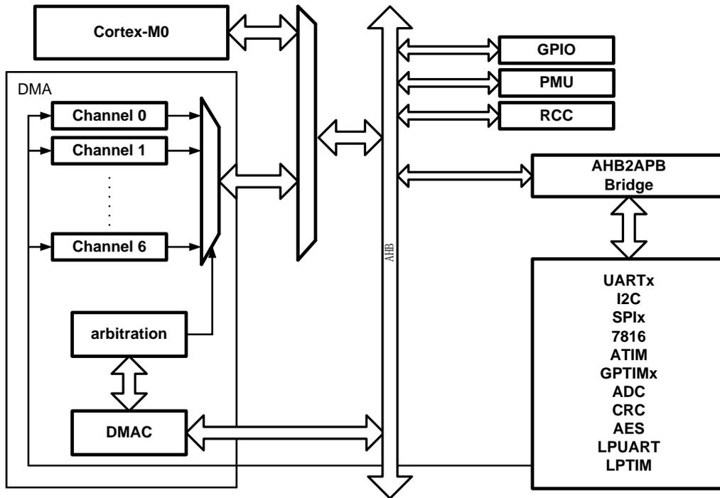
图 27-1 DMA 结构框图
