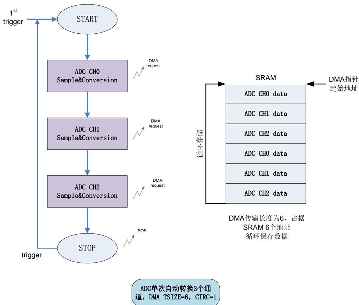
图 38-19 ADC 全自动触发+DMA 循环模式
