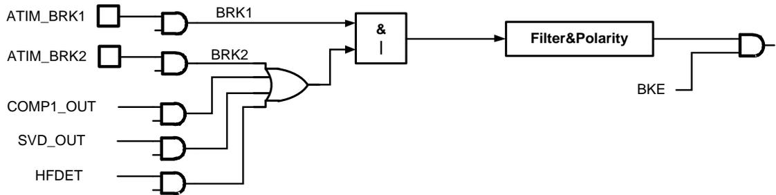
ATIM\_BRKx复用GPIO功能，当GPIO设置为数字外设功能时，其输入信号直接连接到ATIM的刹车输入上；当GPIO设置为其他功能时，ATIM的刹车输入端口被固定成1。通过BRKxGATE寄存器，可以控制门控后的BRKx信号的实际电平，软件能够灵活的将不使用的BRKx设置为0或者1电平，以适应后续逻辑电路的需要。
