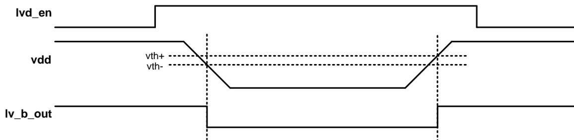
图 15-2 低压检测电路工作时序
