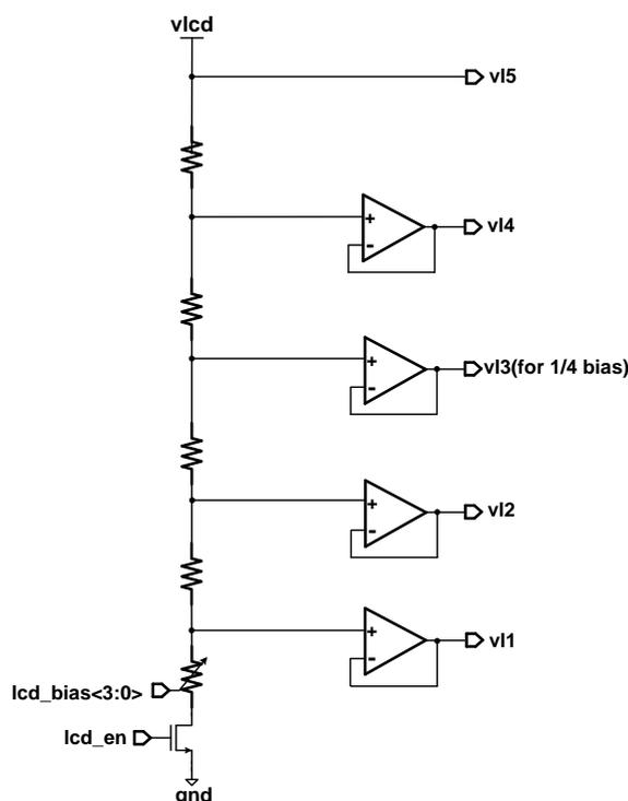
图 37-10 LCD 片内电阻 buffer 型驱动电路
