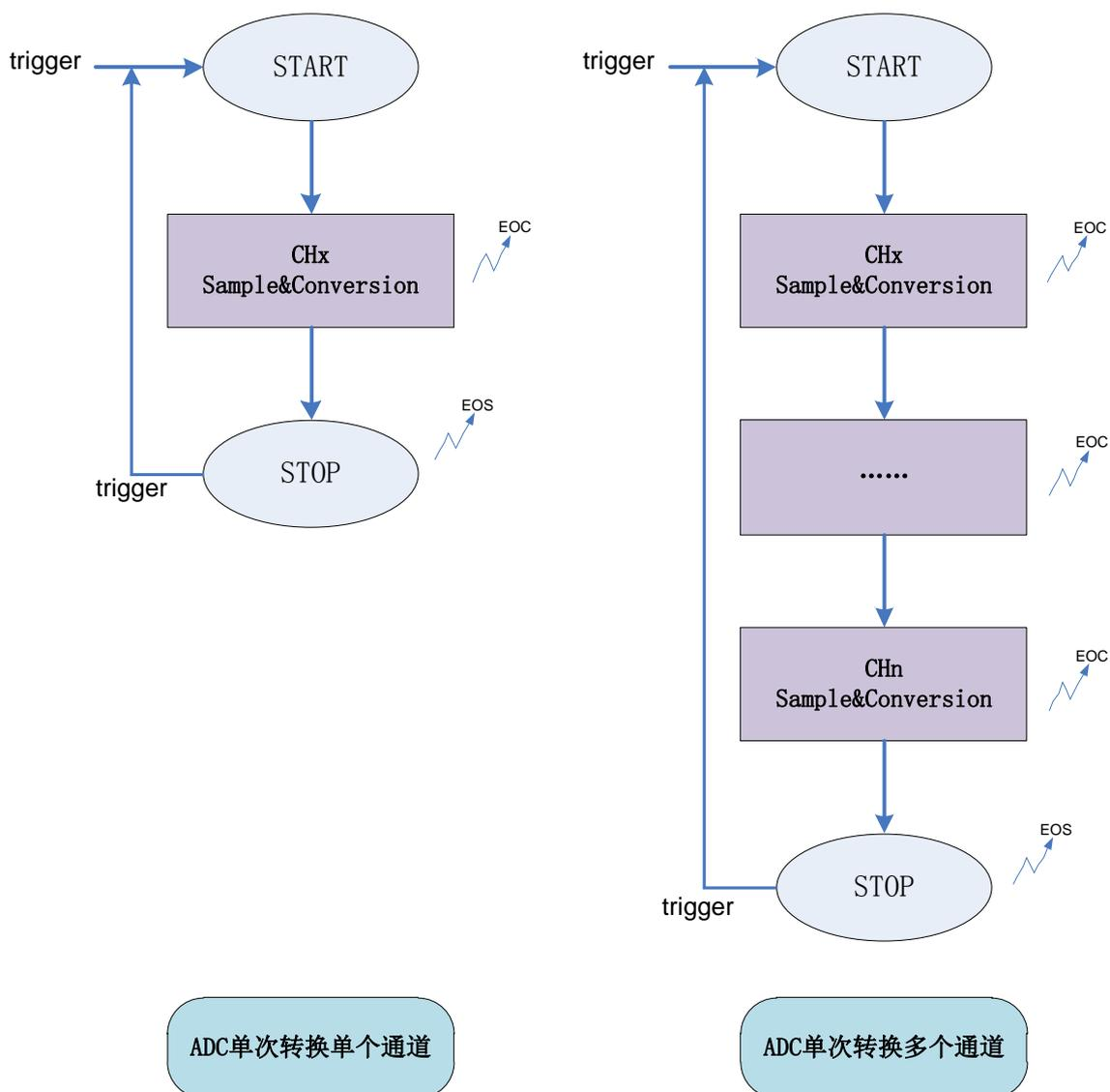
图 38-10 ADC 单次转换全自动触发模式
