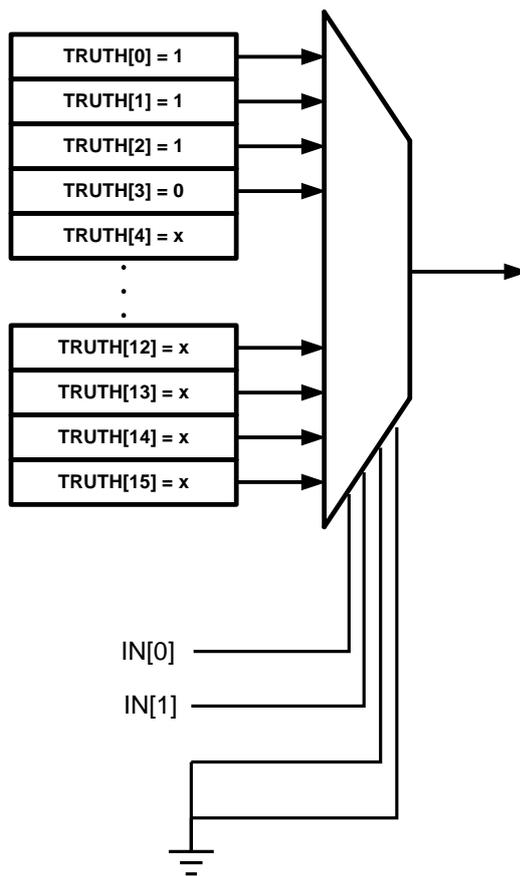
图 40-3 LUT 实现 2 输入 NAND 示意图
