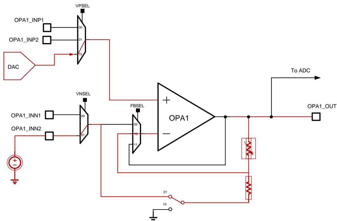
图 18-8 反相 PGA 带 DAC 偏置
