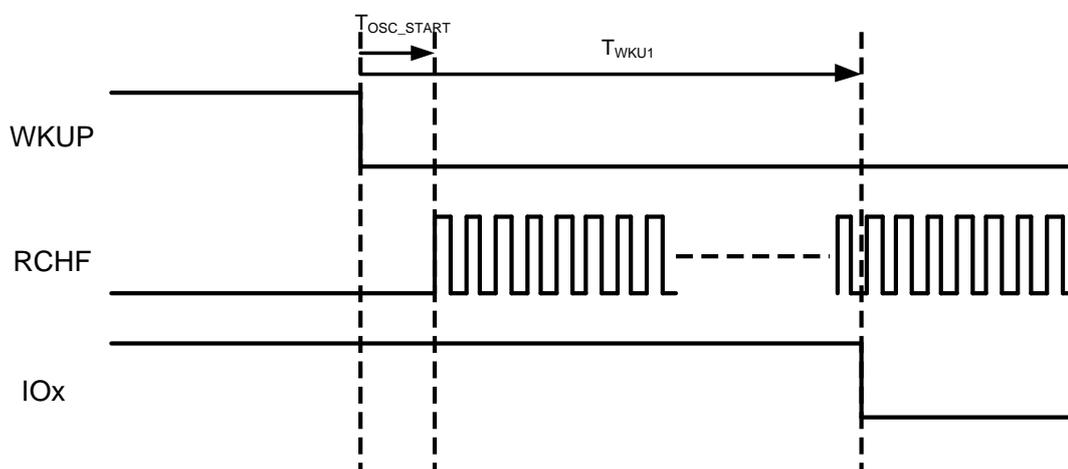
上图中  $T_{OSC\_START}$  表示唤醒事件到来后 RCHF 环振起振时间，典型值 3.5us
