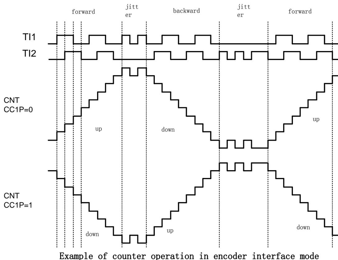
图30-32编码器模式下的计数器操作实例
