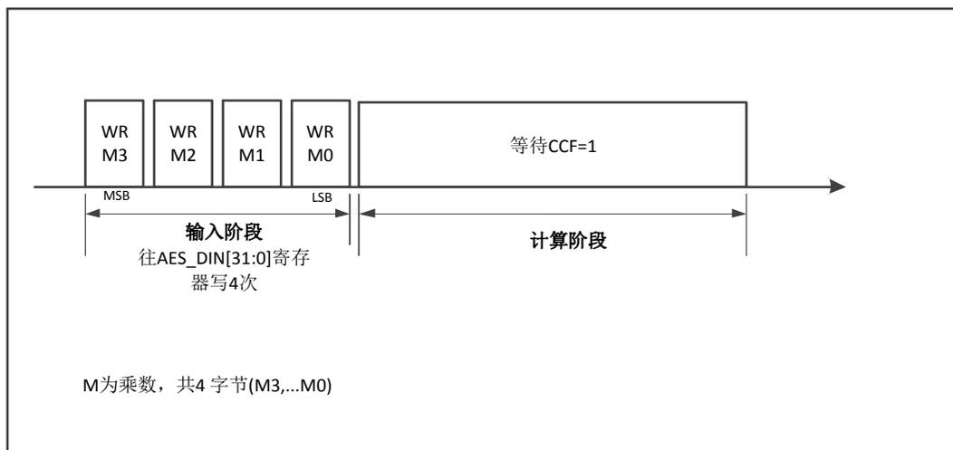
图 16-17 multH 模块使用流程示意图
