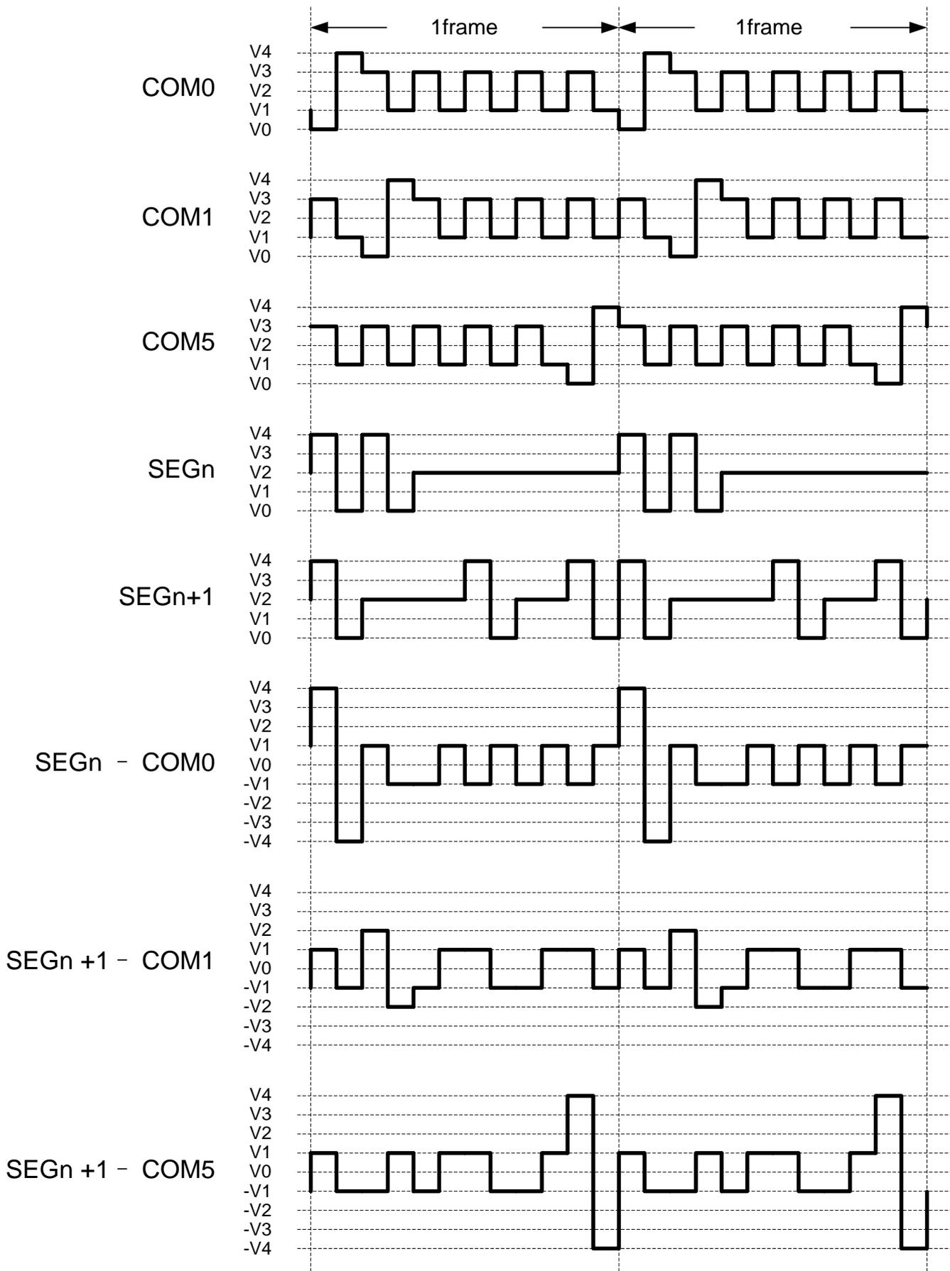
图 37-3LCD 驱动波形(1/6 duty, 1/4 bias, type A)
