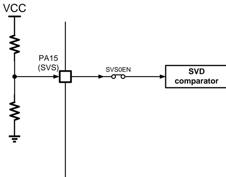
下图为内部电阻分压的外部电源检测：
