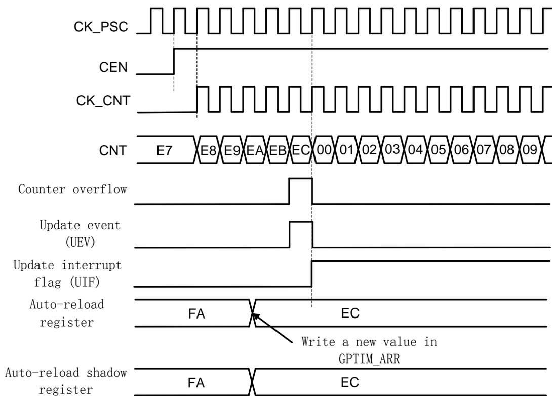
图 30-6 ARPE=0 (GPTIM\_ARR 没有预装载) 时的更新事件
