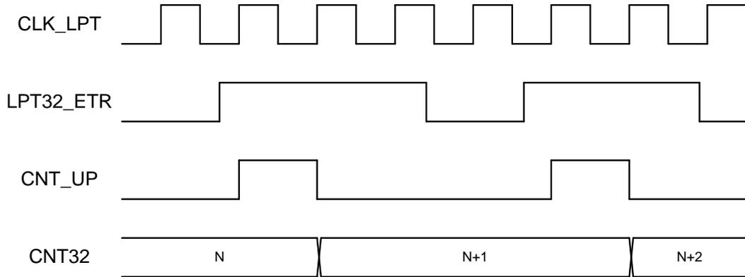
图 33-2 外部 ETR 脉冲上升沿触发计数
