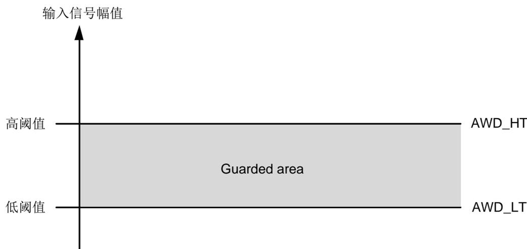
图 38-21 ADC 模拟看门狗阈值示意图
