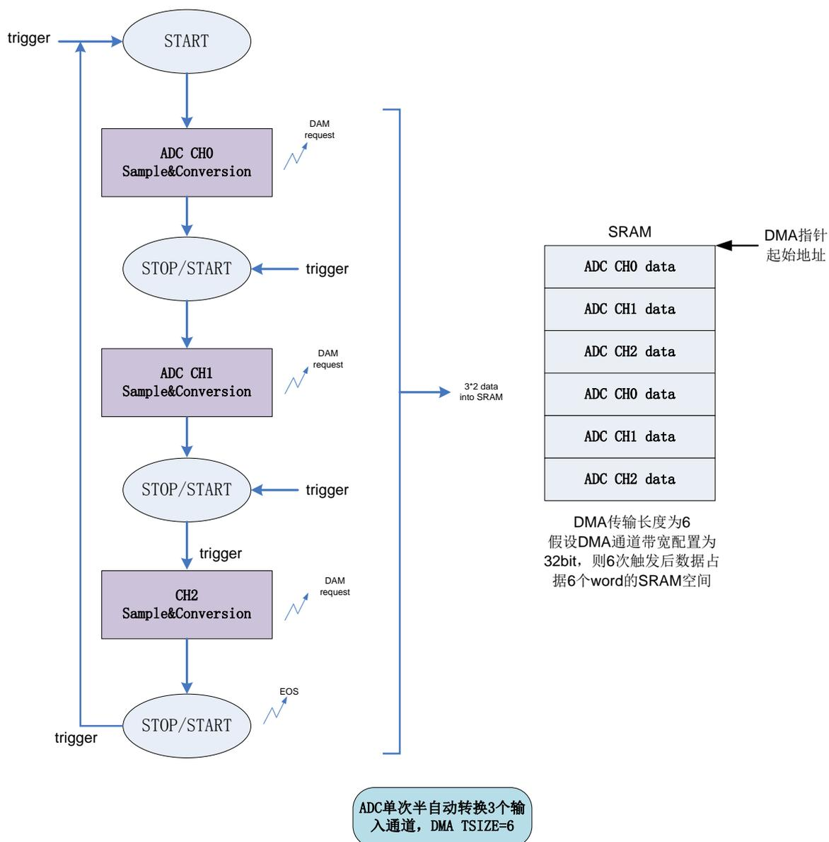
图 38-18 ADC 单次半自动触发+DMA
