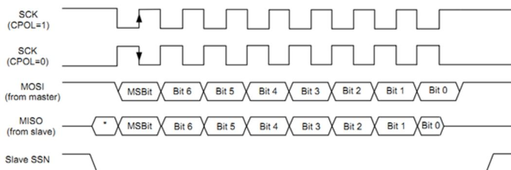
图 24-3 SPI 数据/时钟时序图 (CPHA=1)
