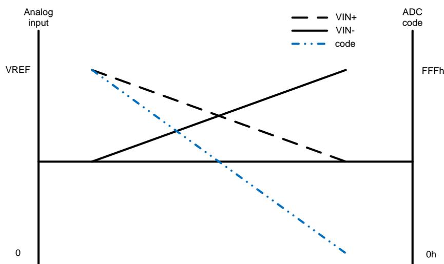
图 38-4 差分输入信号与码字的关系
