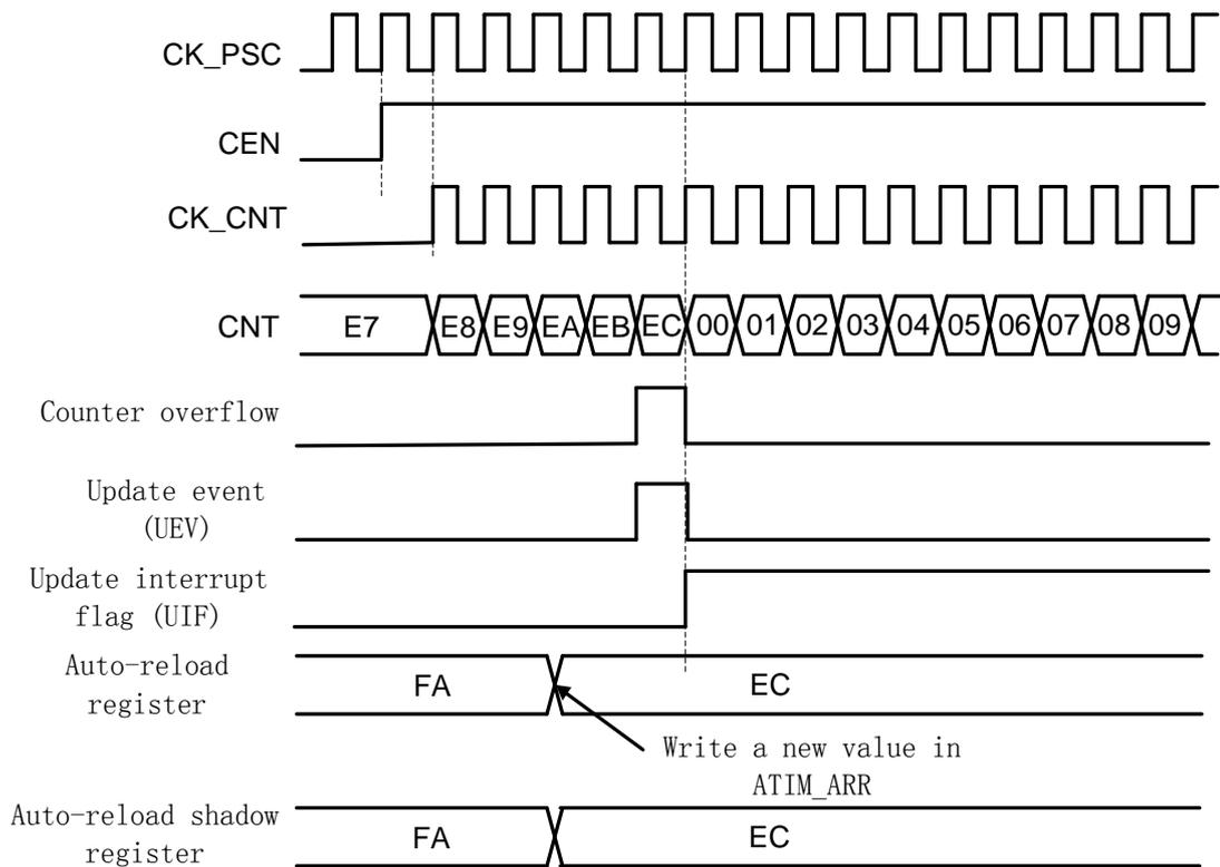
图 29-6 ARPE=0 (ATIM\_ARR 没有预装载) 时的更新事件
