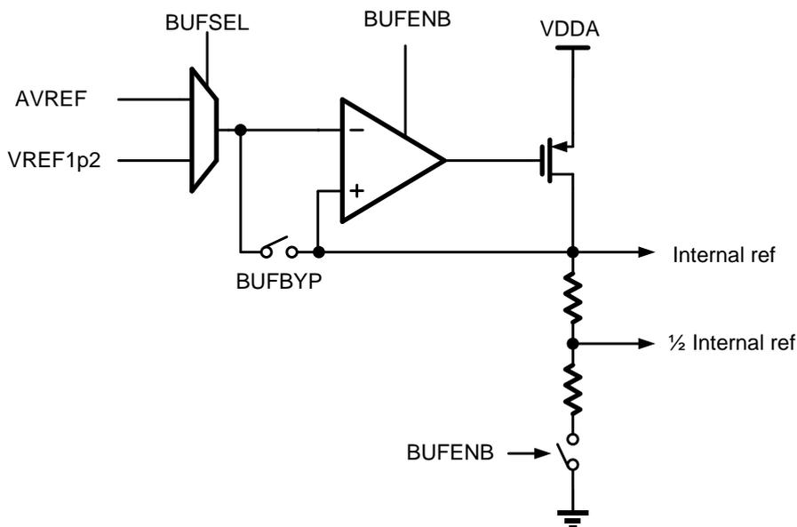
图 19-2 比较器内建基准缓冲器
