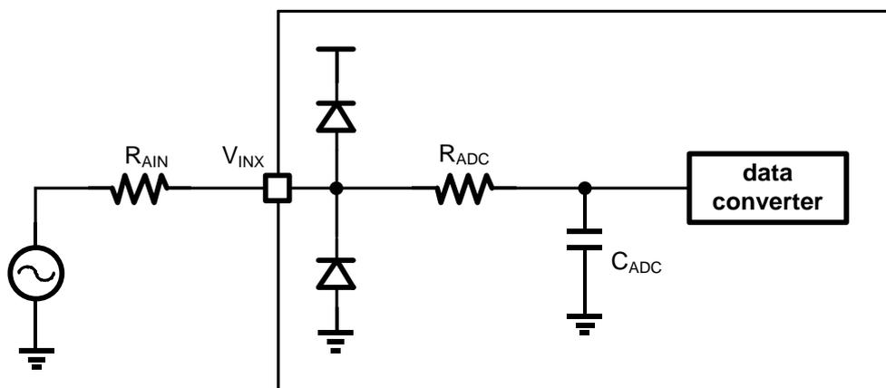
图 38-8 ADC 输入通道示意图
