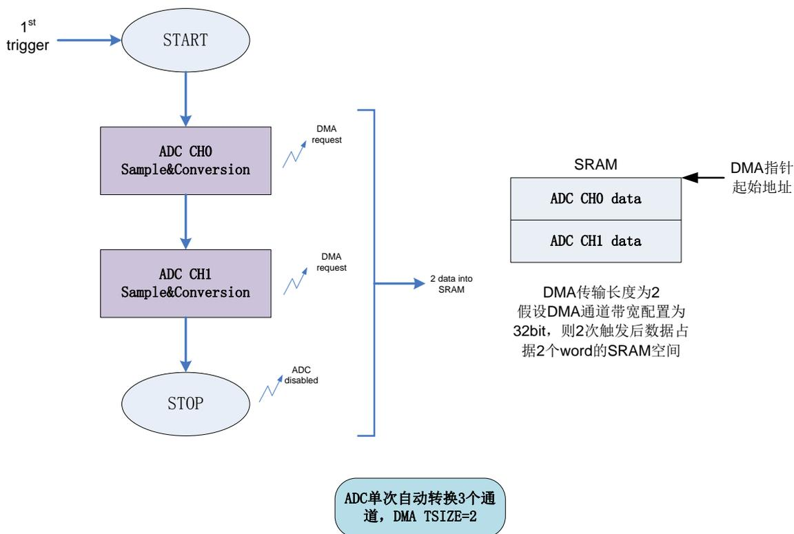
图 38-17 ADC 单次全自动触发+DMA 案例 2
