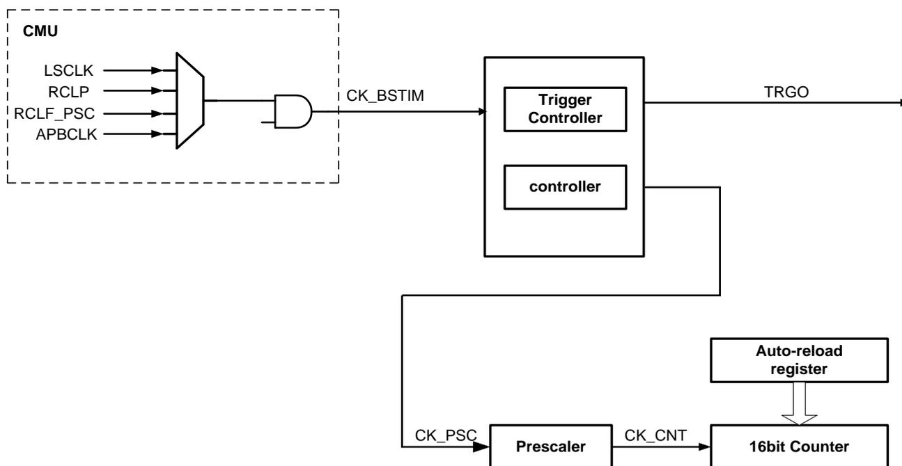
图 32-1 16 位基本定时器结构框图
