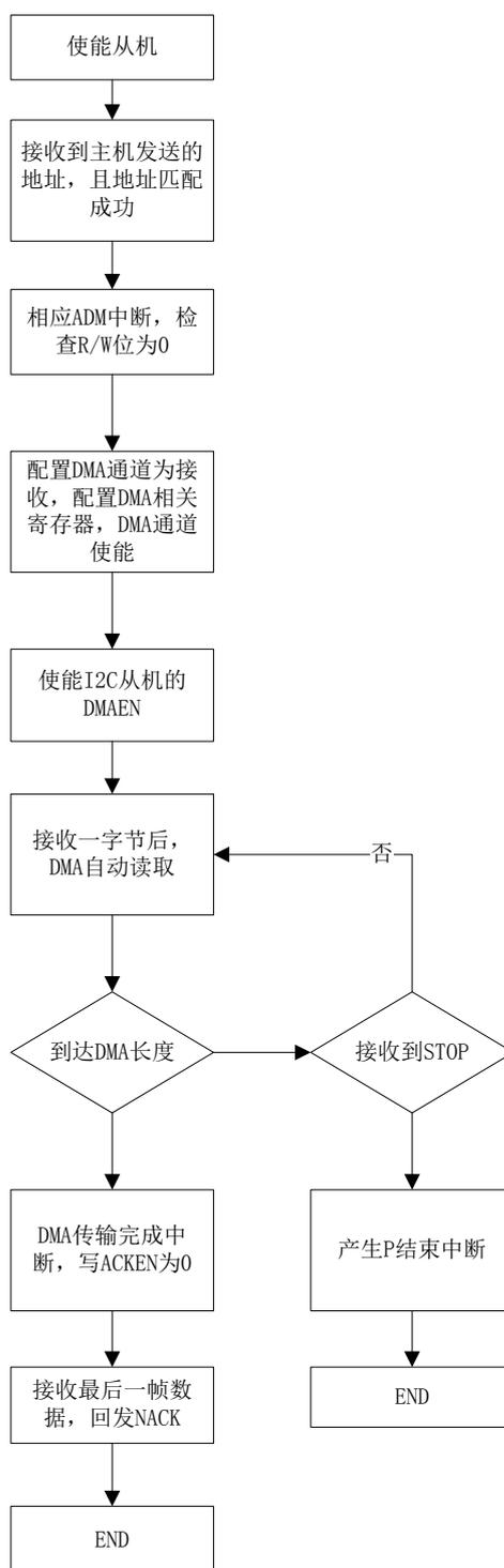
图 21-25 I2C 从机 DMA 接收流程图
