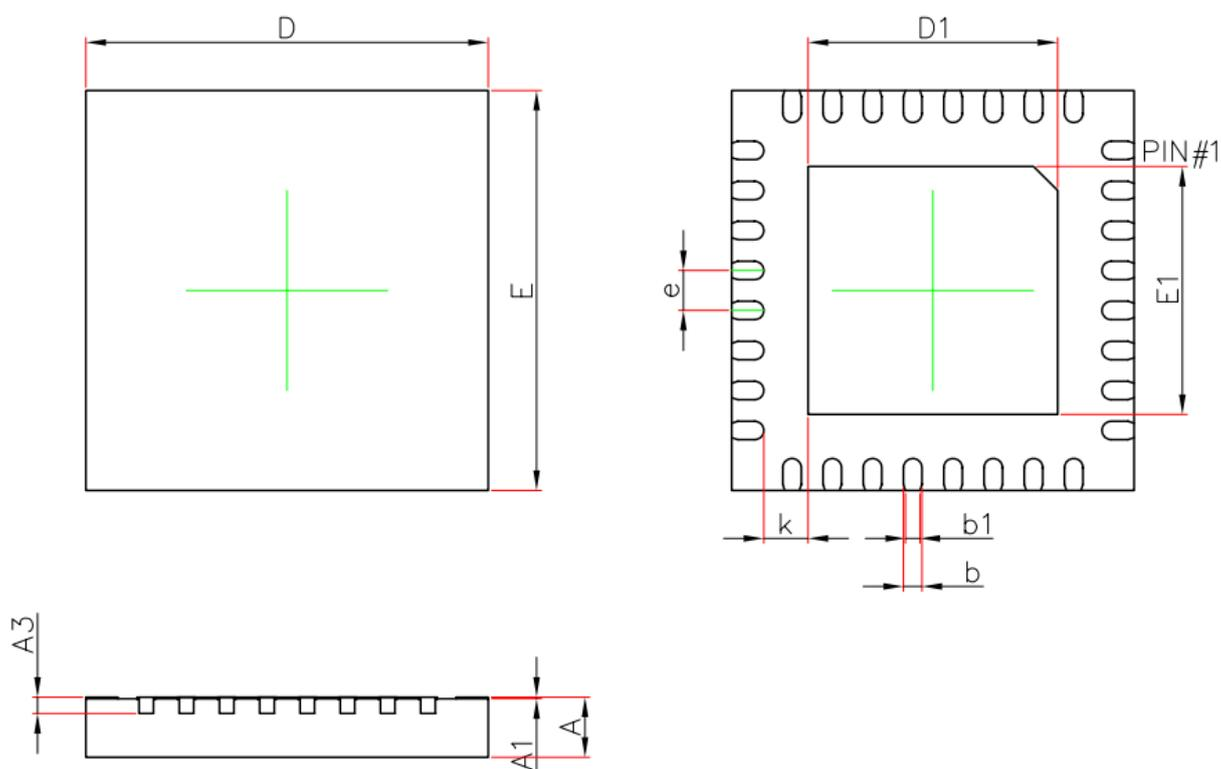
图 2-8 QFN32 封装尺寸图
