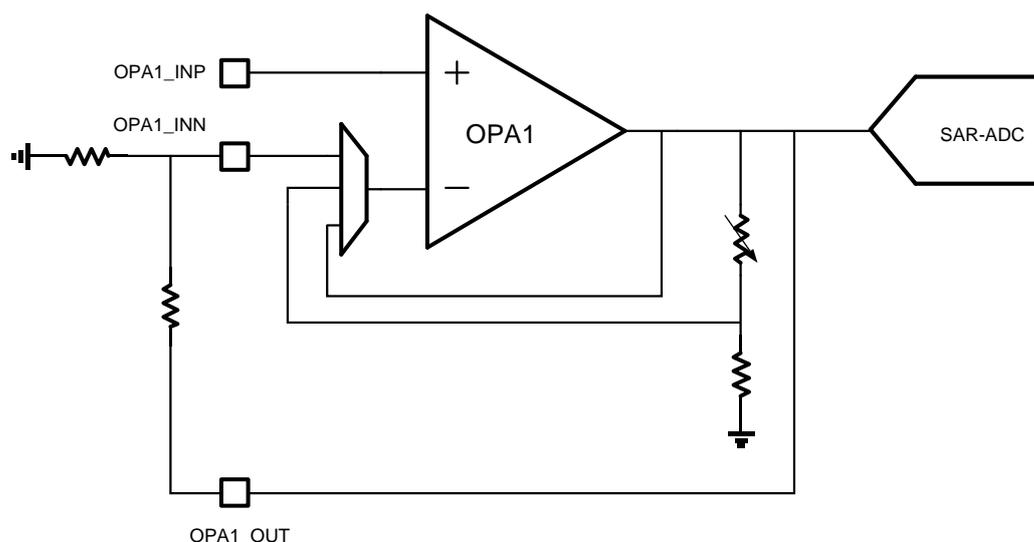
图 18-2 OPA 用作 ADC 前端放大
