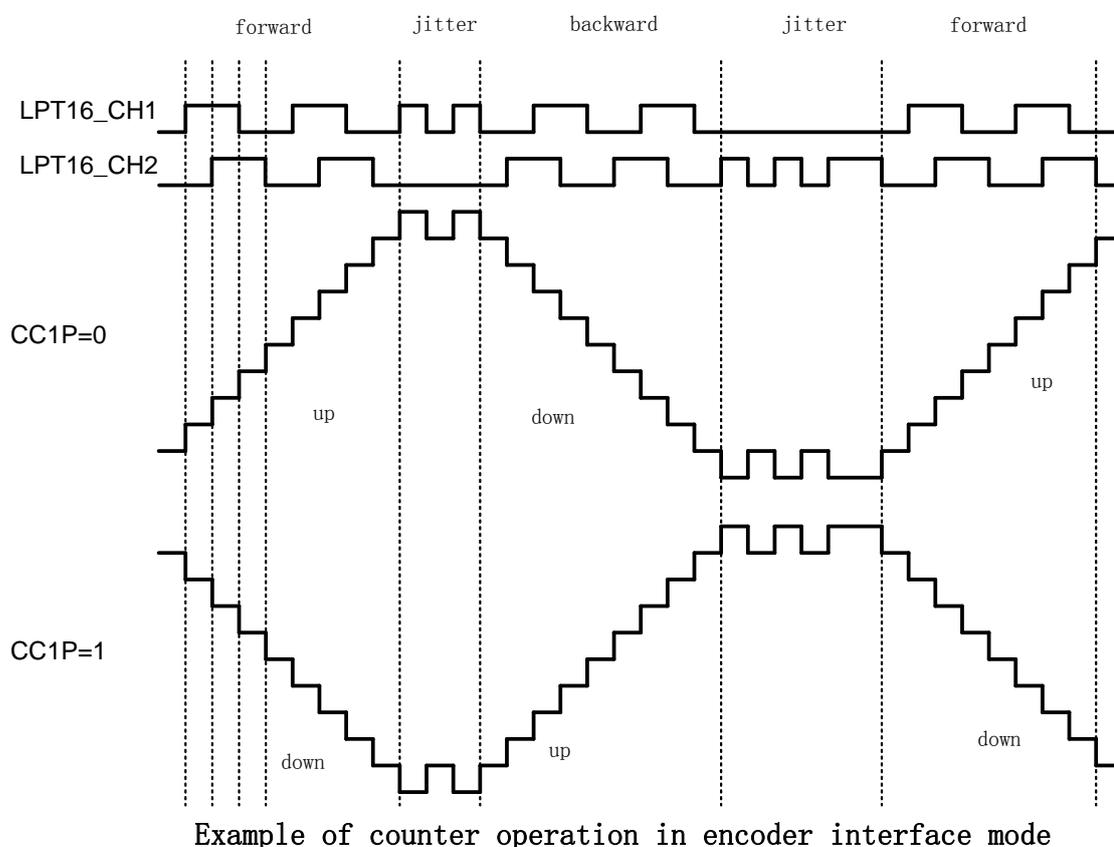
图34-8编码器模式下的计数器操作实例
