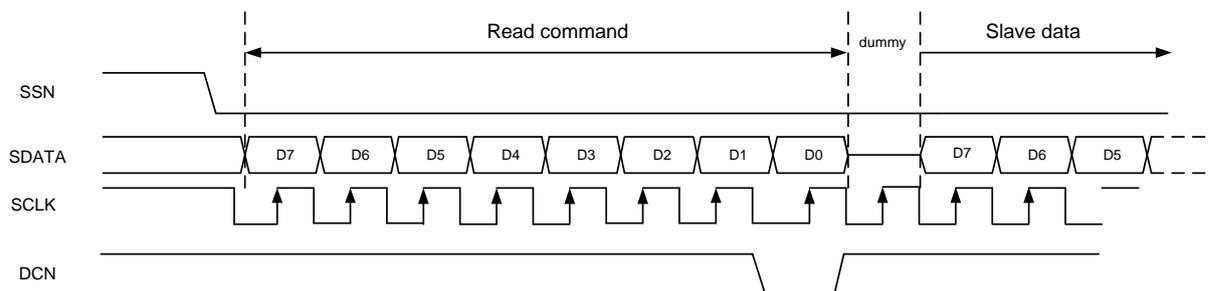
图 24-6 4 线半双工读操作 (有 dummy cycle)
