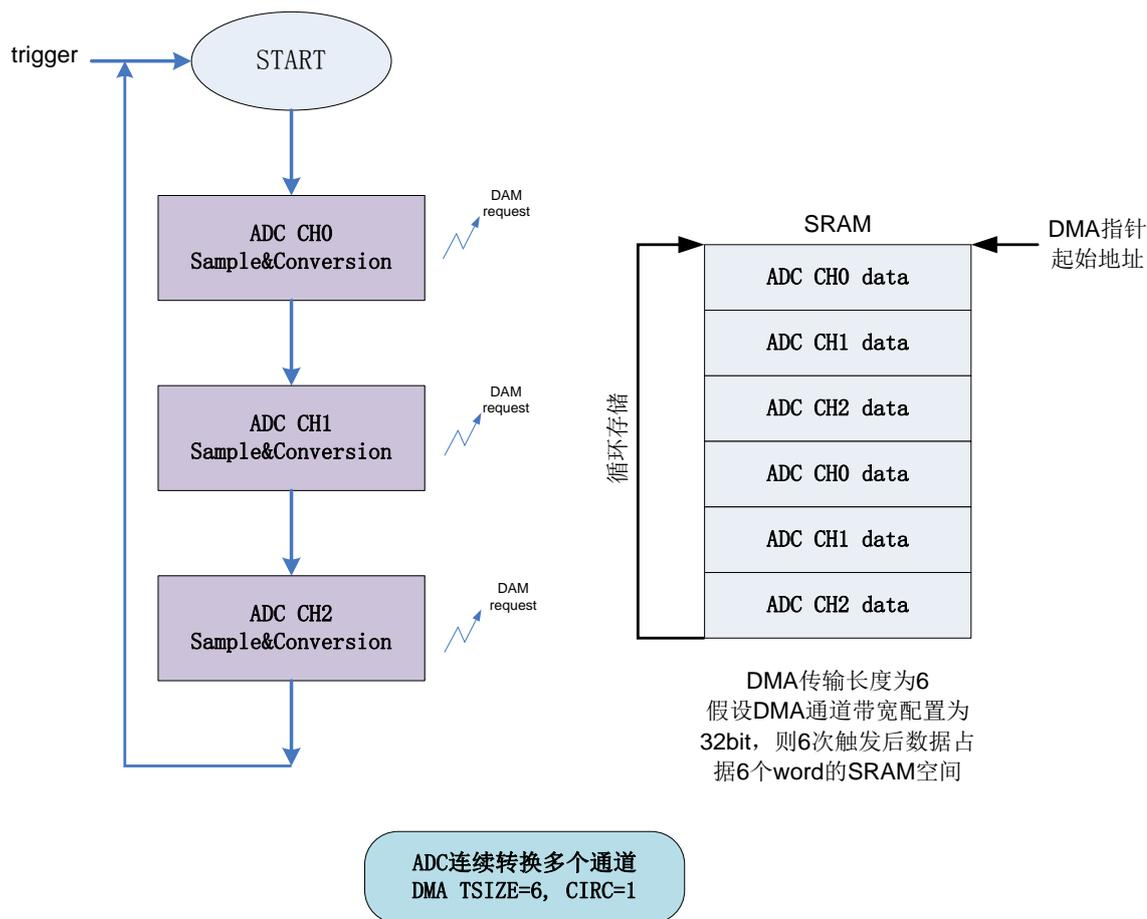
图 38-20 ADC 连续模式+DMA 循环模式
