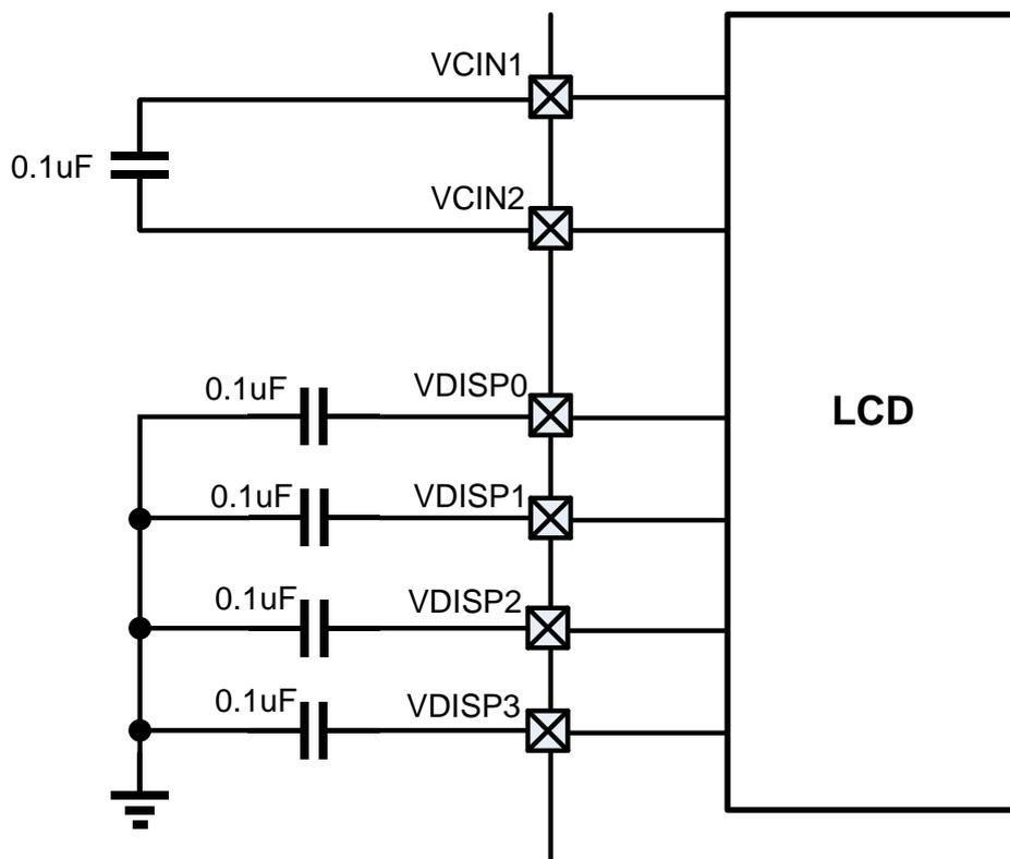
图 3-13 LCD 片外电容驱动模式电容连接
