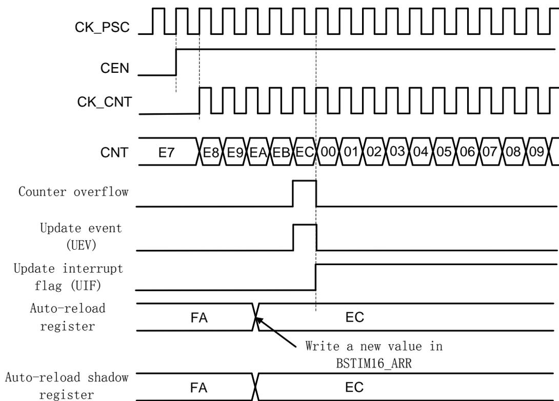
图 32-6 ARPE=0 (ARR 没有预装载) 时的更新事件
