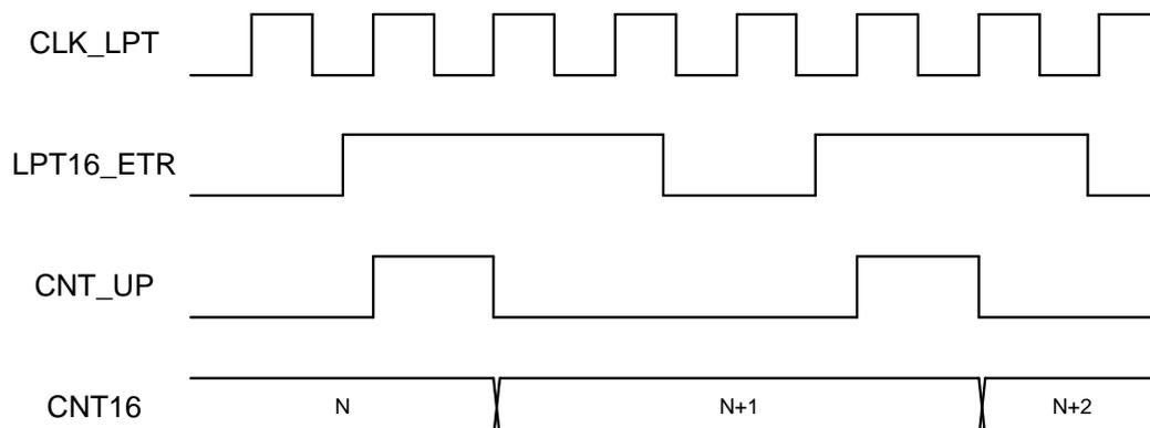
图 34-2 外部 ETR 脉冲上升沿触发计数
