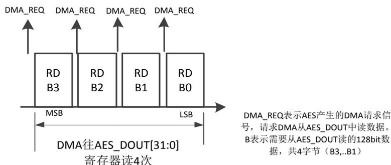
图 16-19 输出时 DMA 请求和数据传输示意图
