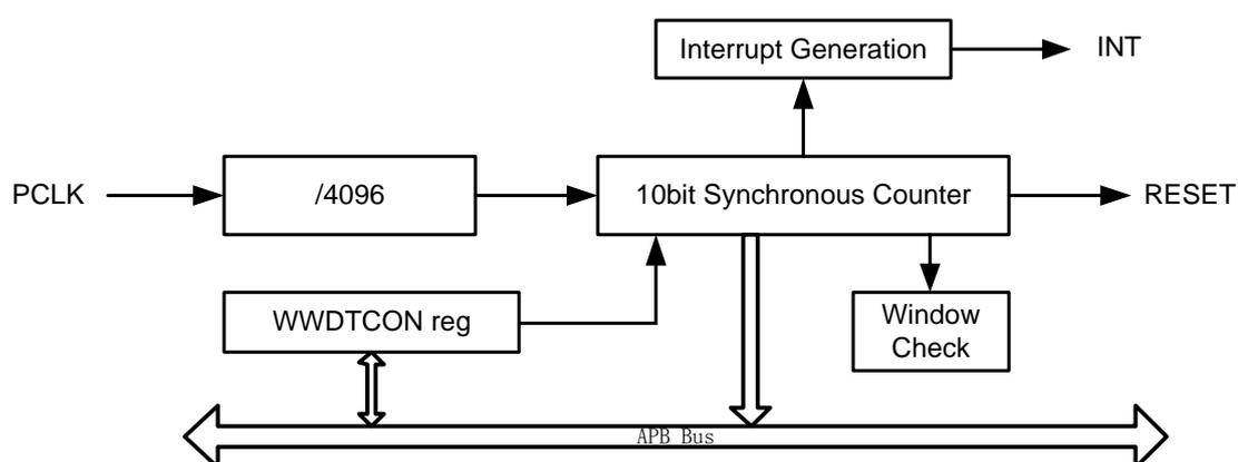
图 13-1 WWDT 结构框图
