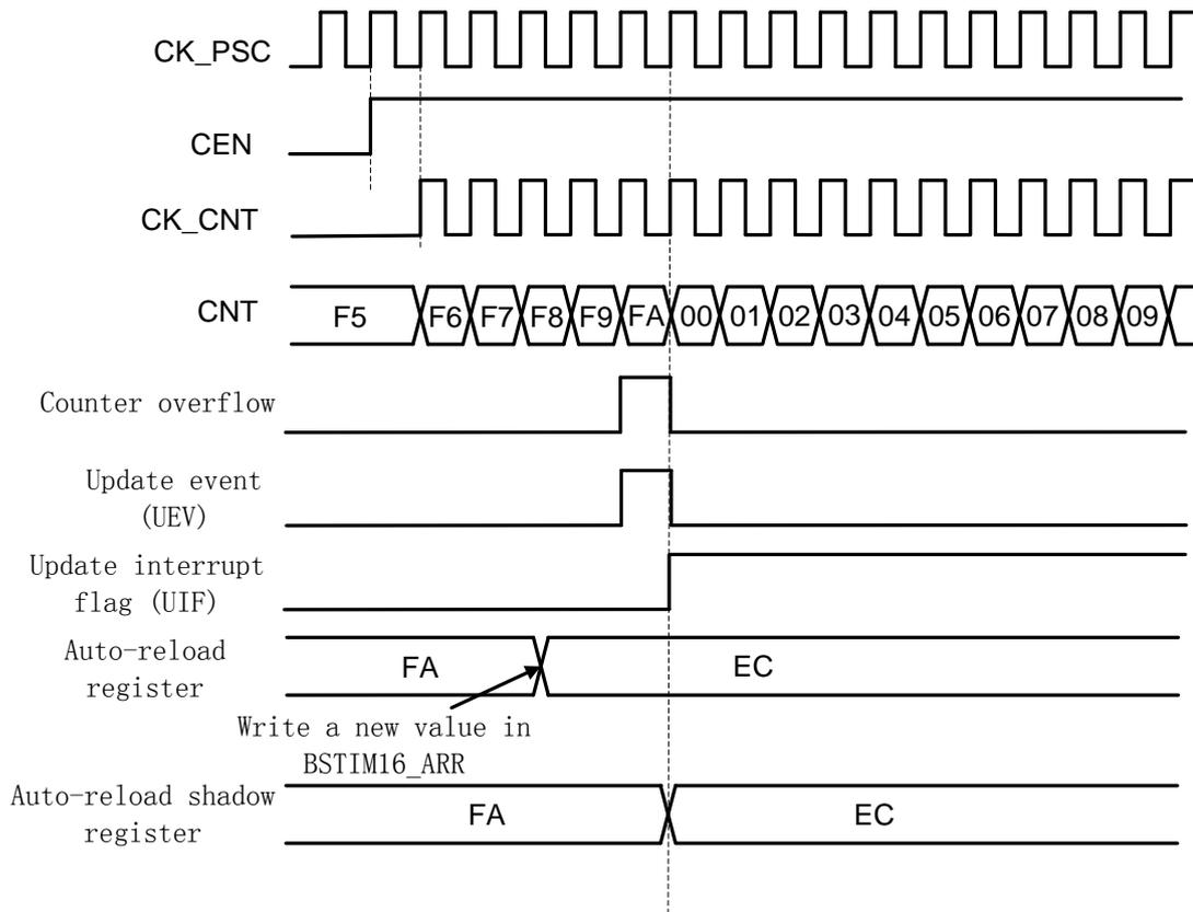
图 32-7 ARPE=1 (ARR 预装载) 时的更新事件
