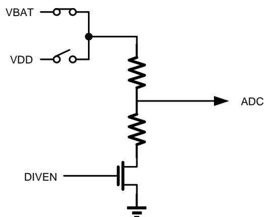
图 38-9 VBAT/VDD 分压电路示意图
