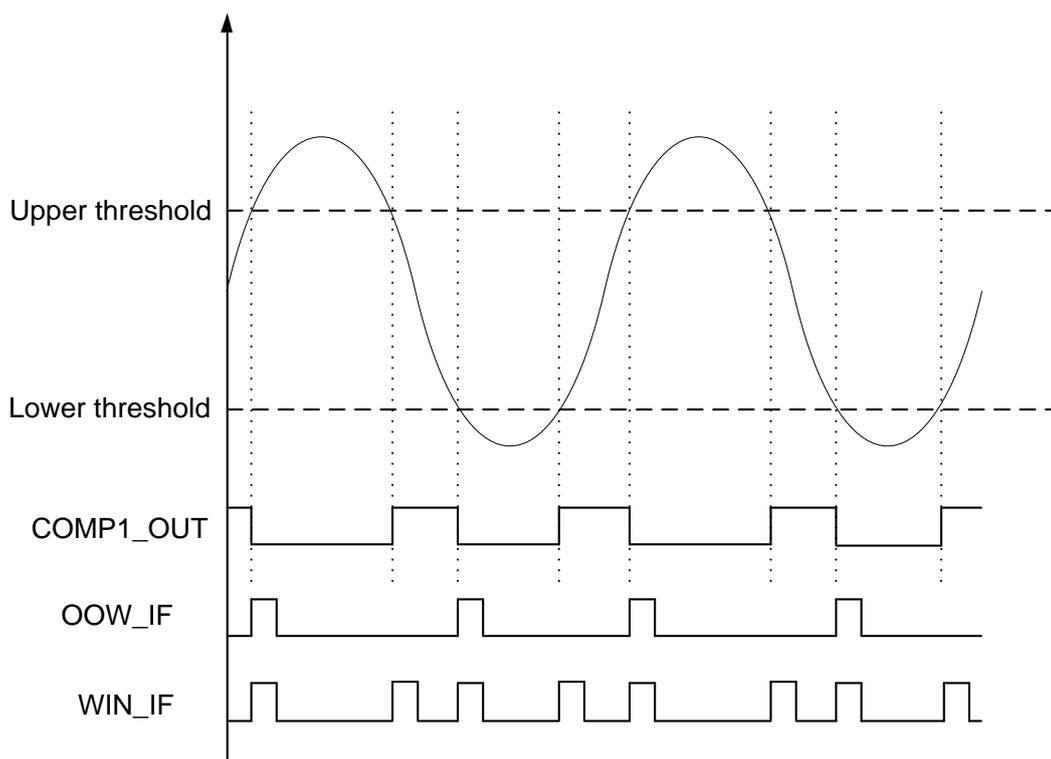
图 19-4 窗口比较器波形示意图
