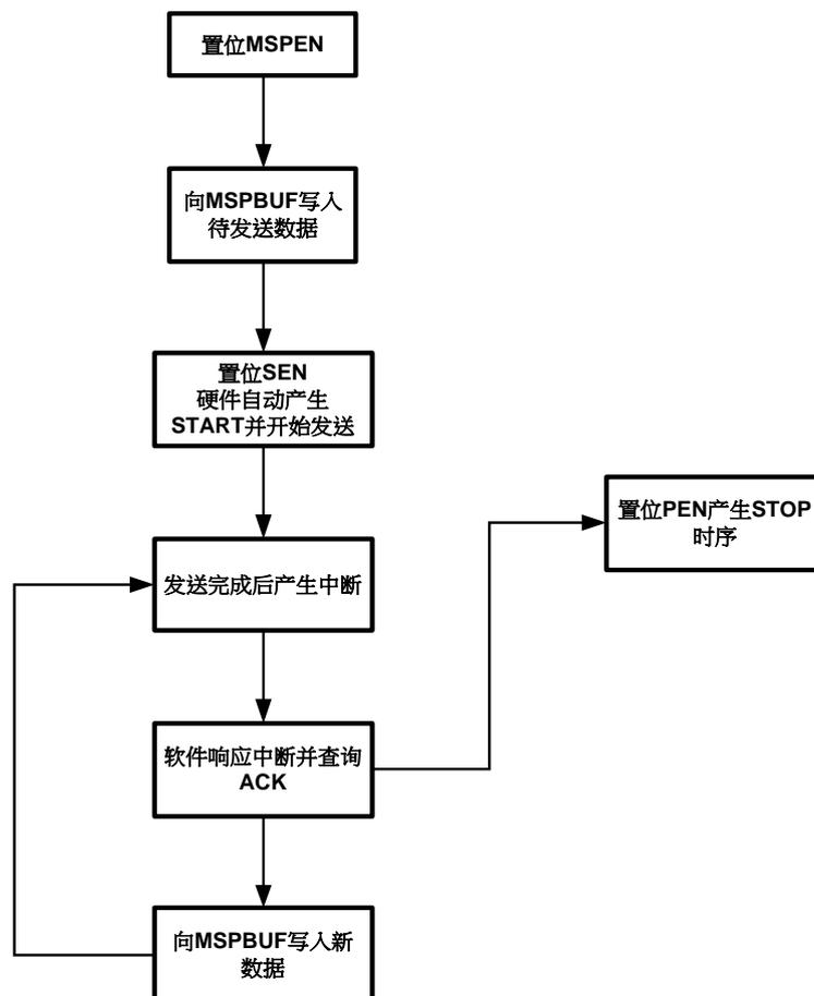
图 21-8I2C 软件发送数据流程图
