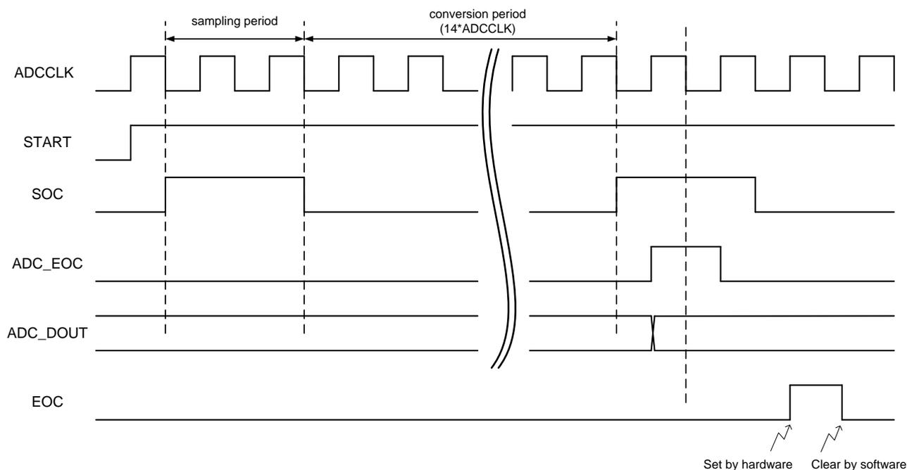
图 38-6 ADC 采样转换时序
