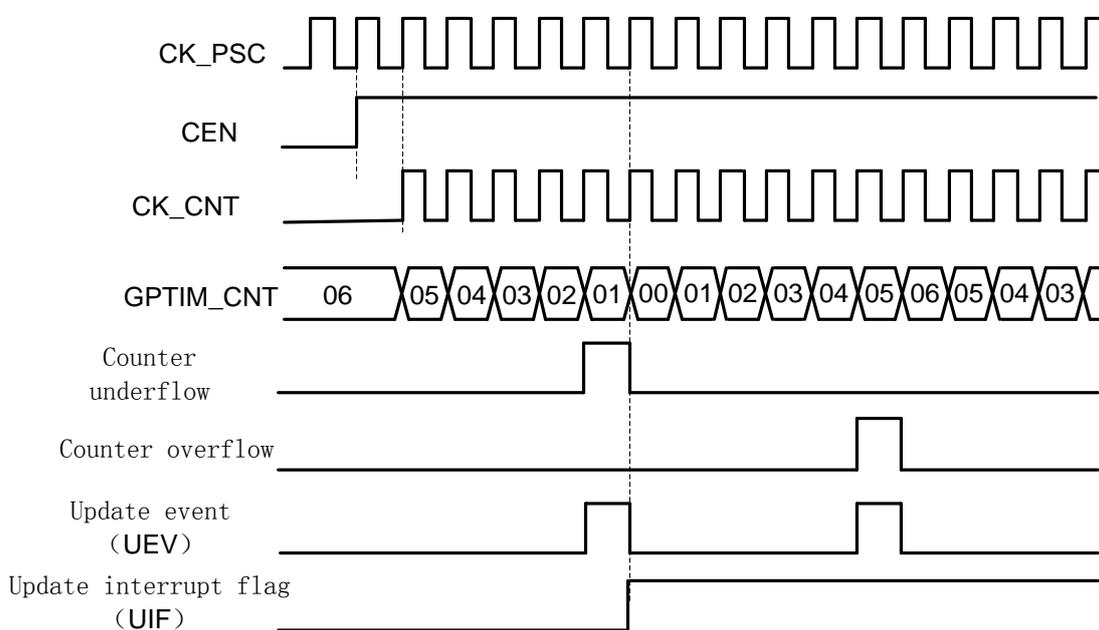
图 30-12 中心对齐计数器时序图，GPTIM\_PCS=0，GPTIM\_ARR=0x6
