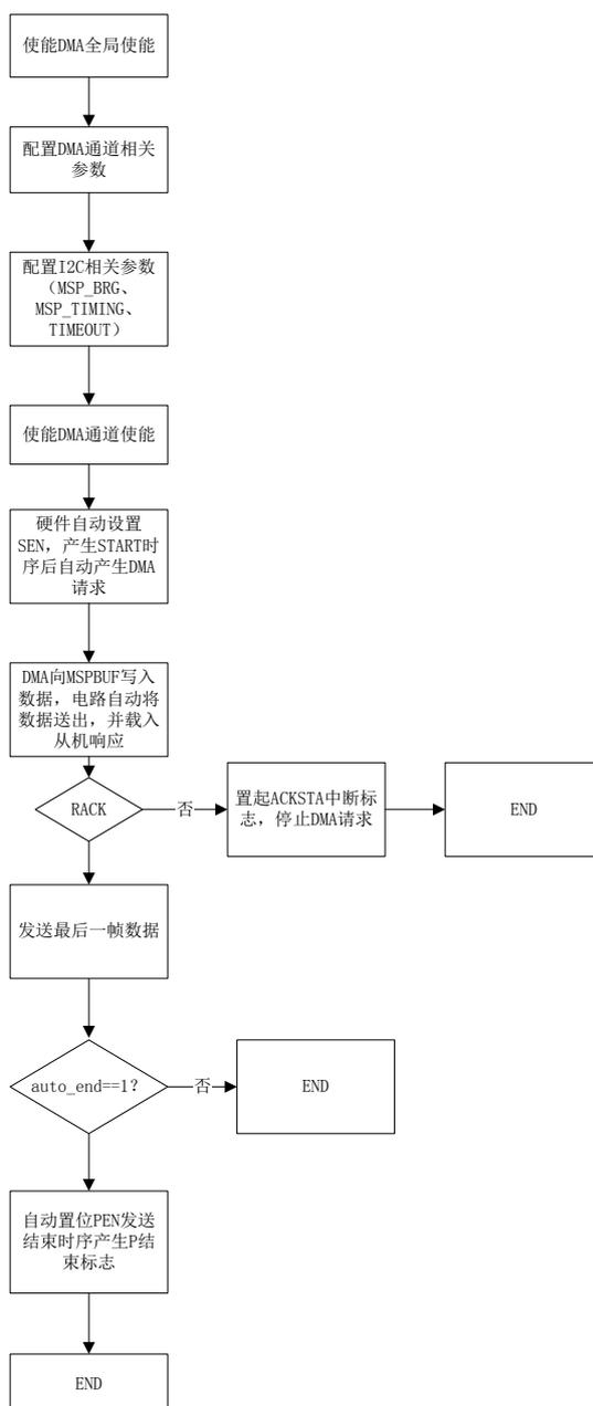
图 21-19 I2C 主机 DMA 发送流程图
