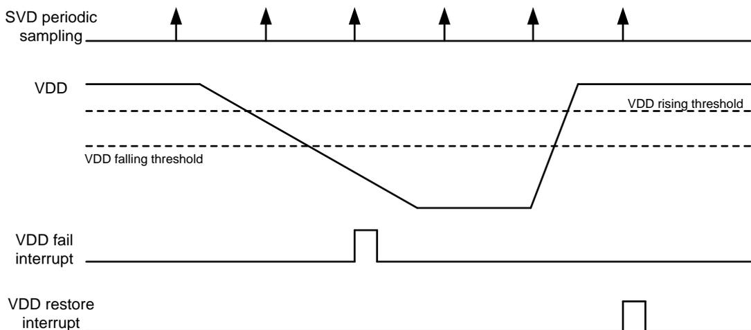
图 15-3 电源检测电路间歇工作模式
