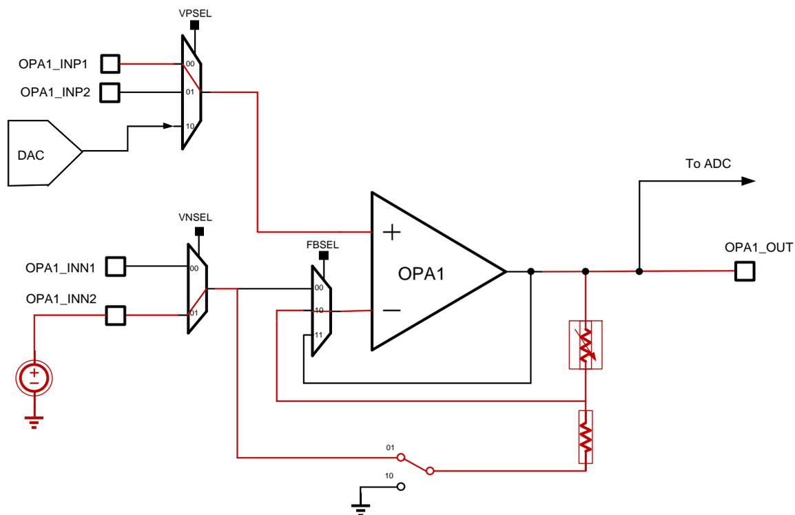
图 18-9 反相 PGA 带外部偏置
