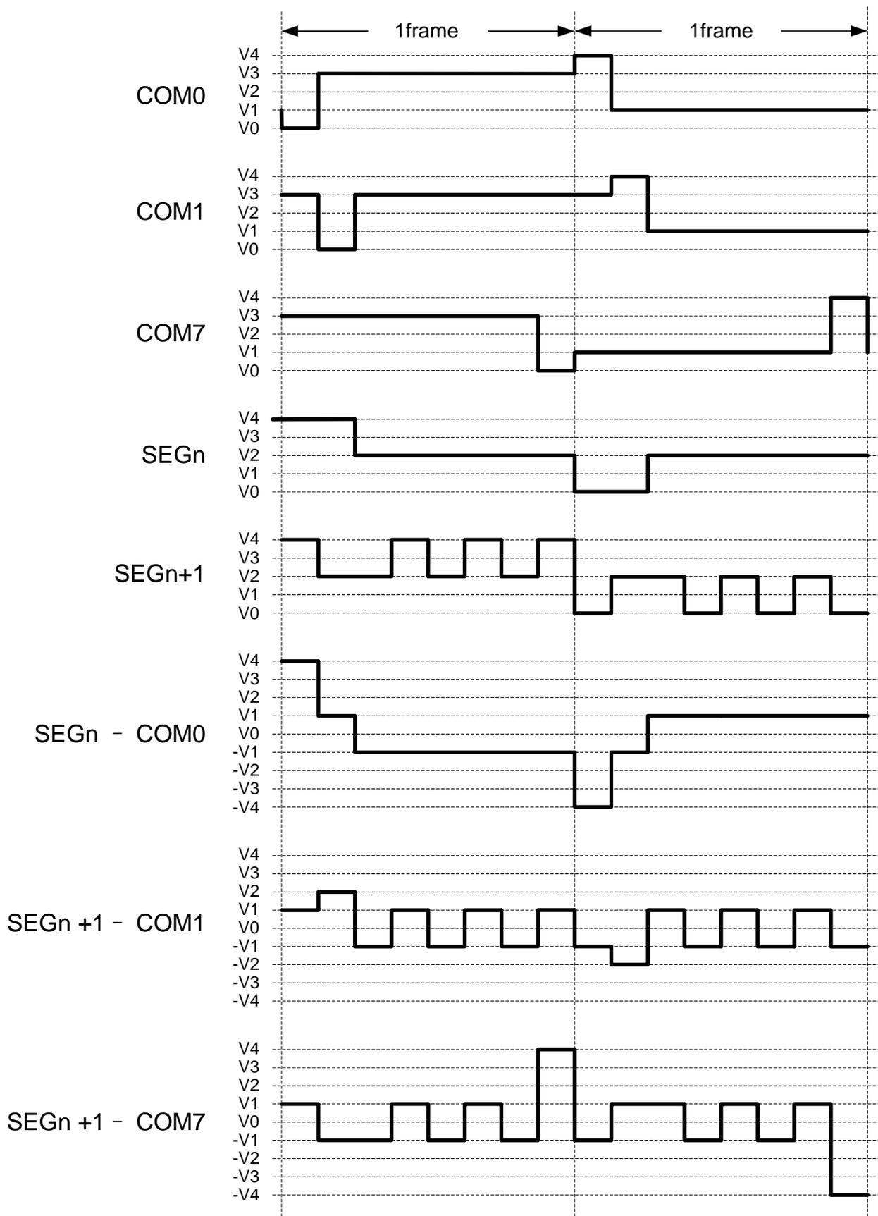
图 37-9 LCD 驱动波形(1/8 duty, 1/4 bias, type B)
