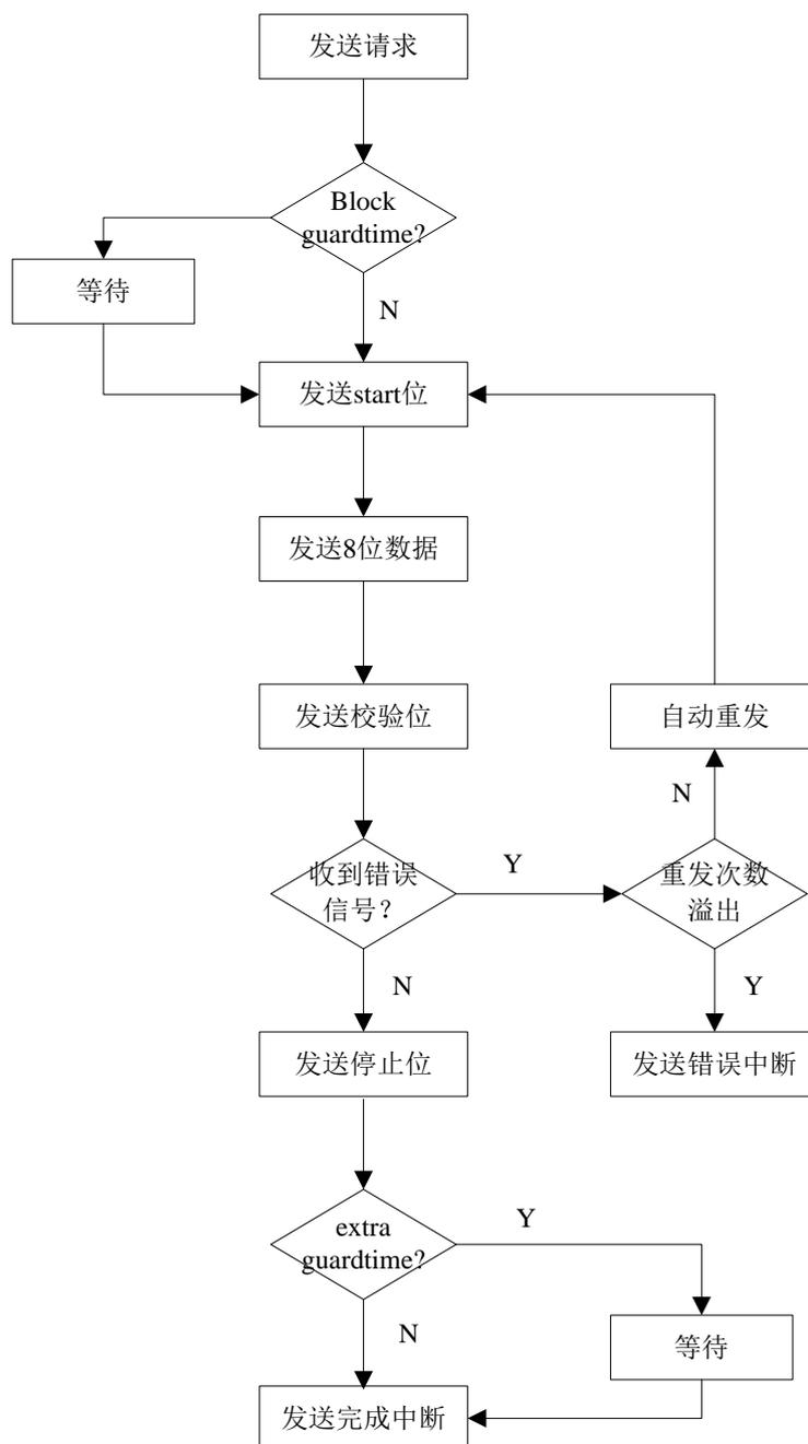
图 25-4 7816 发送流程图
