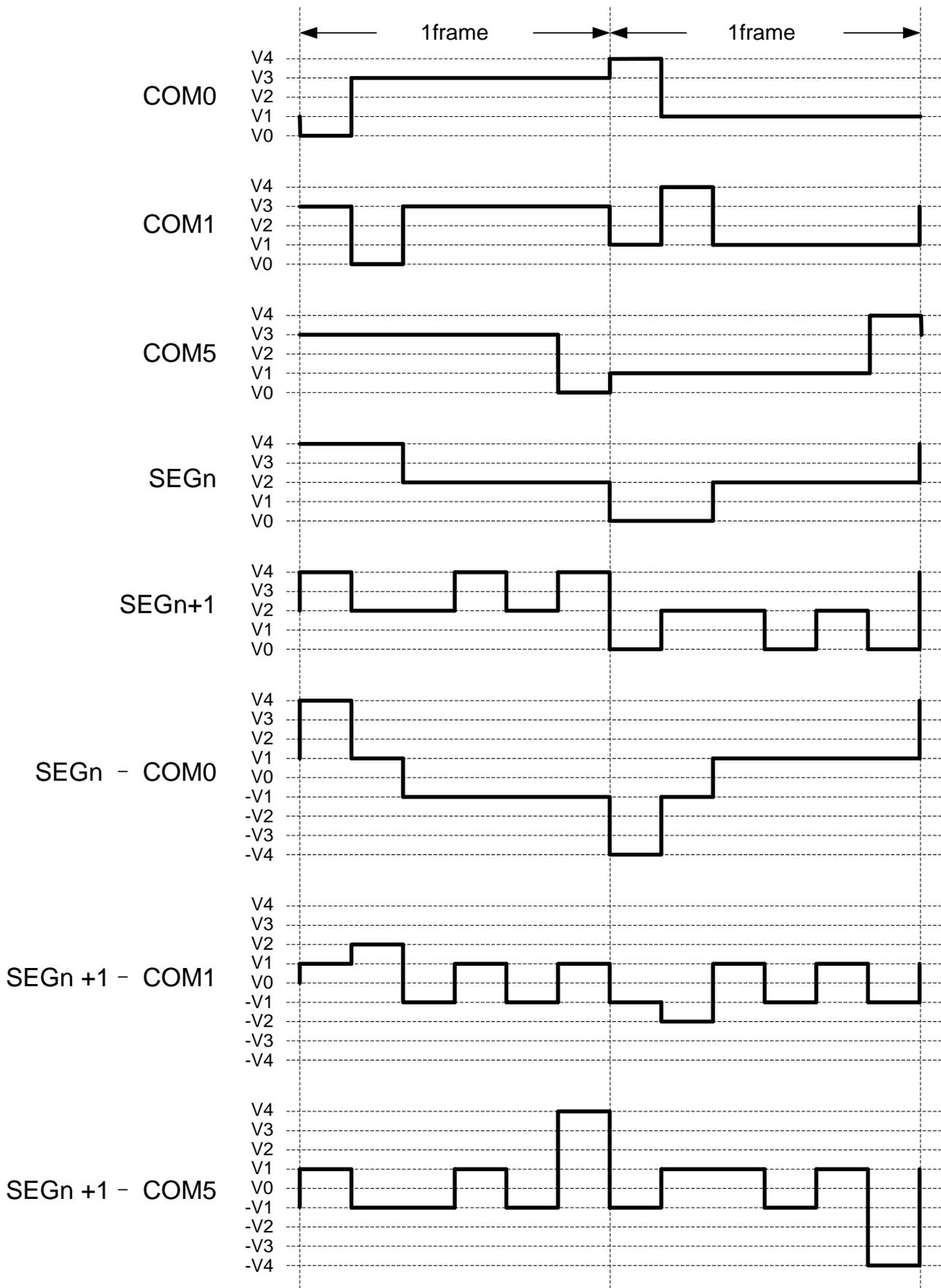
图 37-7 LCD 驱动波形(1/6 duty, 1/4 bias, type B)
