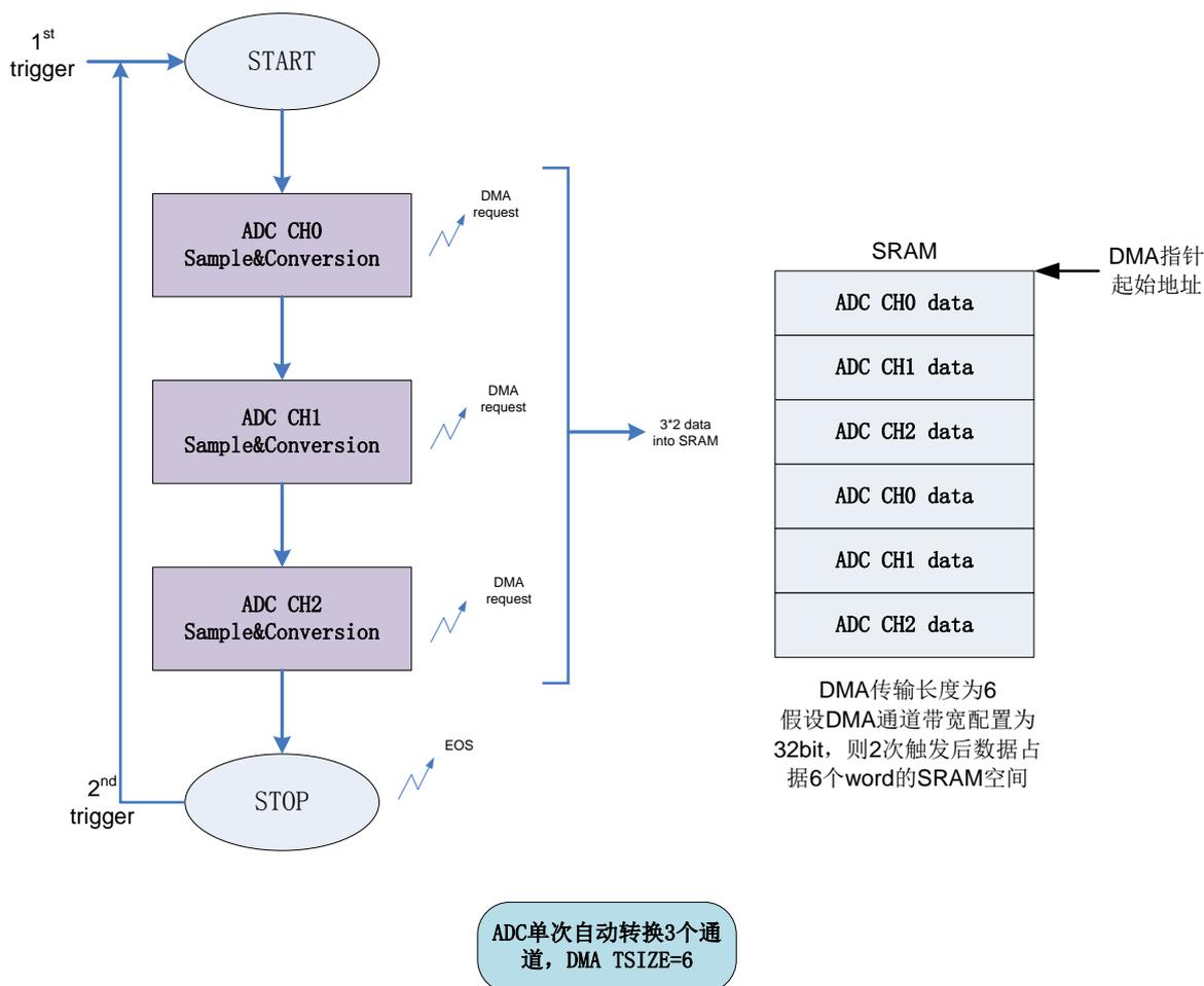
图 38-16 ADC 单次全自动触发+DMA 案例 1
