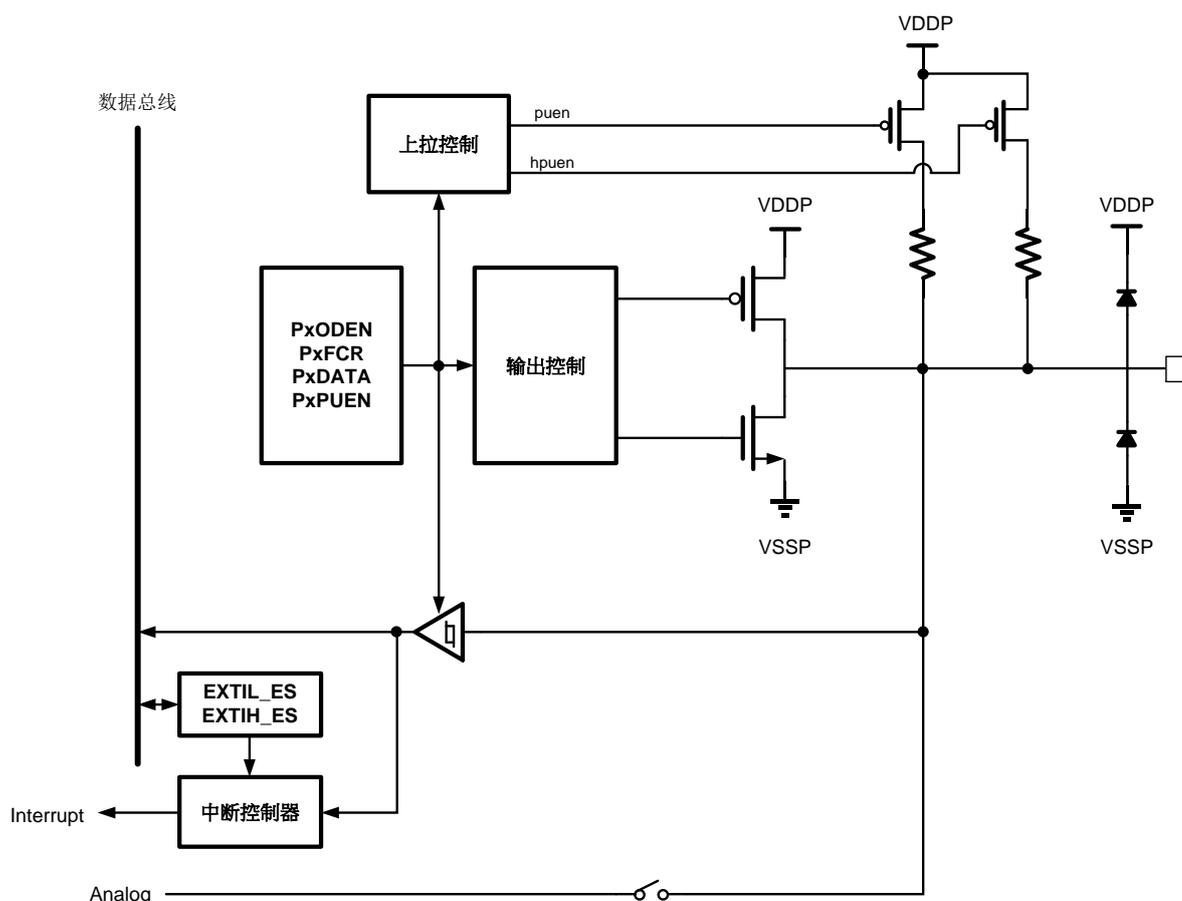
图 41-2 普通 GPIO (两路上拉) 结构框图
