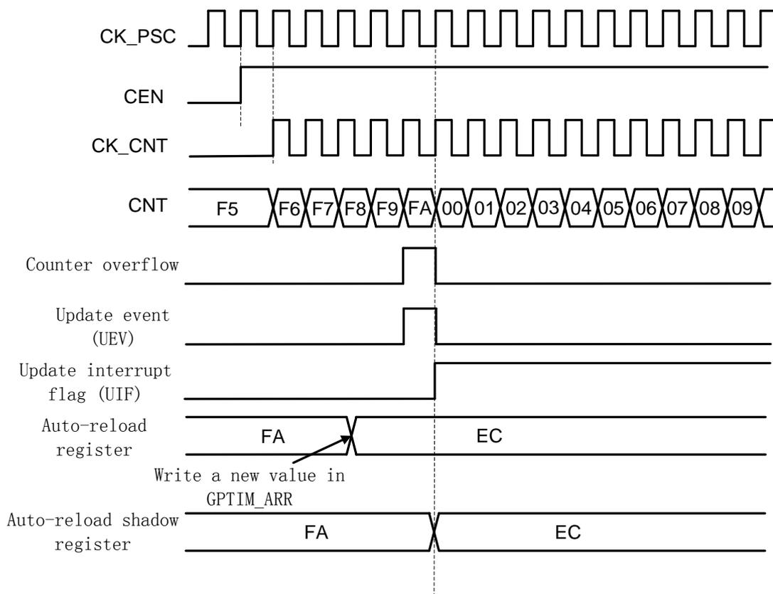
图 30-7 ARPE=1 (GPTIM\_ARR 预装载) 时的更新事件
