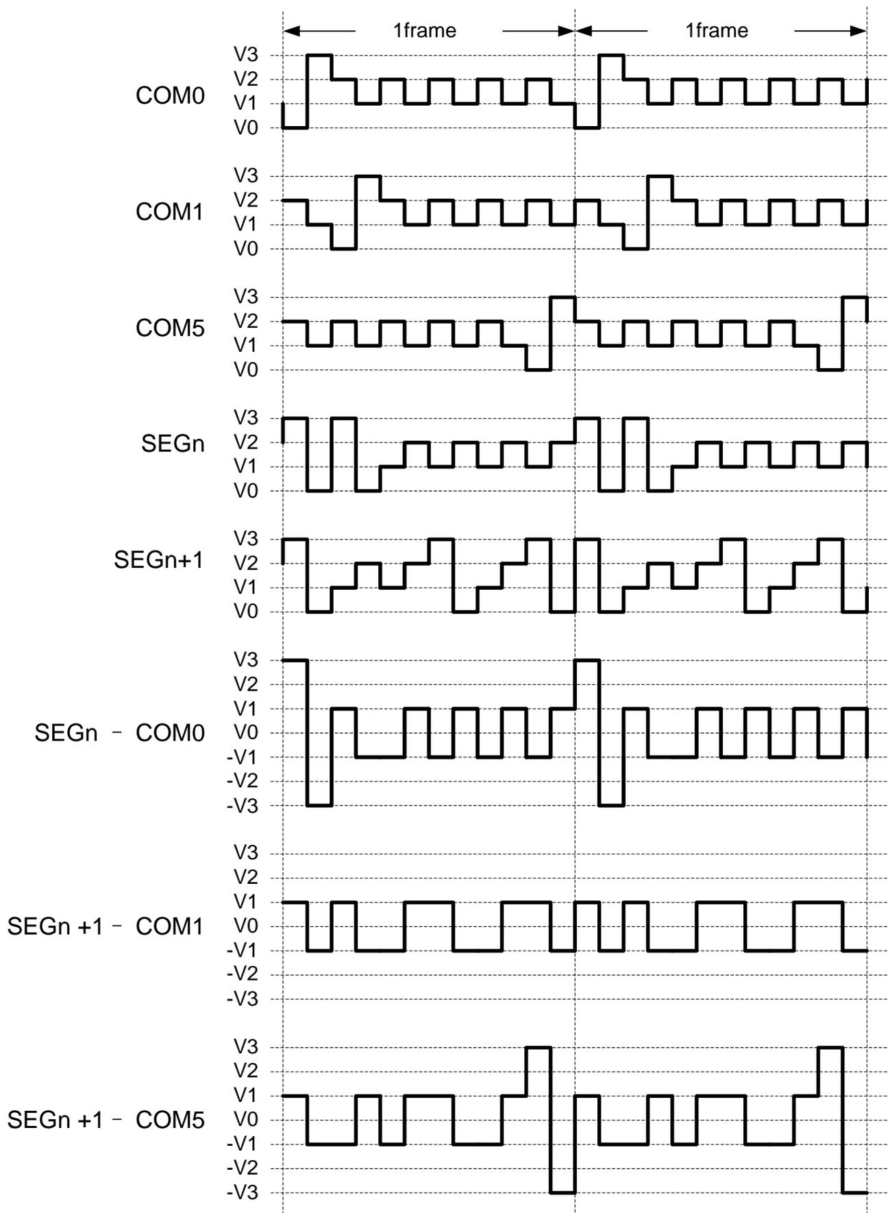
图 37-4LCD 驱动波形(1/6 duty, 1/3 bias, type A)
