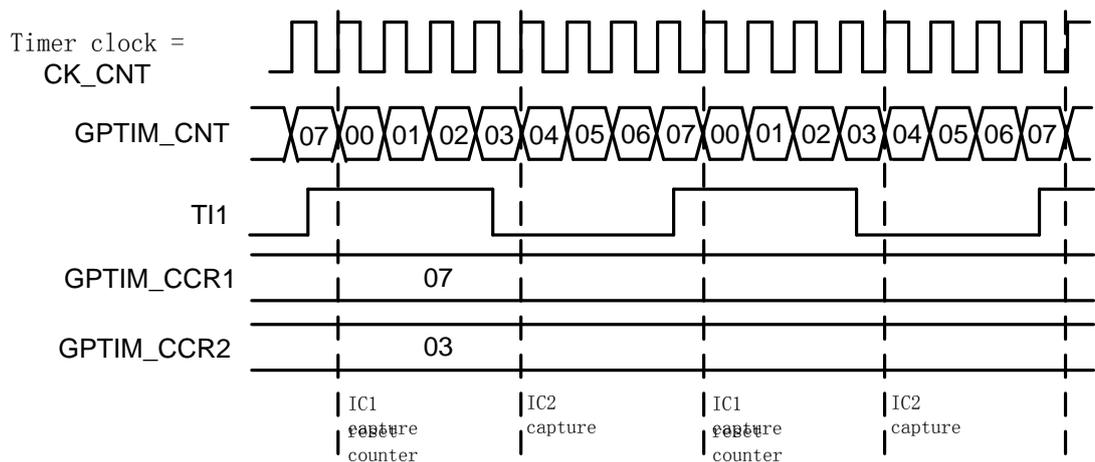
图30-26 PWM输入捕获模式时序
