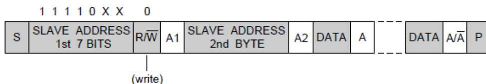
图 21-14 10bit 寻址, 主机向从机写入数据
