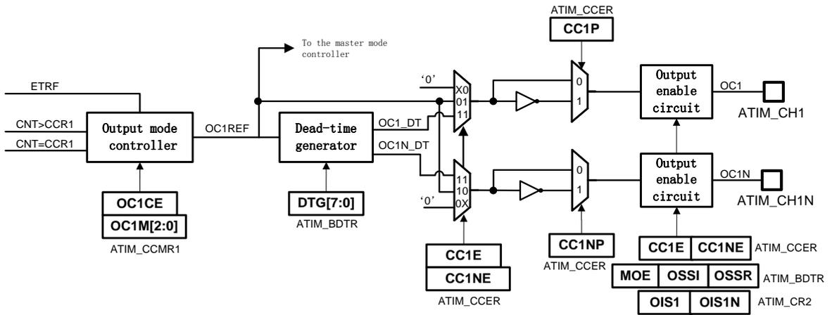
图29-26捕获/比较通道的输出部分(通道1至3)
