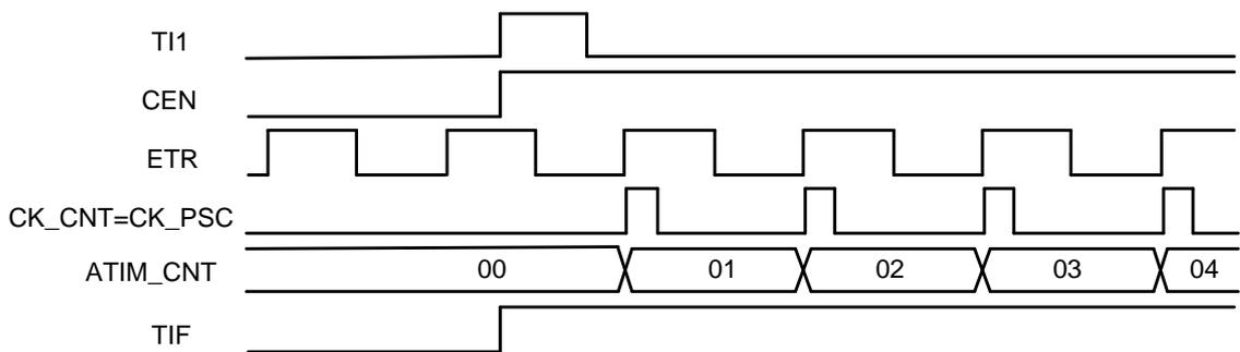
图30-36外部时钟模式2+触发模式下的时序
