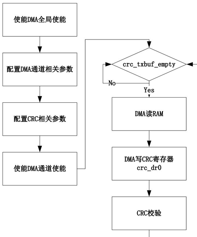
图28-2使用DMA对RAM中的数据进行CRC运算
