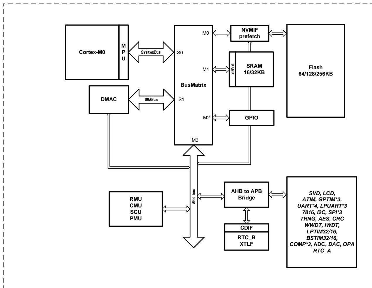
图 4-1 系统总线示意图
