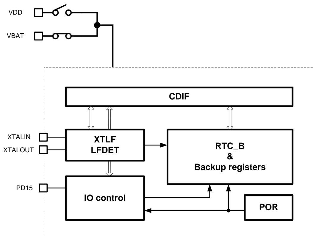
图 8-1 备份电源域结构框图
