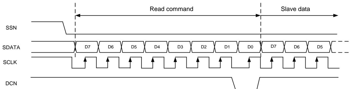
图 24-5 4 线半双工读操作 (无 dummy cycle)
