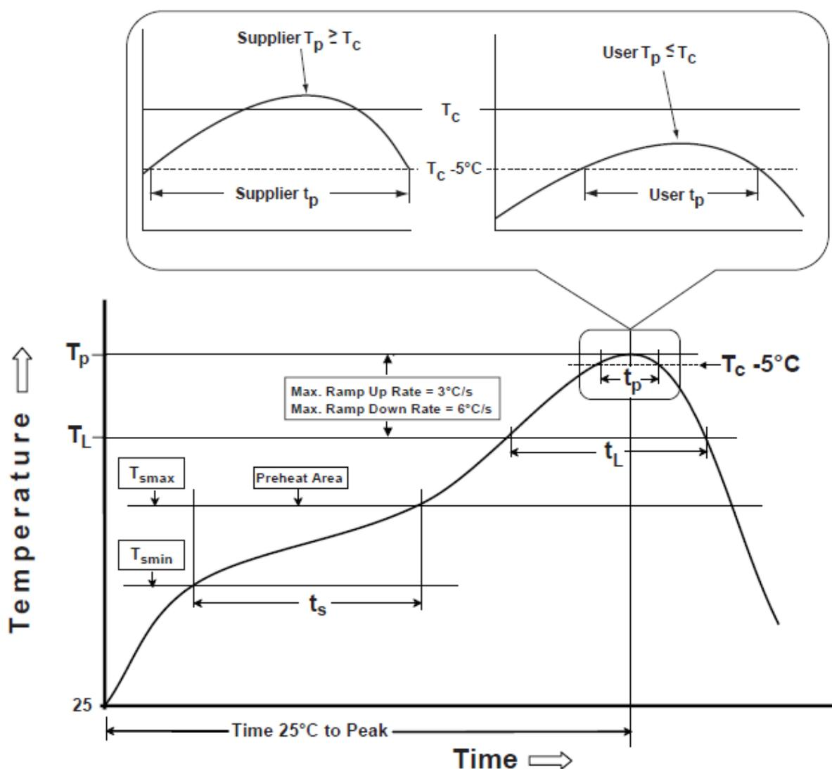
图 2-9 JEDEC 标准的耐热回流温度曲线
