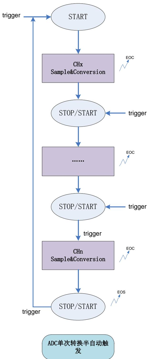
图 38-11 ADC 单次转换半自动触发模式
