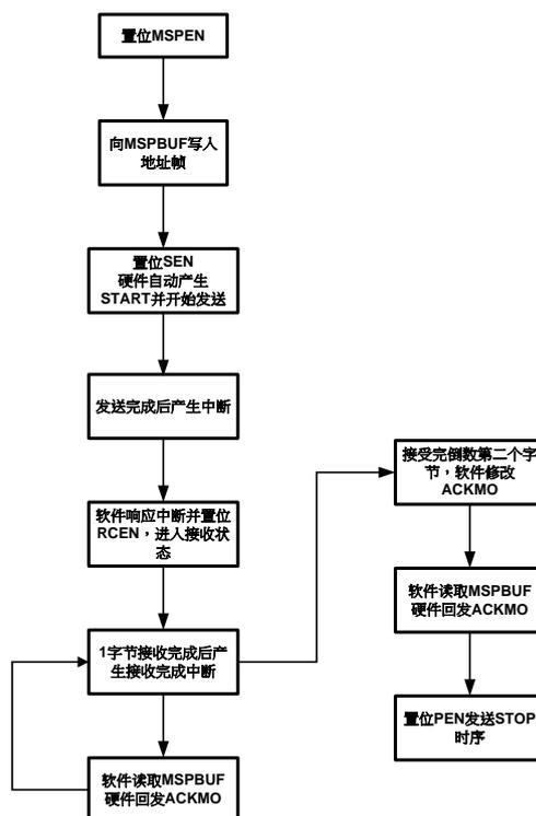
图 21-11 I2C 软件接收数据流程图
