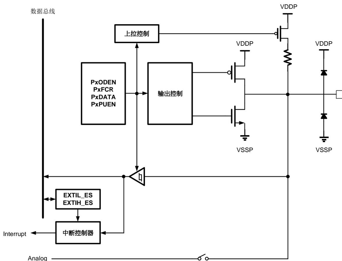
图 41-1 普通 GPIO 结构框图
