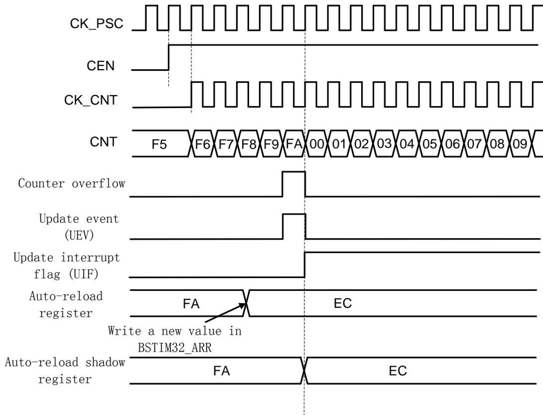
图 31-7 ARPE=1 (ARR 预装载) 时的更新事件
