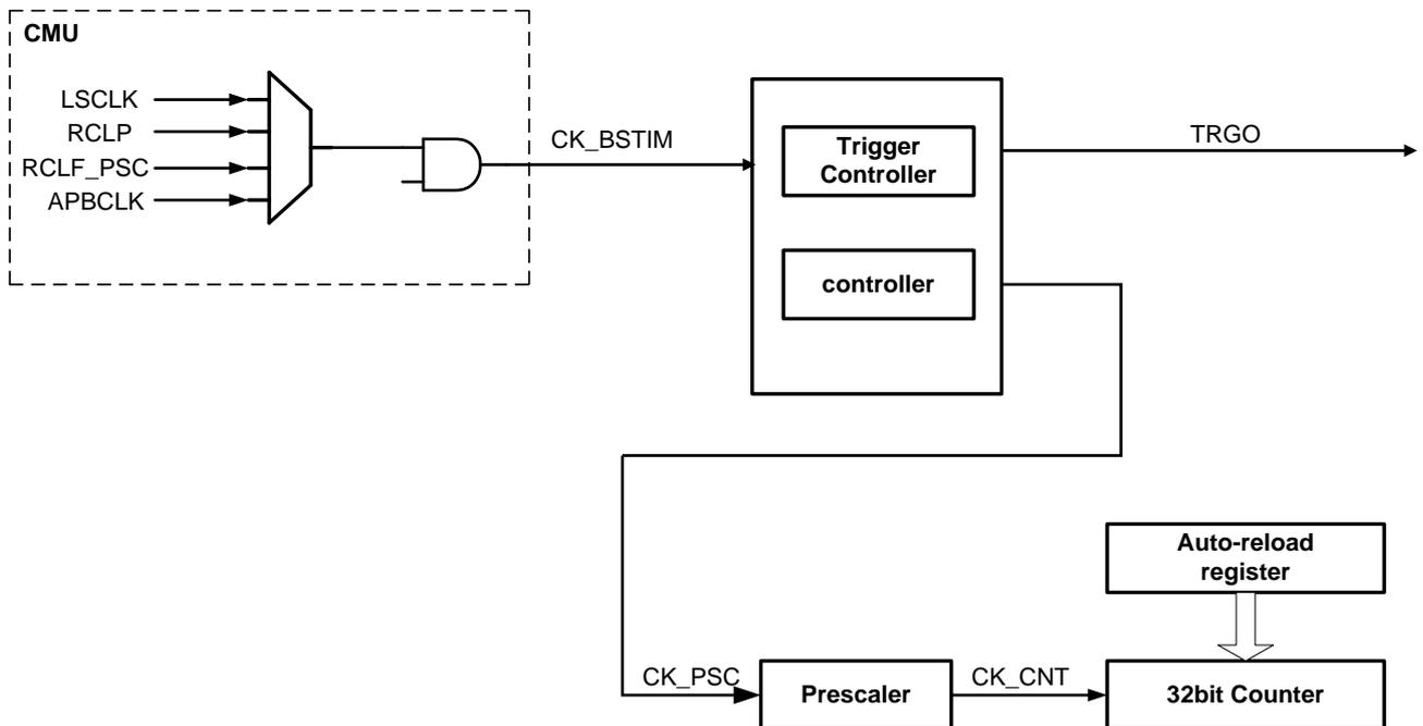
图 31-1 32 位基本定时器结构框图
