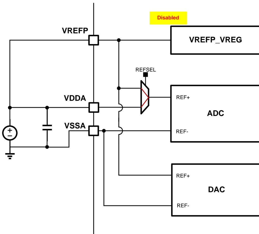
图 7-2 外部电源基准方案 1
