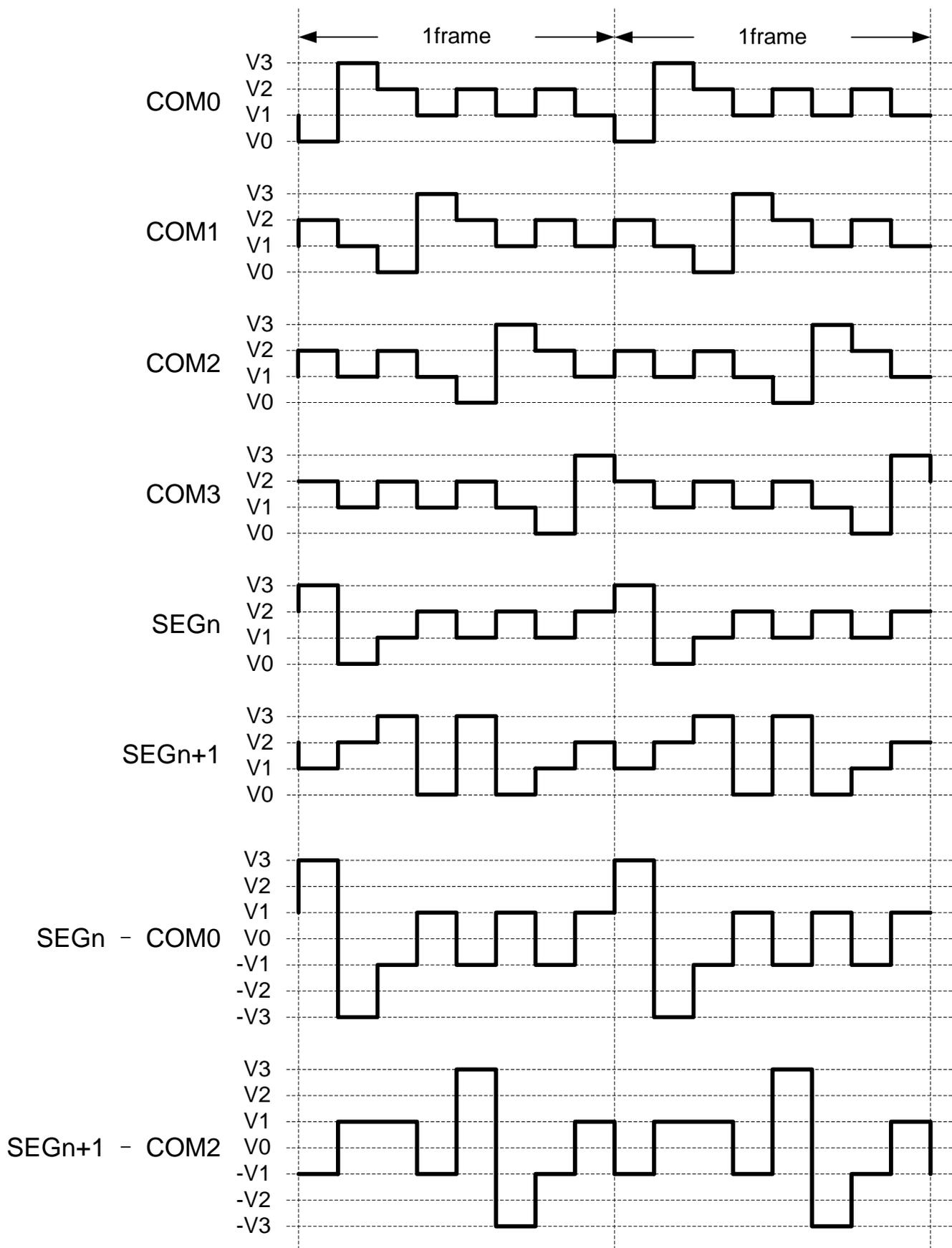
图 37-2LCD 驱动波形(1/4 duty, 1/3 bias, type A)
