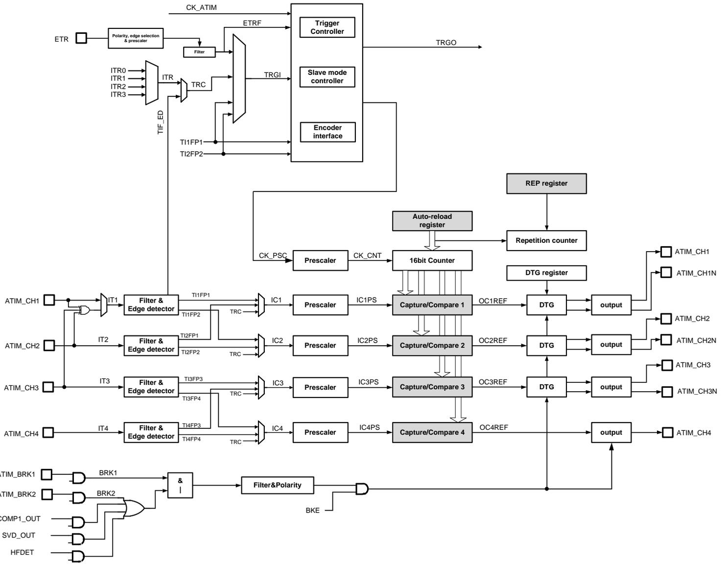
图 29-1 高级定时器结构框图
