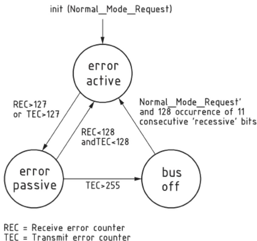
图 26-3 节点错误状态转移
