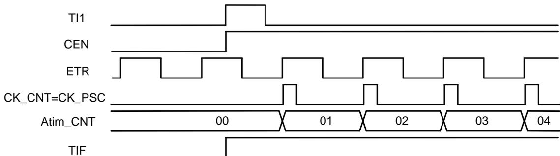
图29-43外部时钟模式2+触发模式下的时序
