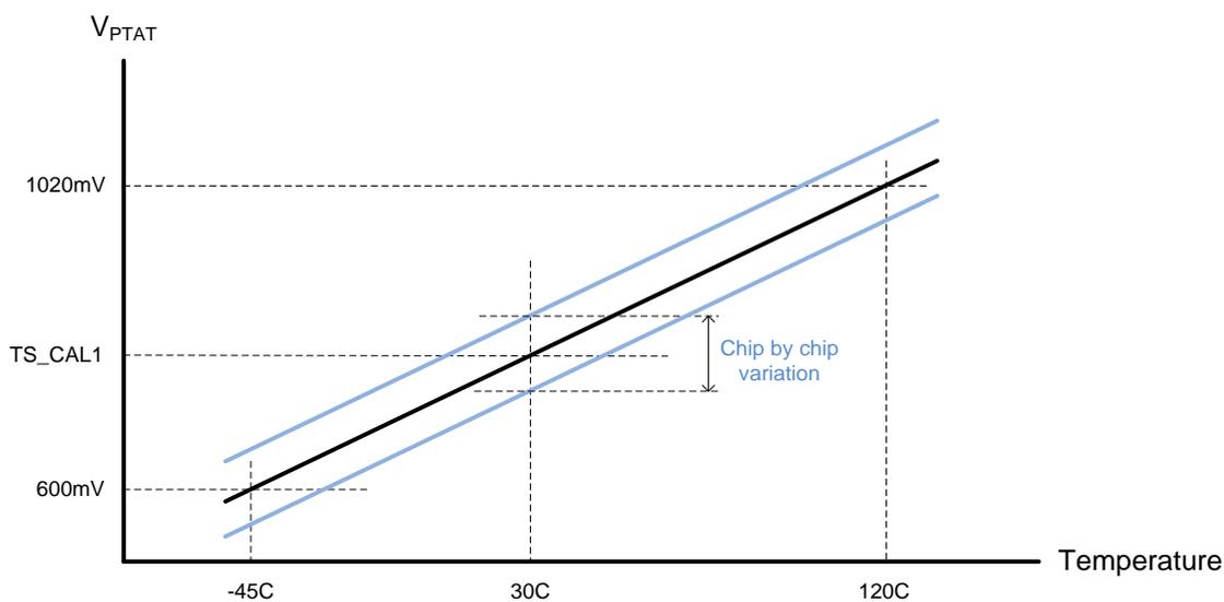
图 3-12 温度传感器输出曲线
