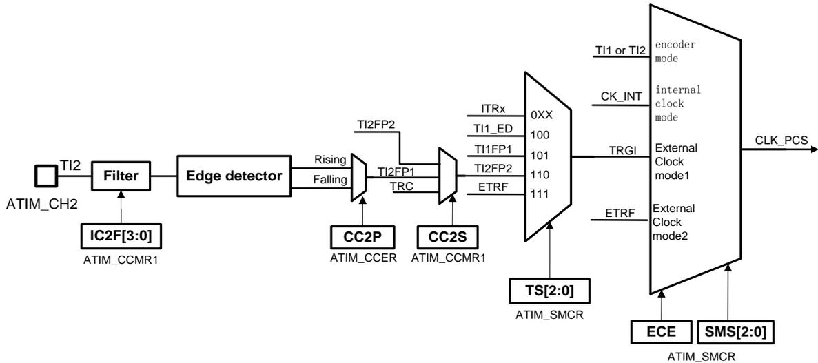
图 29-18 TI2 外部时钟连接例子
