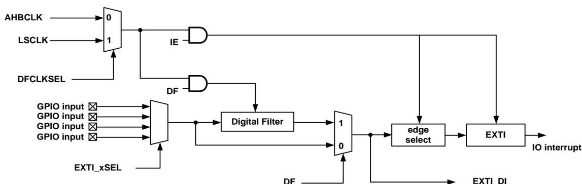
图 41-5 EXTI 信号输入示意图
