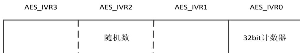
图 16-8 32 位计数器和随机数的存储方式
