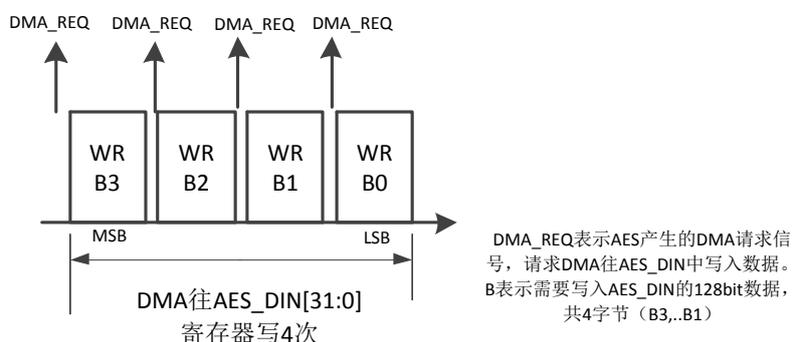
图 16-18 输入时 DMA 请求和数据传输示意图
