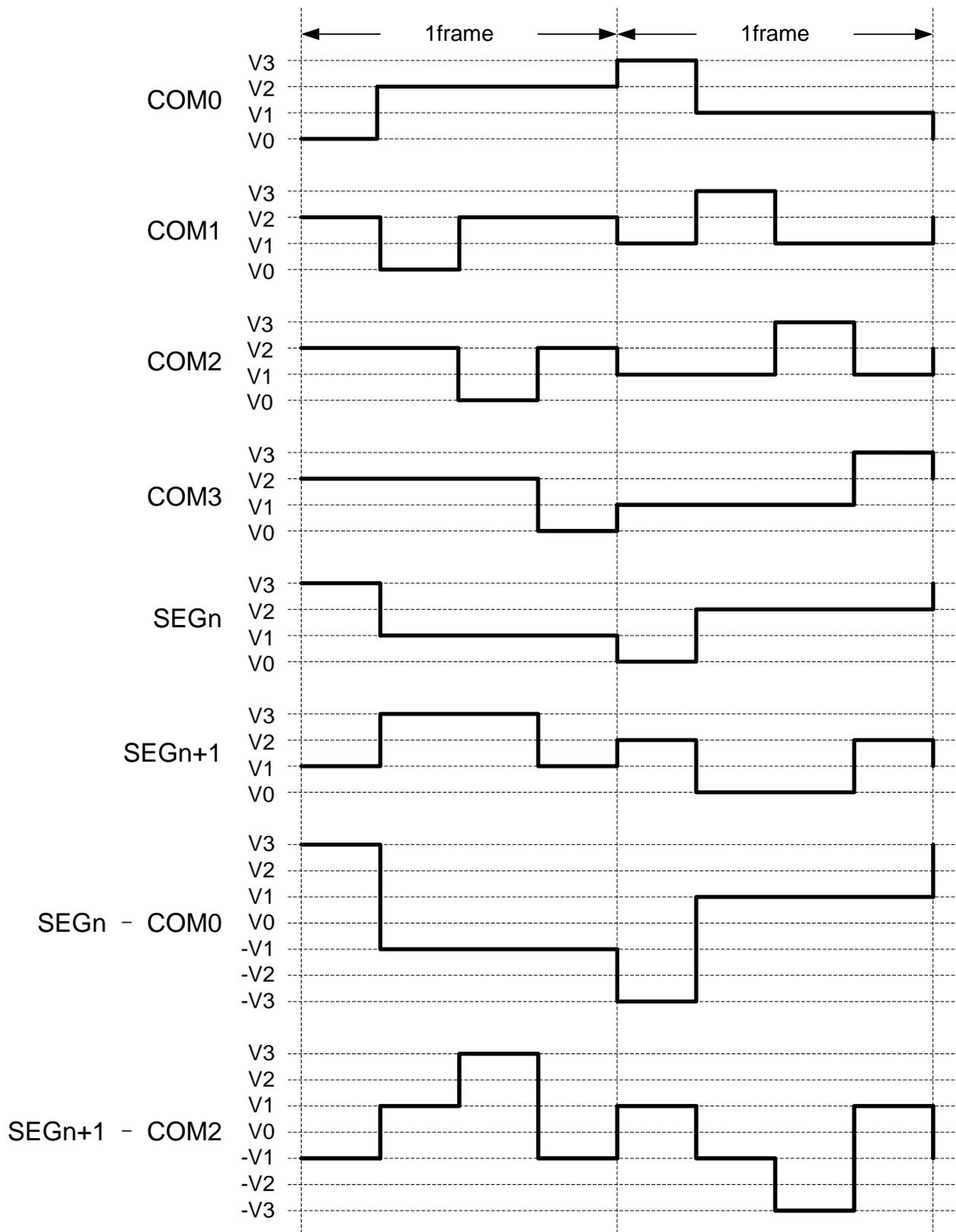
图 37-6 LCD 驱动波形(1/4 duty, 1/3 bias, type B)
