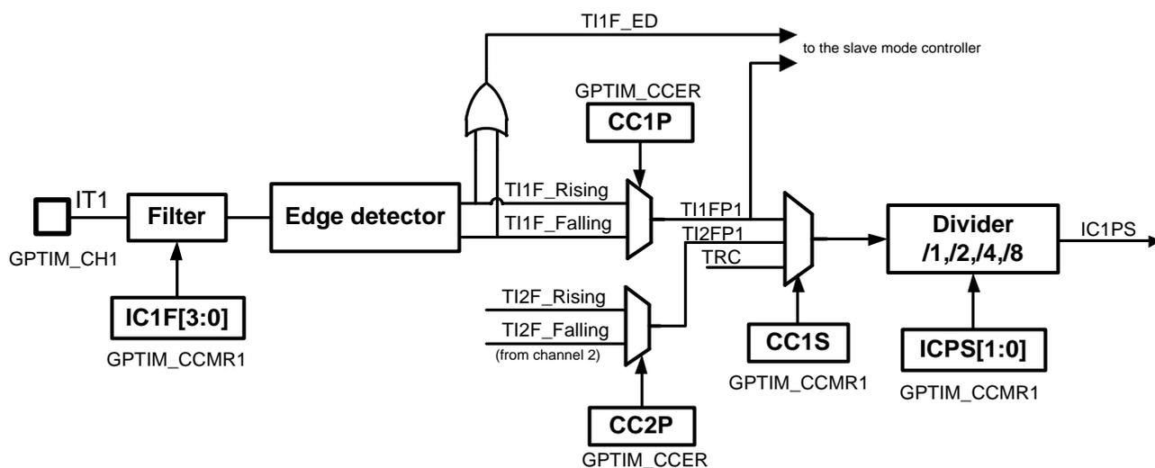
图30-23捕获/比较通道(通道1输入部分)
