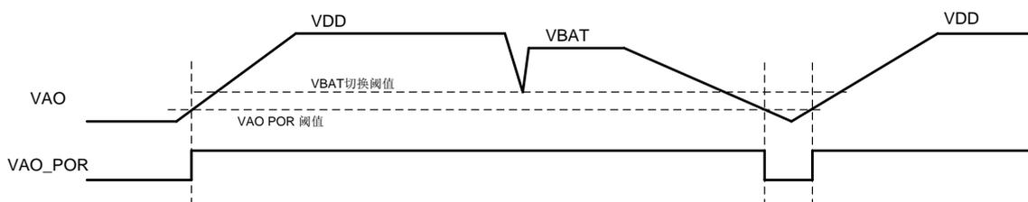
图 8-2 VAO 上下 RTCB 电复位示意图
