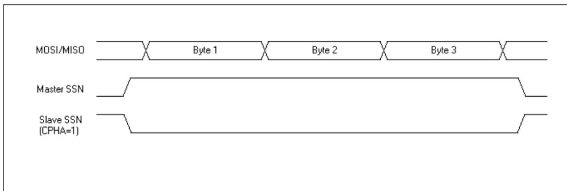
图 24-9 SPI SSN 时序图 (SSNM=0)
