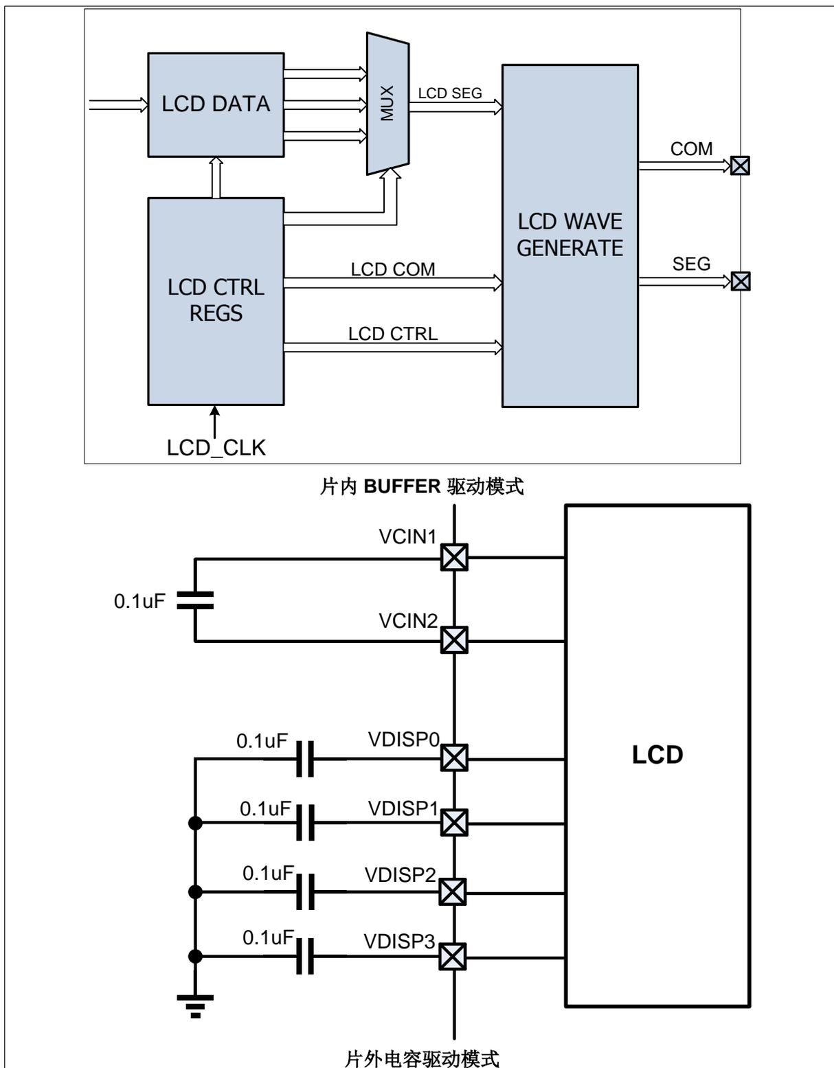
图 37-1 LCD 显示控制模块结构框图
