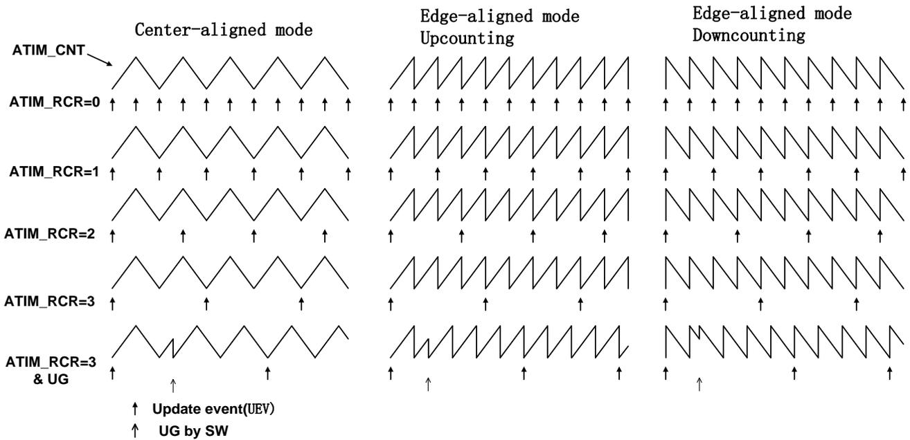
图 29-15 不同模式下更新速率的例子，及 ATIM\_RCR 的寄存器设置
