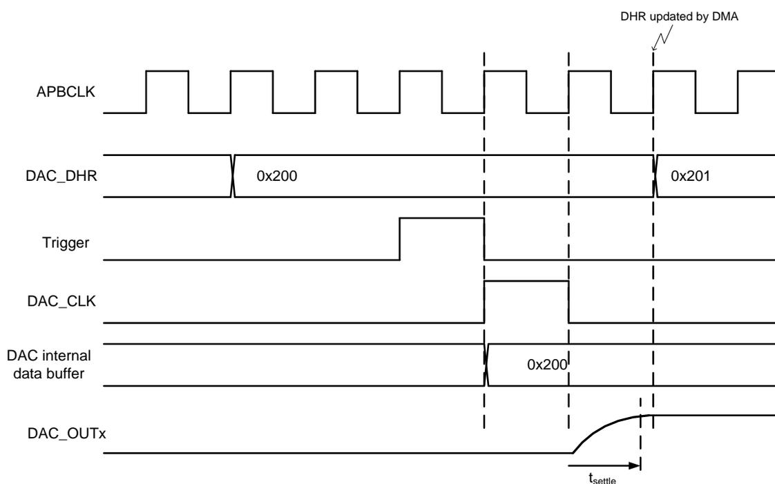
图 39-6 触发模式下通过 DMA 更新数据
