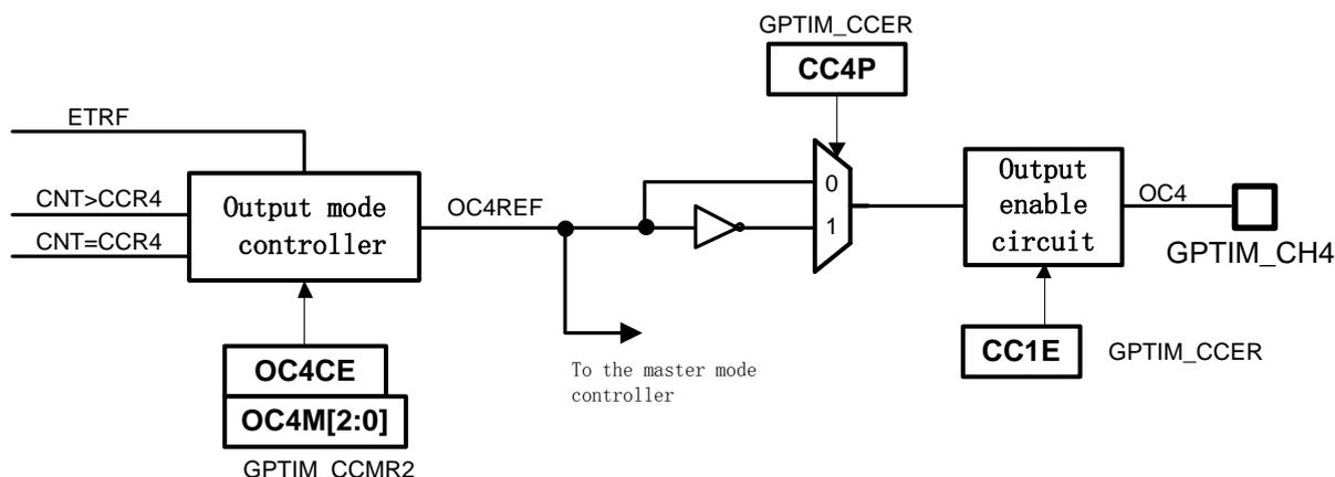
图30-25捕获/比较通道的输出部分
