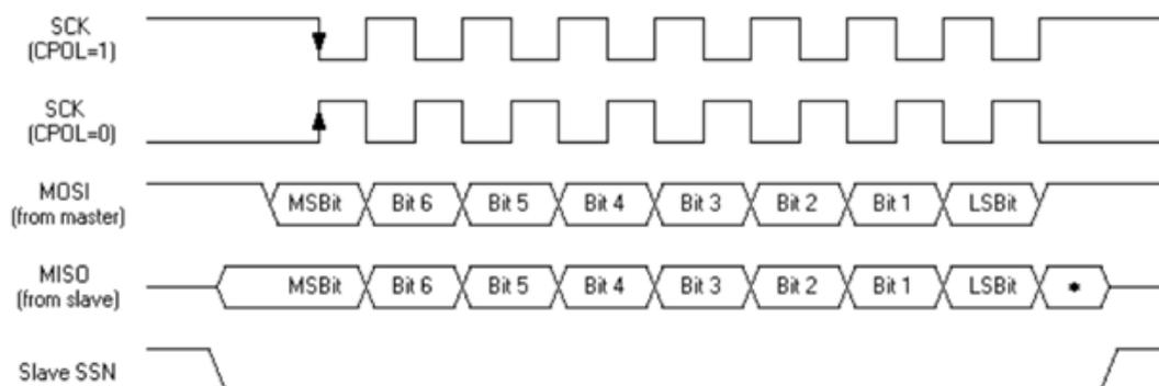
图 24-2 SPI 数据/时钟时序图 (CPHA=0)
