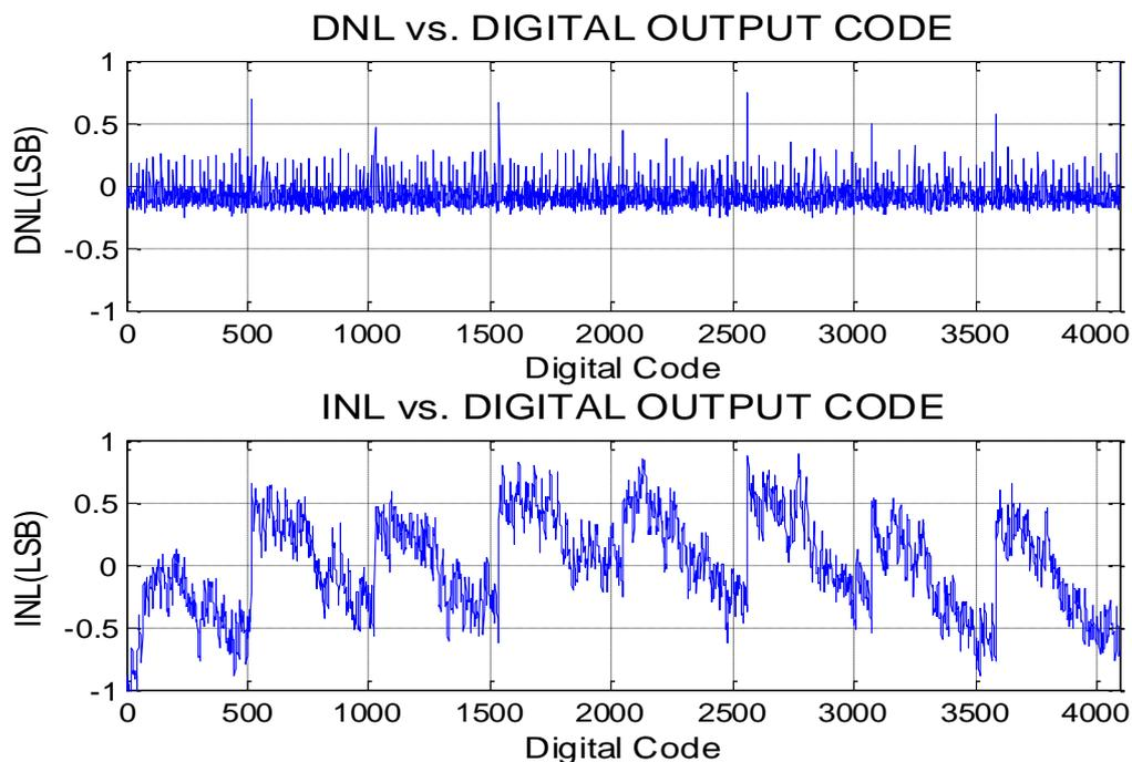
图 3-4 ADC 单端输入典型 DNL 和 INL
