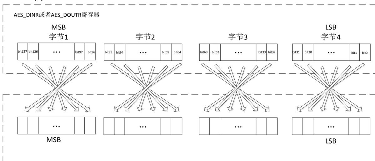
图 16-12 根据数据类型存储数据的示意图
