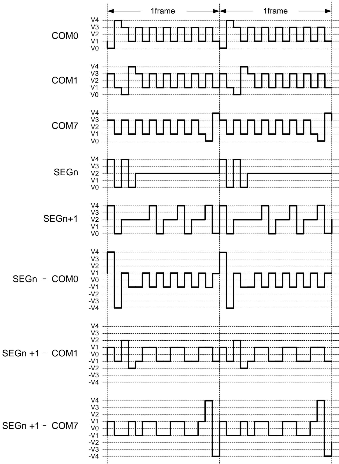
图 37-5LCD 驱动波形(1/8 duty, 1/4 bias, type A)
