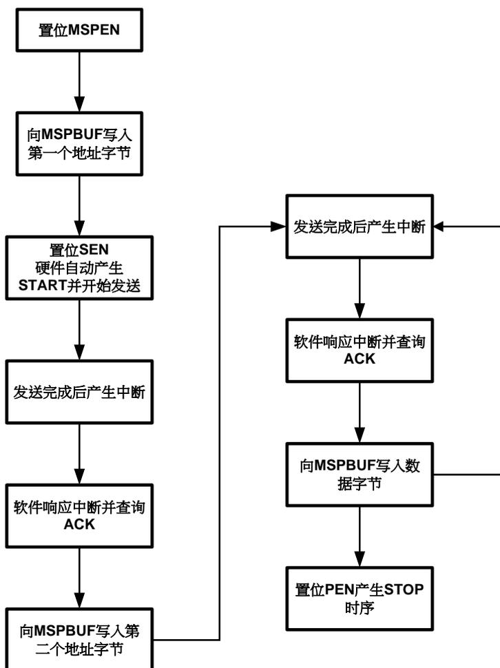
图 21-15 I<sup>2</sup>C 软件发送数据流程图
