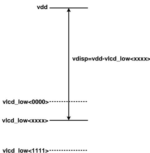
应用中应根据实际 LCD 面板特性，选择合适的 VDISP 电压，可参考 37.6.1 中的表格进行配置。
