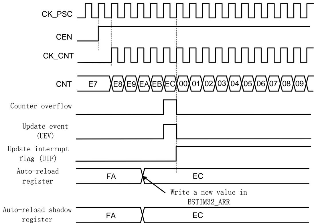
图 31-6 ARPE=0 (ARR 没有预装载) 时的更新事件
