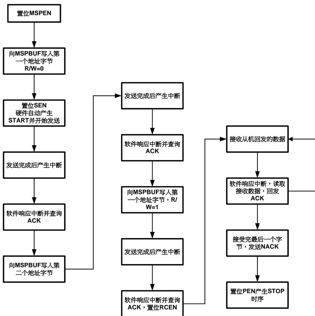
图 21-17I2C 软件发送数据流程图
