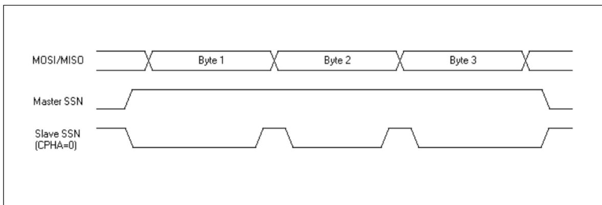
图 24-8 SPI SSN 时序图 (SSNM=1, CPHA=0)
