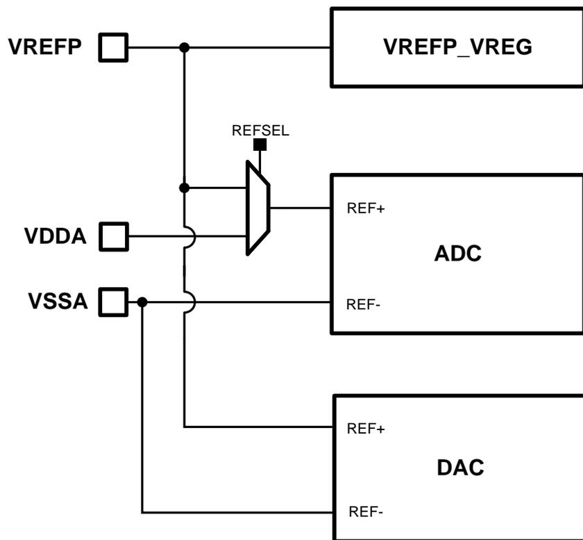
图 7-1 ADC 和 DAC 基准源
