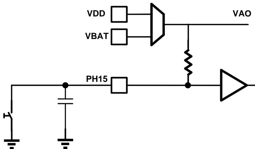
不建议将 PH15 通过外部上拉连接到 VBAT，否则由于 VBAT 与 VDD 不相等，导致漏电。因此此方案中只能通过 PH15 内部上拉电阻实现上拉。
