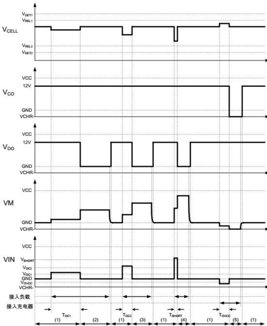
假定为恒流充电， $V_{CHR-}$ 为充电器空载时负端电压：
