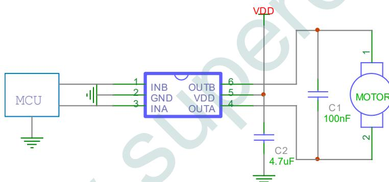
注：图中 C1 (100nF) 电容优先接于马达上，马达上不方便接时置于 PCB 上。C2 在应用中 3V 供电的建议用 1uF 或以上；在 4.2V-4.6V 应用中建议用 4.7uF 或以上；在 6V 应用中建议用 10uF 或以上均为使用贴片电容靠近 IC 之 VDD 管脚放置且电容的负极和 IC 的 GND 端之间的连线也需尽量短。即不要电容虽然近，但布线、走线却绕得很远。请参考如下 PCB 布线图。
