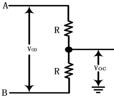
图 1 驱动器直流特性测试负载
