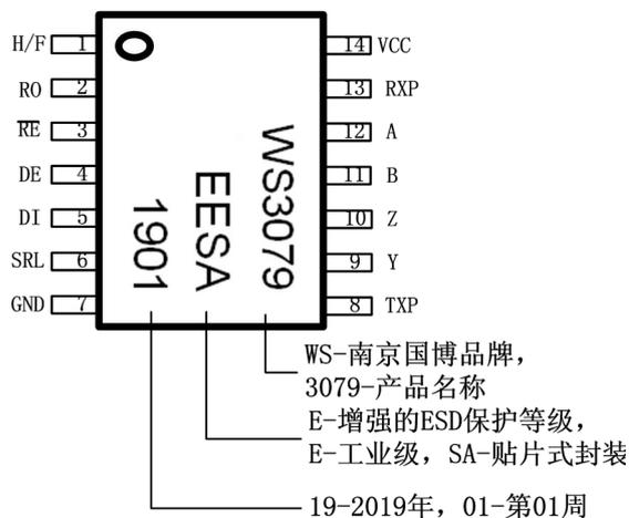
WS3079 引脚图—14-pin SOP
