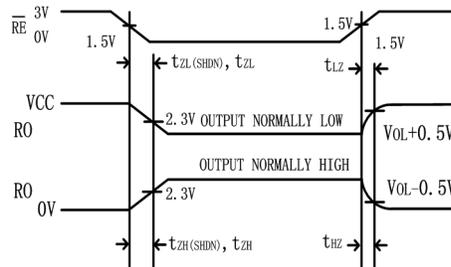
图 8 接收器使能/关断时序
