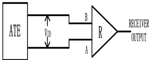
图 9 接收器传输延时测试电路
