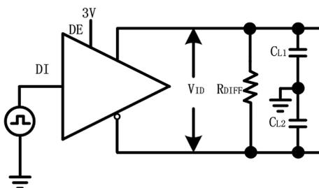
图 3 驱动器开关特性测试电路
