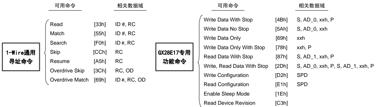
图 1 GX28E17 的命令层级架构
