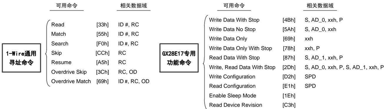
图 1 GX28E17 的命令层级架构
